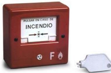
Se instalara un sistema de alarma que serán de alta resistencia al impacto, operación de doble acción para evitar accionamiento accidental y deberá tener una placa con leyenda de alarma contra incendios estos pulsadores estarán colocados por niveles de piso junto a los gabinetes, que activarán una sirena automáticamente.
