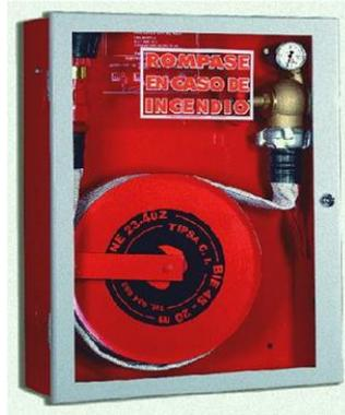
La Boca de Incendio Equipada, más conocida por sus siglas (BIE), es un equipo completo de protección y lucha contra incendios, que se instala de forma fija sobre la pared y está conectado a la red de abastecimiento de agua. Incluye, dentro de un armario, todos los elementos necesarios para su uso: manguera, devanadera, válvula y lanza boquilla.
