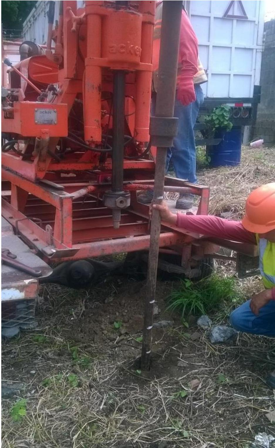
*Imagen 06; Marcas de profundidad del ensayo S.P.T.*
