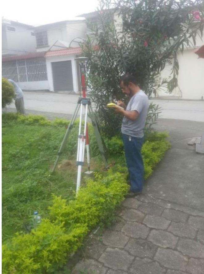
*Imagen 01; Generación de coordenadas con equipo receptor GNSS RTK.*
