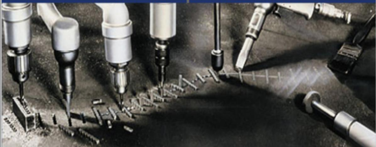
El cual consiste en un proceso de reparación en el que no incide ningún tipo de temperatura, lo que evita los usuales problemas de esfuerzos asociados con la soldadura y mantiene la alineación original, lo cual limita la necesidad de mecanizado después de la reparación.
