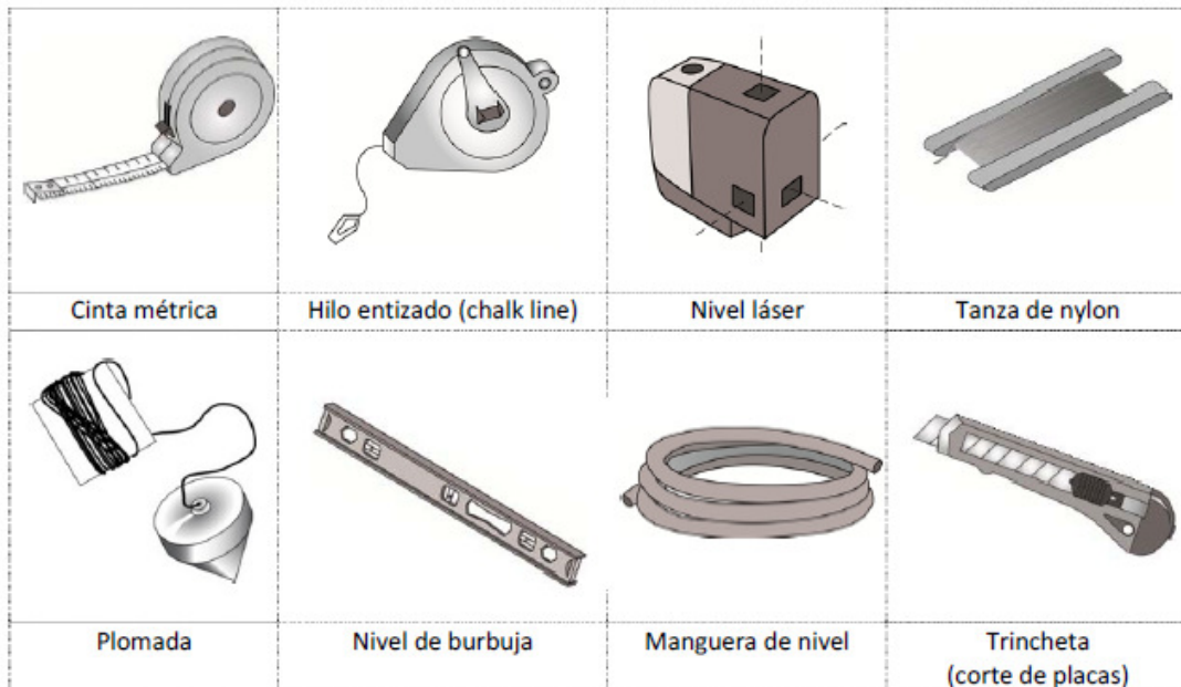
Ilustración No. 33 Herramientas para la correcta instalación del sistema drywall.
