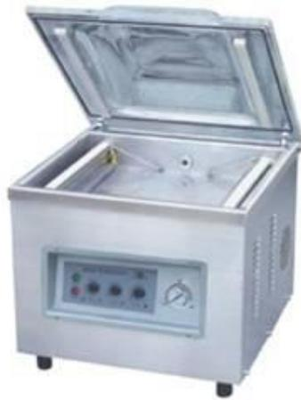
Esta máquina empaqueta el producto en una bolsa, extraer el aire a través de una bomba y sellarla con una barra. Este proceso se utiliza para conservar mejor los alimentos, evitar transferencias de olores en almacenamiento y hasta para hacer cocciones al vacío.
