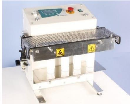
Esta máquina que se utiliza para sellar bolsas de plástico mediante la presión y el calor.
