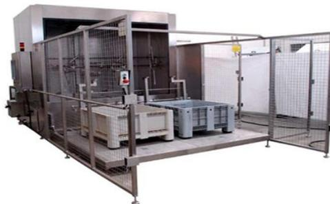
Se utilizan para el lavado de diferentes contenedores de pescado: con rejillas, aislado, plegables, encajables, etc. La utilización va a depender de los requisitos específicos se pueden personalizar para no solamente lavar contenedores, sino también palets, etc.
