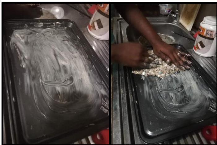
Ilustración 53: Colocación de materiales en molde.
