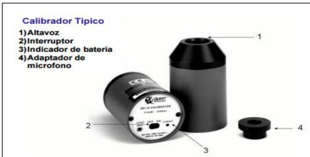
Figura 11. Típico calibrador sonoro
