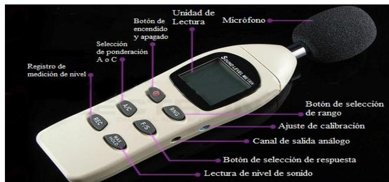
Figura 9. Partes del sonómetro
