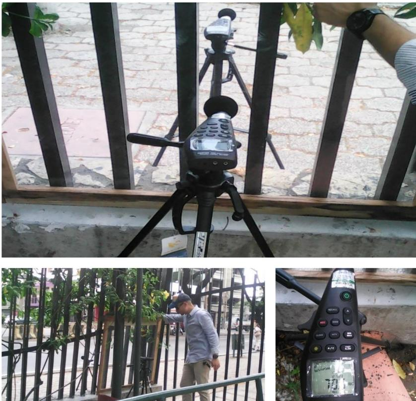
*Figura 59.* Pruebas del ruido con barreras de policarbonato efectuadas al interior del parque en la mañana
