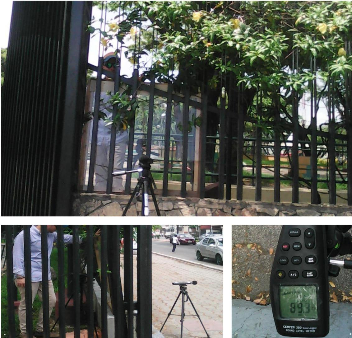
*Figura 58.* Pruebas del ruido con barreras de policarbonato efectuadas al exterior del parque en la mañana
