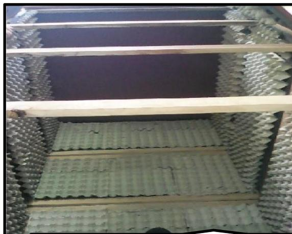
3. Barrera colocada en túnel de prueba
