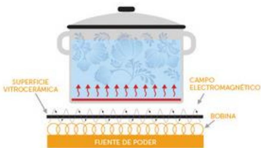
Figura 22. Superficie de campo electromagnético
