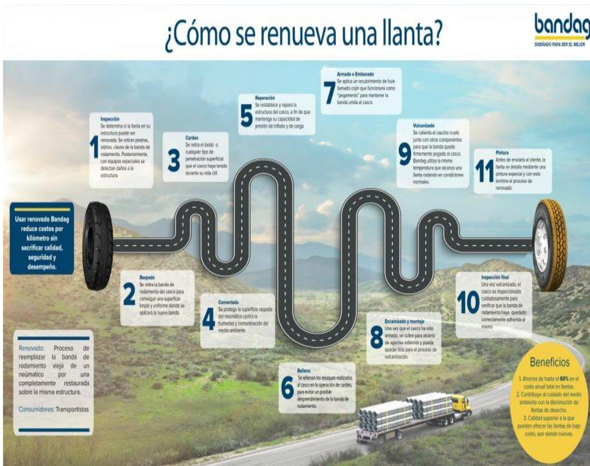
Figura 7 Pasos para el reencauche de una llanta
