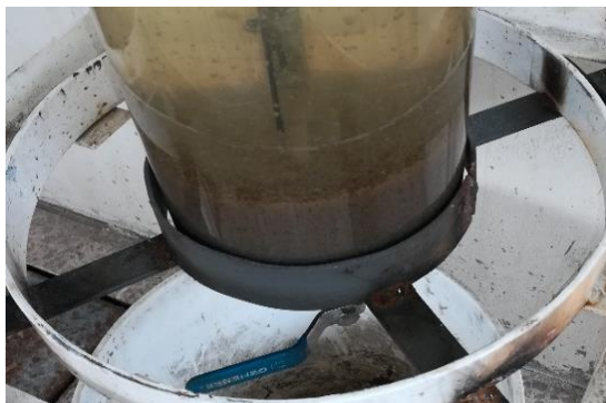
Ilustración 42: Aspecto del agua después del mezclado
