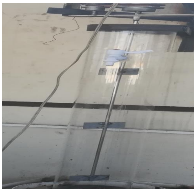
Ilustración 8: Varilla de hierro galvanizado y aletas.
