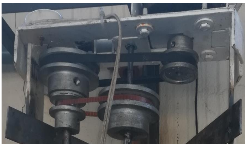
Ilustración 7: Sistema de poleas v bandas Elaborado por: Ramos Medina W. (2018).
