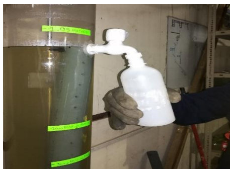
Ilustración 35: Etapa de vaciado (toma de muestra)
