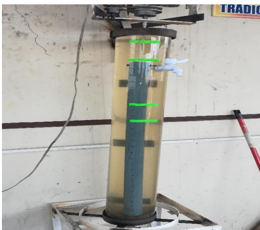
Ilustración 43: Filtro de 1 metro para altura de 1.15 m
