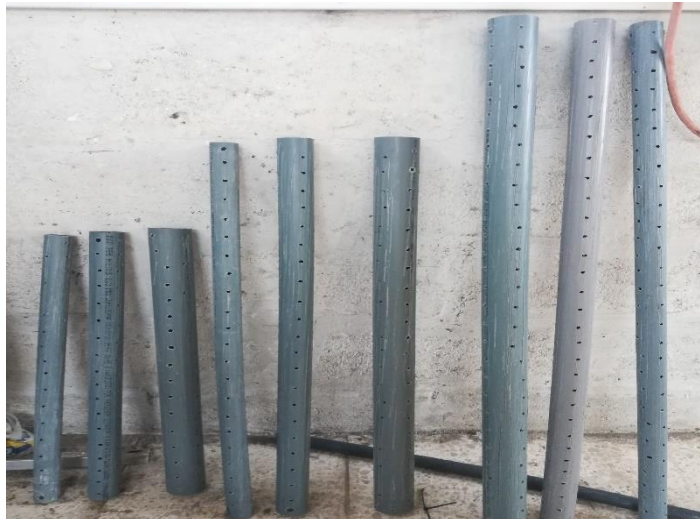
Ilustración 17: Tubos para filtros antes de unirlos Elaborado por: Ramos Medina W. (2018).
