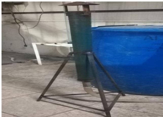
Ilustración 15: Quemador de gas metano Elaborado por: Ramos Medina W. (2018).
