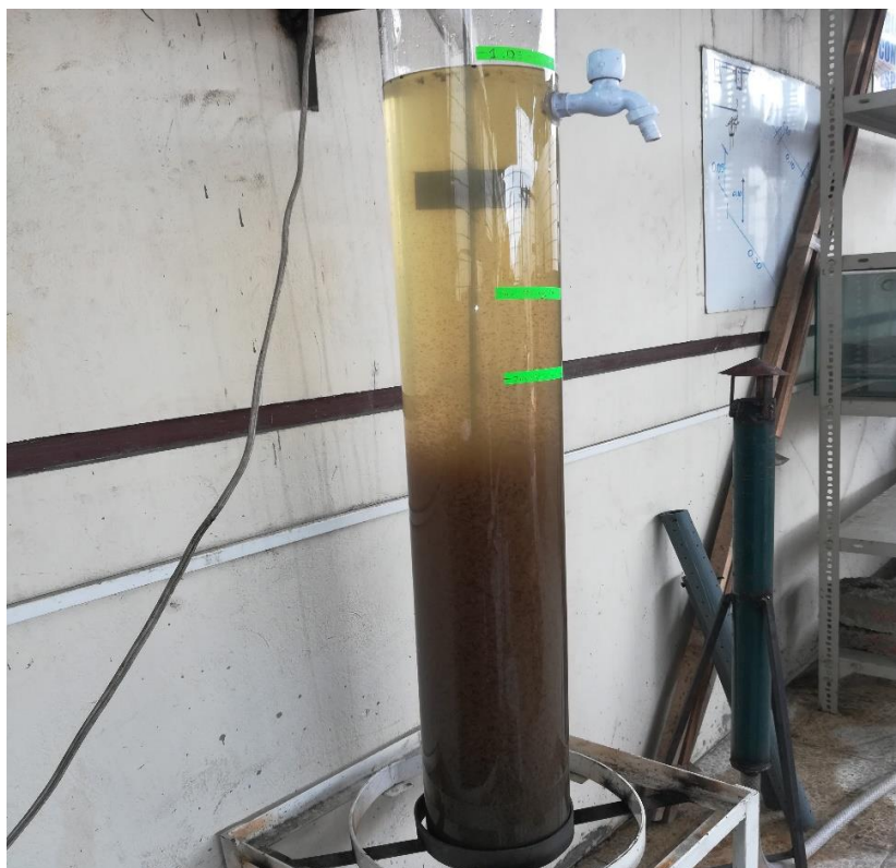
Ilustración 33: Después del mezclado los Sólidos se empiezan a degradar hacia el fondo Elaborado por: Ramos Medina W. (2018)
