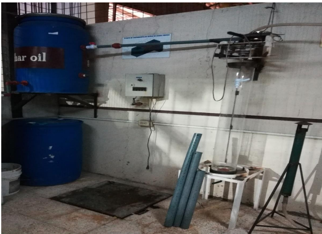
Ilustración 18: Reactor anaeróbico secuencial para tratar agua residual doméstica Elaborado por: Ramos Medina W. (2018)
