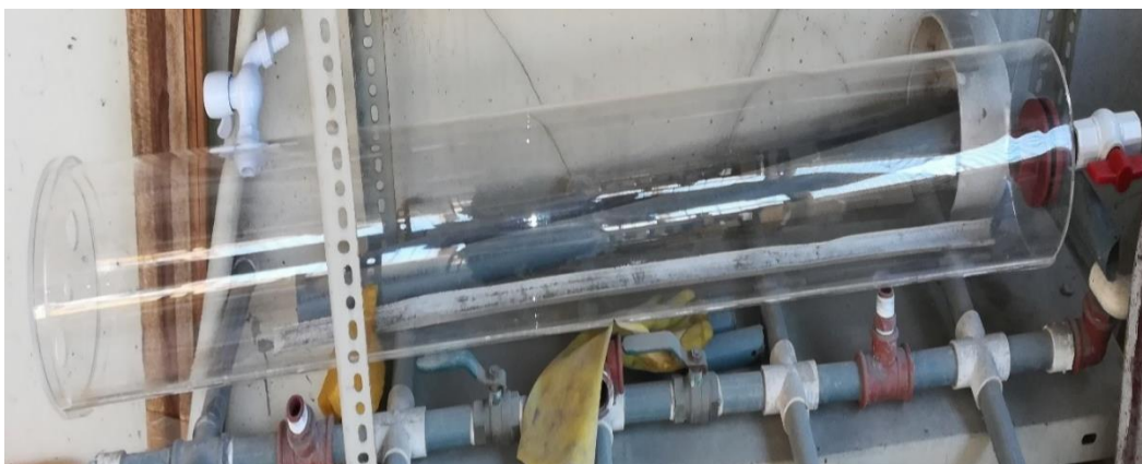
Ilustración 10: Tubo acrílico de 1.20 m por 0.15 m
