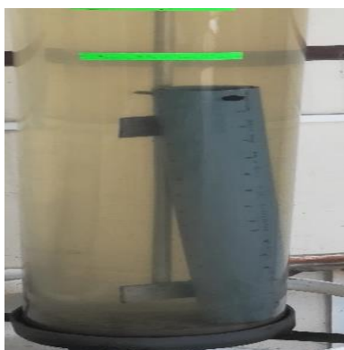
Ilustración 50: Filtro de 0.60 metros
