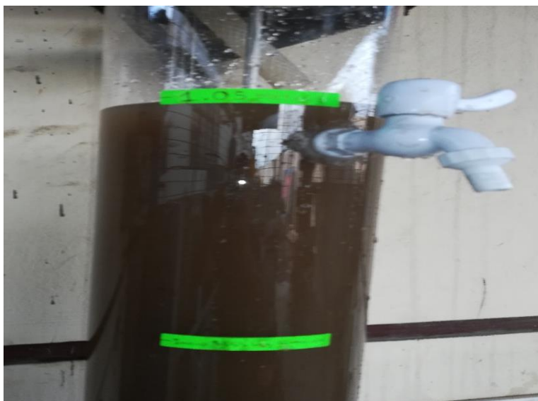
Ilustración 32: Nivel de llenado de 1.05 m, del agua residual más inóculo Elaborado por: Ramos Medina W. (2018).
