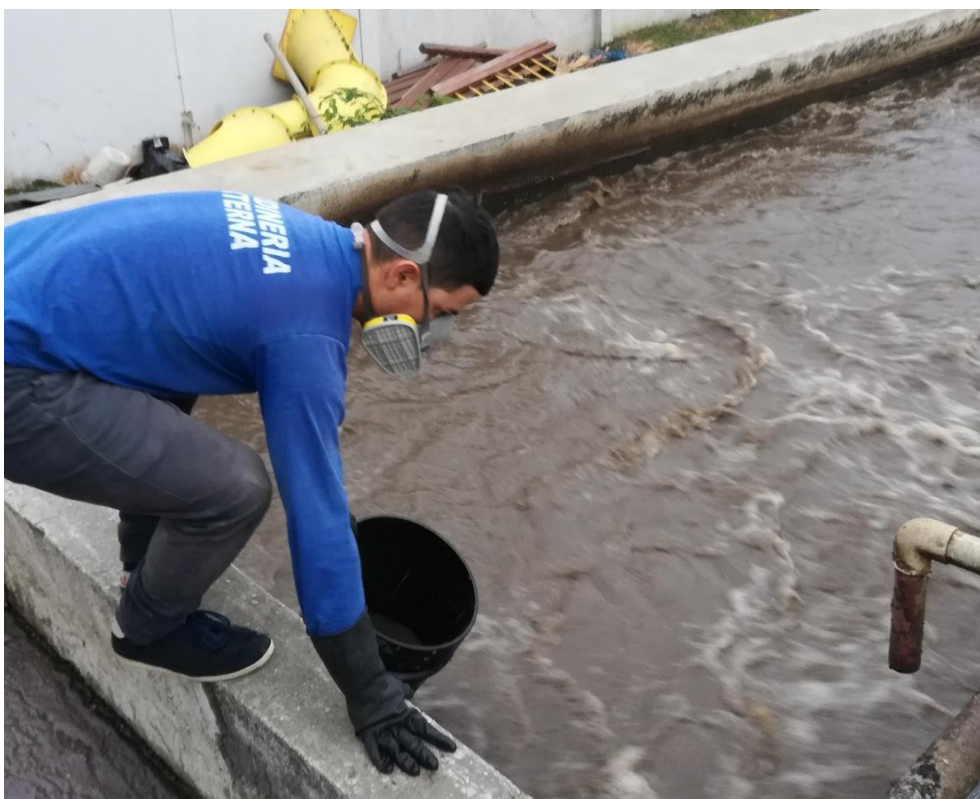
Ilustración 25: Extracción de agua del tanque de aireación Elaborado por: Ramos Medina W. (2018).
