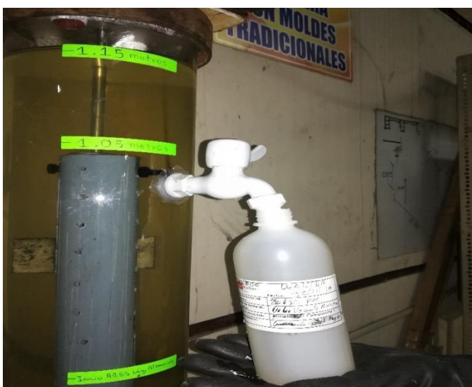
Ilustración 45: Etapa de vaciado (toma de muestra)
