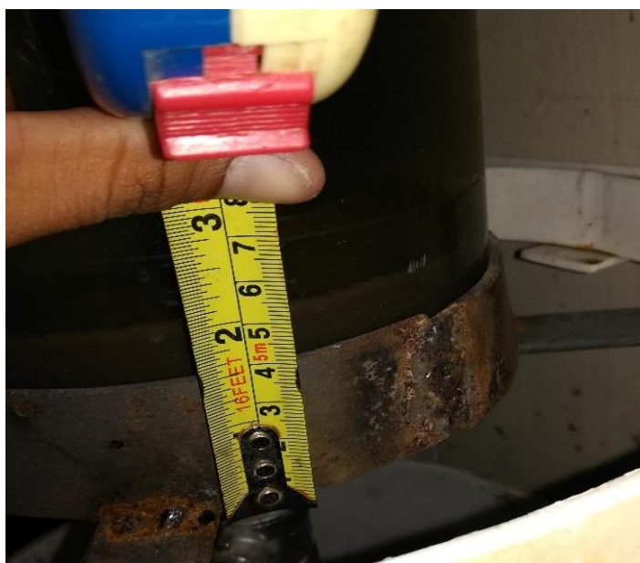
Ilustración 52: Volumen del sedimento al fondo del acrílico
