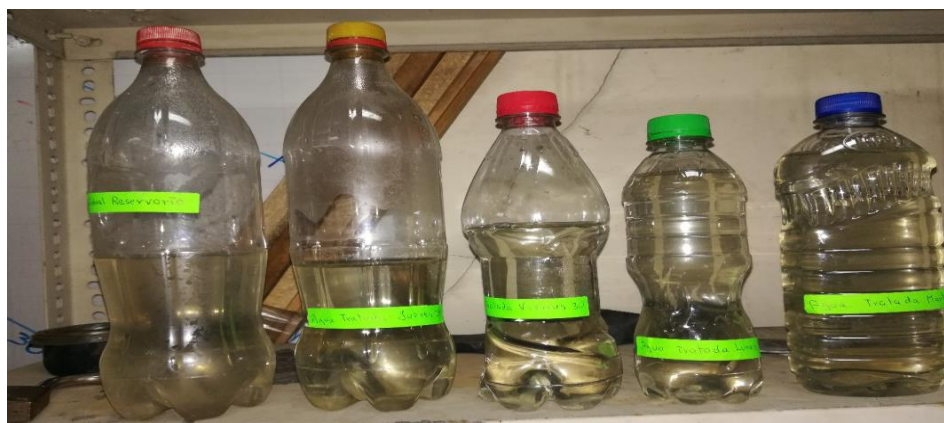
Ilustración 54: Comparación del agua residual de planta piloto con las aguas residuales tratadas
