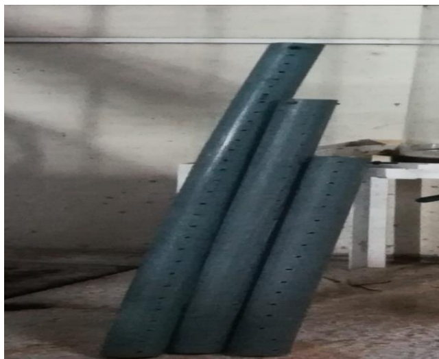
Ilustración 16: Filtros de PVC de 1 m, 0.8 m, 0.6 m para etapa de sedimentación Elaborado por: Ramos Medina W. (2018)
