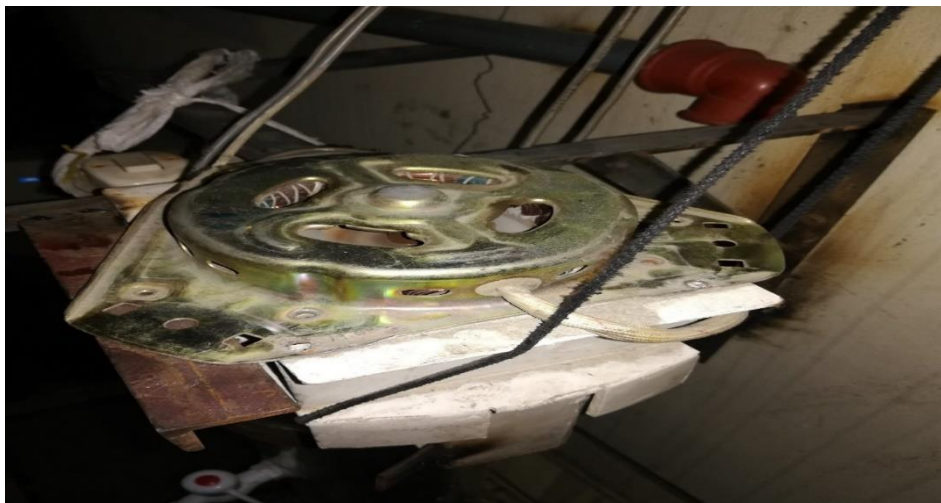
Ilustración 6: Motor de 1 HP de potencia Elaborado por: Ramos Medina W. (2018)
