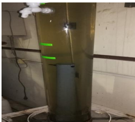
Ilustración 39: Filtro de 0.6 para etapa de sedimentación
