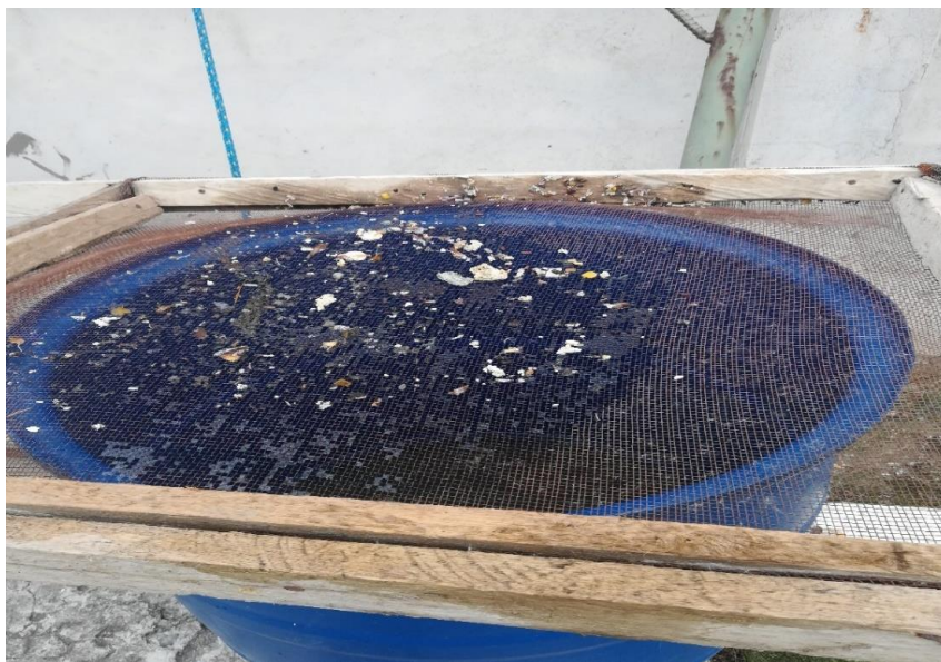
Ilustración 20: Malla para impedir el paso de Sólidos
