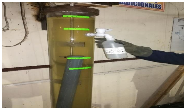
Ilustración 48: Etapa de vaciado (toma de muestra)
