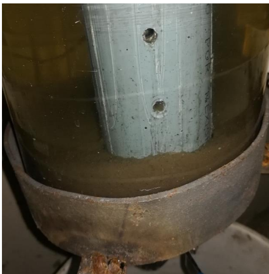
Ilustración 44: Flóculos adheridos al filtro
