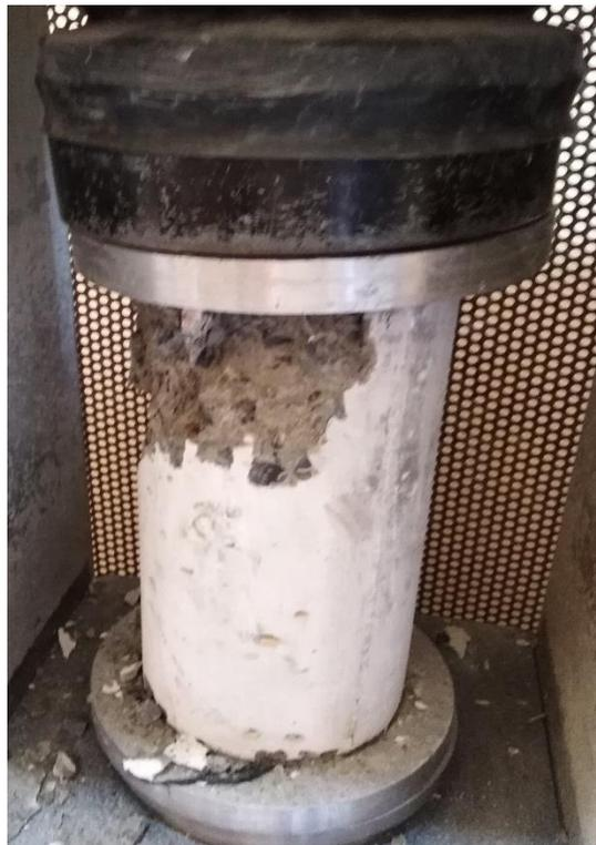
Prueba 2, realización de ensayo a compresión a cilindro con 5% de caucho fino
