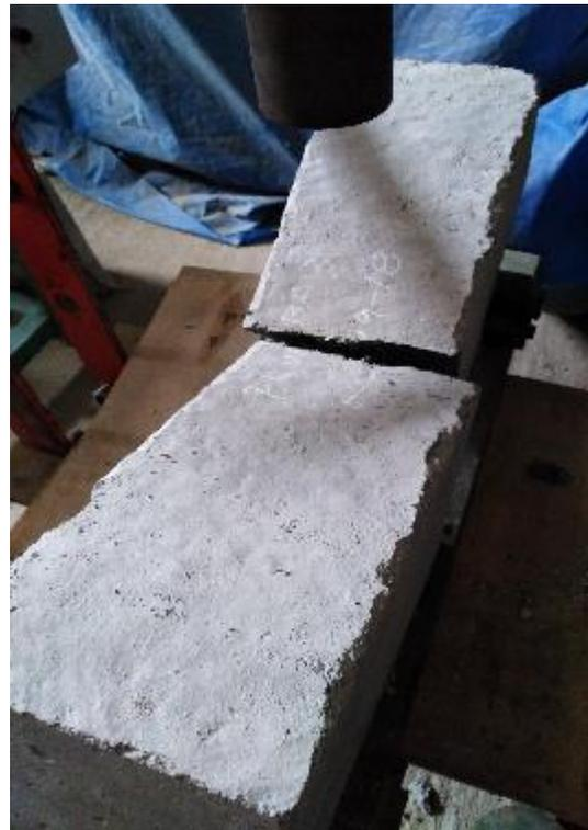
Prueba 4, realización de ensayo a tracción a viga con 5% de caucho grueso
