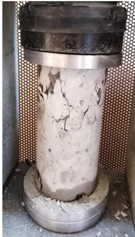
Prueba 5, realización de ensayo a compresión a cilindro con 10 % de caucho grueso
