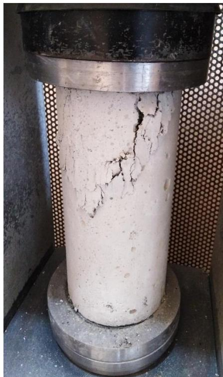
Prueba 4, realización de ensayo a compresión a cilindro con 5 % de caucho grueso
