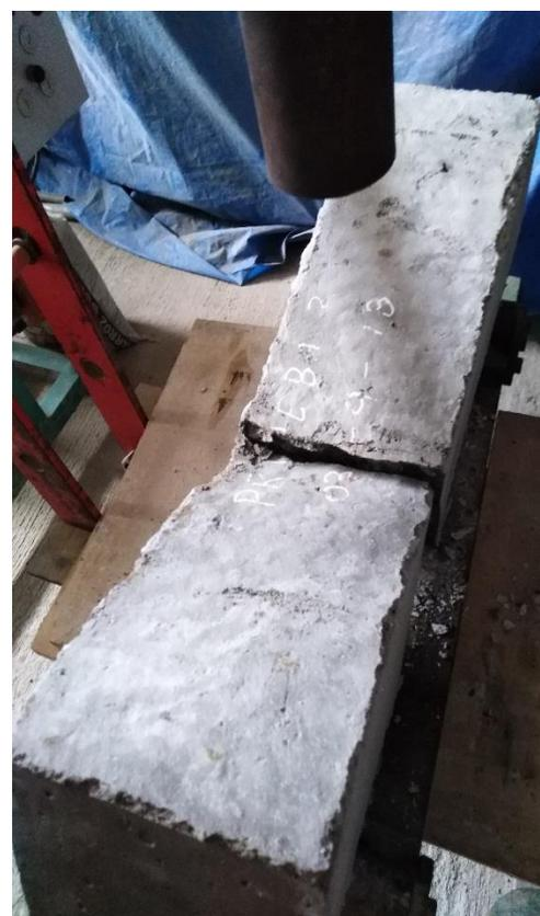
Prueba 3, realización de ensayo a tracción a viga con 10% de caucho fino
