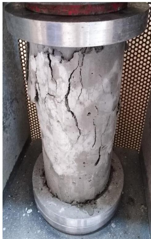
Prueba 3, realización de ensayo a compresión a cilindro con 10 % de caucho fino
