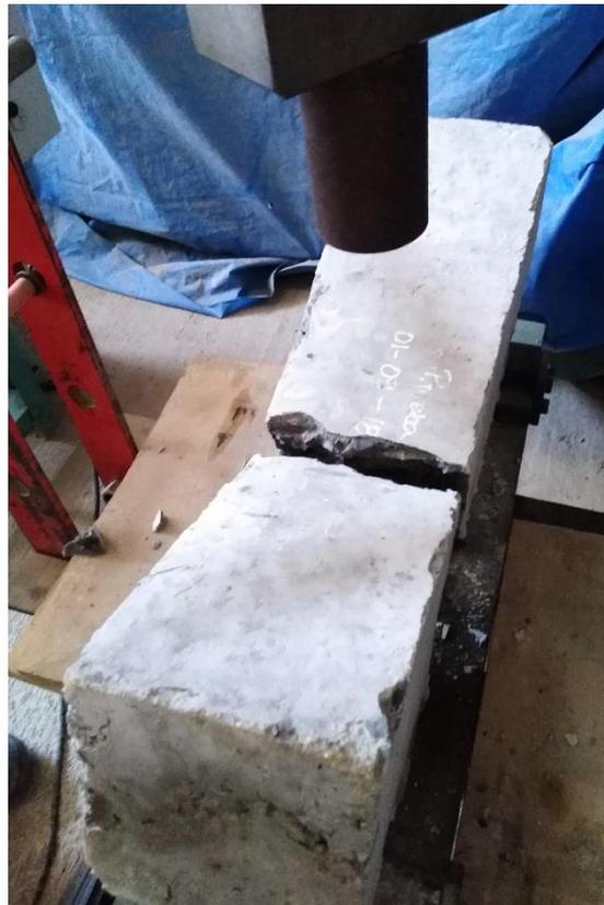
Prueba 2, realización de ensayo a tracción a viga con 5% de caucho fino
