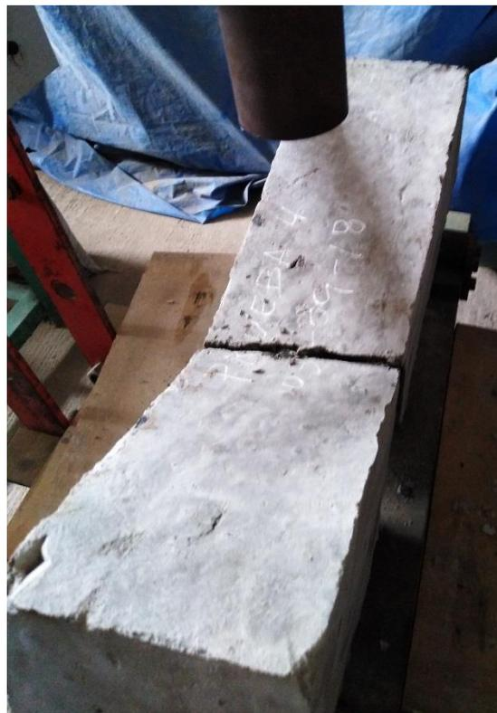
Prueba 5, realización de ensayo a tracción a viga con 10% de caucho grueso
