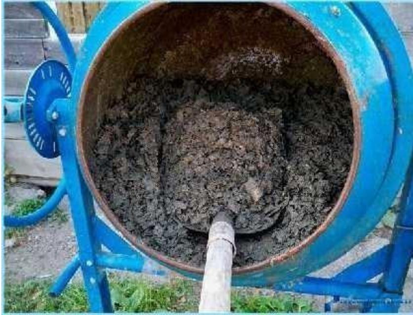
*Figura 3.* Mezcla bloques de madera y hormigón.
