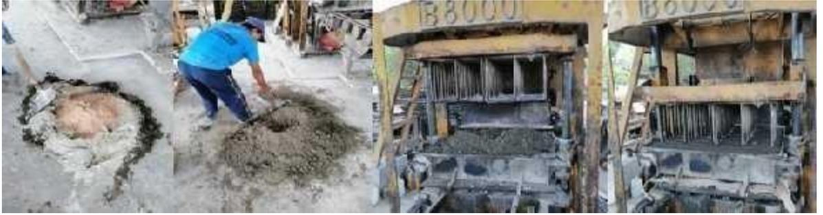
**Figura 51:** Fotografías del proceso mecanizado del bloque.
