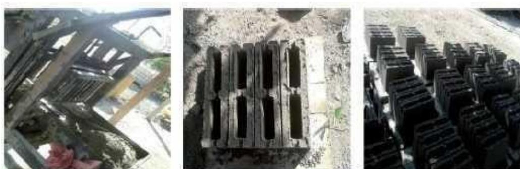
*Figura 10.* Elaboración de bloques de construcción de cenizas centrales térmicas; cascarilla de arroz y cenizas.
