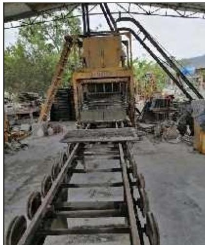
**Figura 39:** Máquina Bloquera
