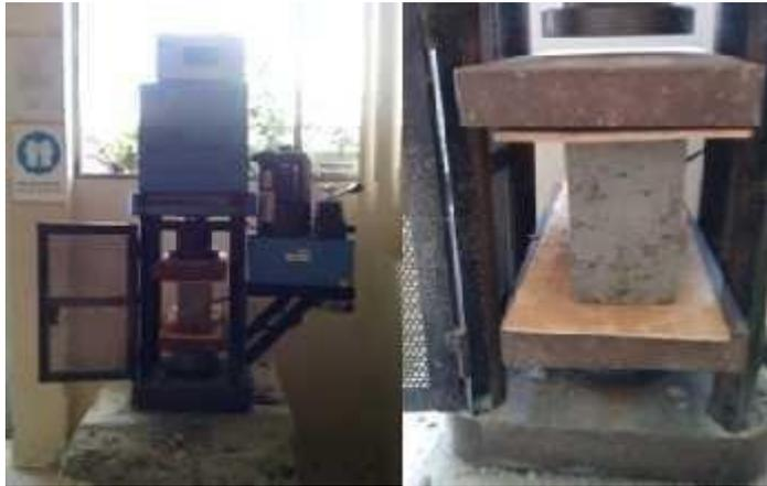
**Figura 54:** Ensayo de resistencia a compresión.
