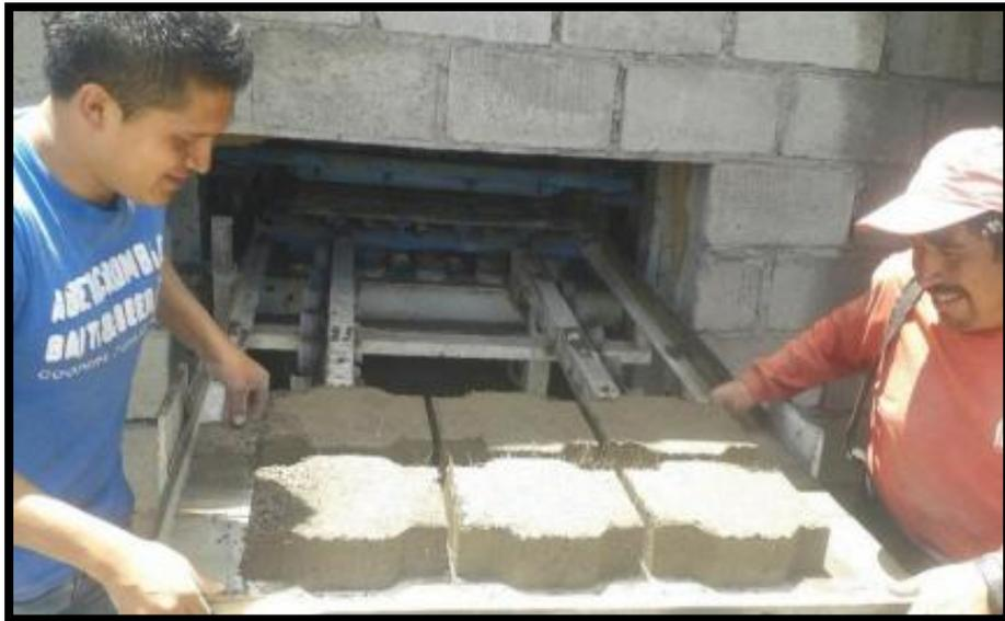
*Imagen 6. Adoquines con estopa de coco y fibras de vidrio*
