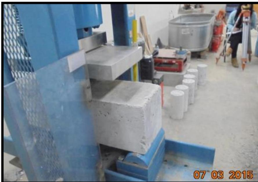
*Imagen 7. Especímenes de hormigón con fibra de coco*
