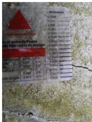
Figura 90. Medición de ancho de fisura # 5 = 0,6604 mm
