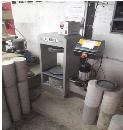
Figura 35. Máquina empleada para ensayo de compresión de cilindros de hormigón.
