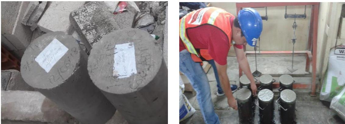
Figura 33. Colocación de etiquetas para identificación de pórticos en cada cilindro.
