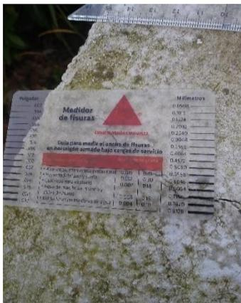
Figura 60. Medición del ancho de fisura # 3= 0,7112 mm
