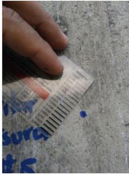
Figura 51. Medición del ancho de la fisura #4= 0,3048 mm
