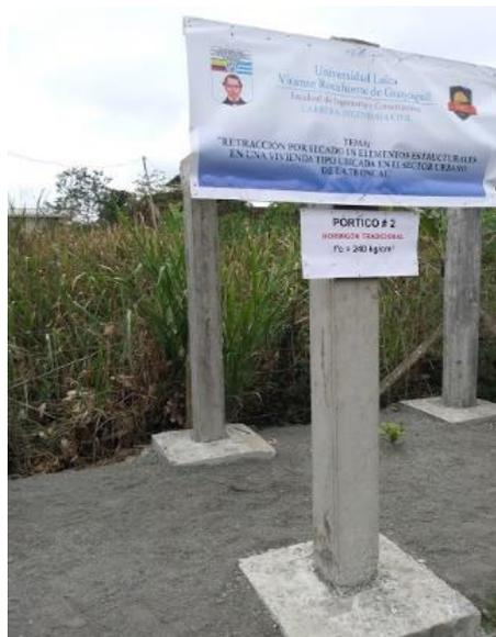
Figura 28. Muestra de hormigón tradicional. Pórtico # 2
