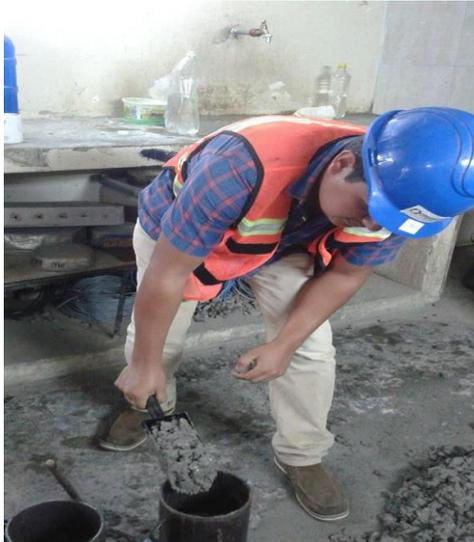
Figura 30. Toma de muestras en cilindros
