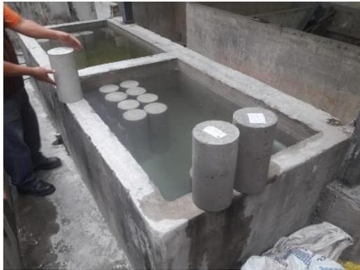
Figura 34. Curado de cilindros de hormigón
