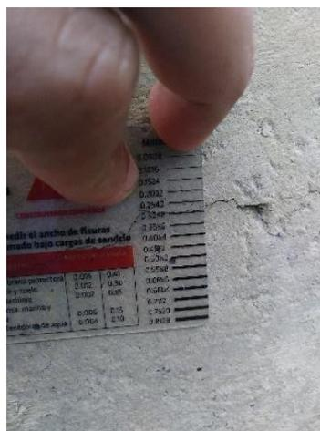
Figura 75. Medición de ancho de fisura # 5 = 0,3048 mm
