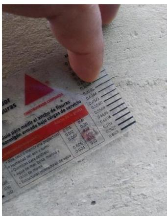
Figura 57. Medición del ancho de fisura # 3, #4, #6= 0,3556 mm
