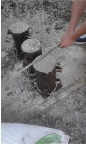
Figura 32. Enrasado de los cilindros con muestra de hormigón
