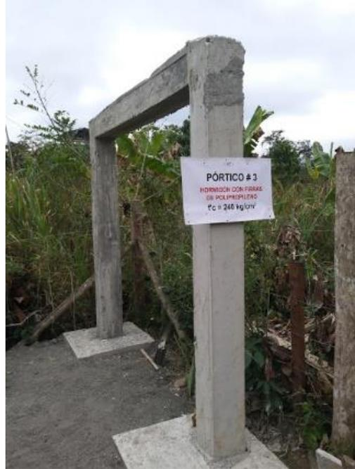
Figura 29. Muestra de hormigón con fibras de polipropileno. Pórtico # 3
