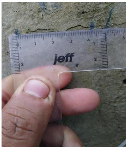
Figura 94. Medición de la longitud de fisura # 2 = 5,10 cm
