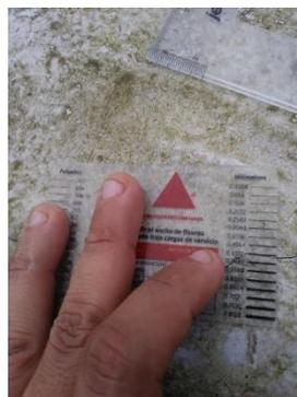
Figura 102. Medición del ancho de la fisura # 1 = 0,4572 mm
