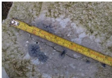
Figura 80. Medición de la longitud de fisura # 2 = 15,25 cm
