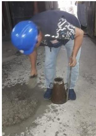
Figura 20. Ensayo con el cono de Abrams
