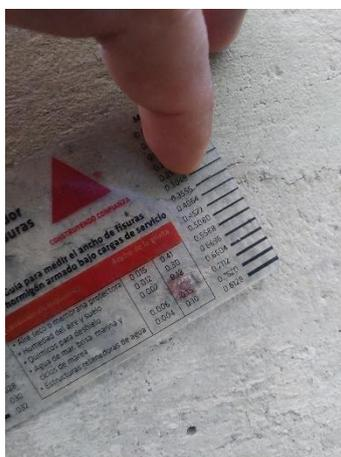
Figura 63. Medición del ancho de fisura #3, #4, #6= 0,3556 mm
