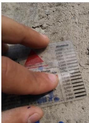
Figura 48. Ancho máximo de fisura #3= 0,4572 mm
