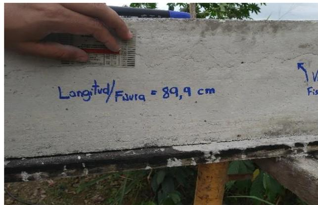
Figura 65. Medición de la longitud de fisura # 7
