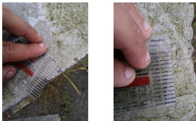
Figura 69. Medición de ancho de fisuras (0, 1016 mm – 0,2540 mm)
