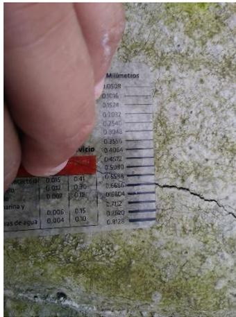
Figura 54. Medición del ancho de fisura #3= 0,6696 mm
