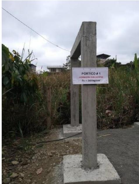
Figura 27. Muestra de hormigón con aditivo acelerante. Pórtico # 1
