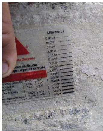
Figura 78. Medición del ancho de fisuras #5 y #6= 0,4064 mm
