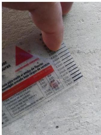
Figura 99. Medición de ancho de fisura # 1= 0,3556 mm
