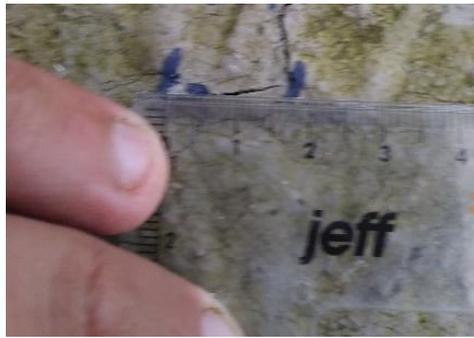
Figura 70. Medición de la longitud de la fisura # 4= 1,90 cm
