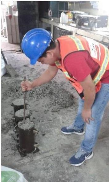
Figura 31. Apisonado del hormigón por medio de una varilla lisa
