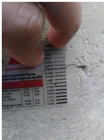
Figura 93. Medición de ancho de fisuras #1 y #3= 0,3048 mm
