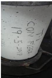
Figura 40. Cilindro de hormigón con fibra de polipropileno antes de ser sometido a una carga
