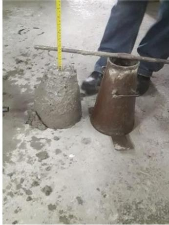
Figura 21. Levantamiento del molde y medición del hormigón
