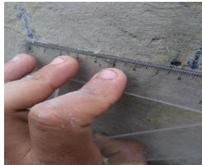
Figura 98. Medición de longitud de fisura # 1= 8,35 cm
