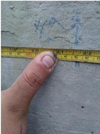
Figura 83. Medición de la longitud de fisura # 9= 55,20 cm
