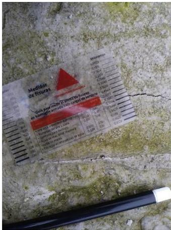
Figura 84. Medición del ancho de fisura #5= 0,5588 mm
