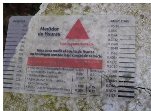
Figura 66. Medición de ancho de fisura # 3 = 0,7112 mm
