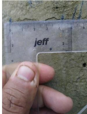
Figura 100. Medición de la longitud de fisura #2 = 5,60 cm
