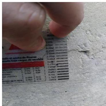
Figura 72. Medición del ancho de fisura #1, #5, #6 = 0,3048 mm
