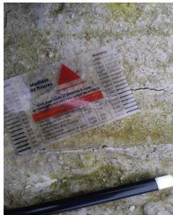
Figura 87. Medición del ancho de fisura #5= 0,5588 mm
