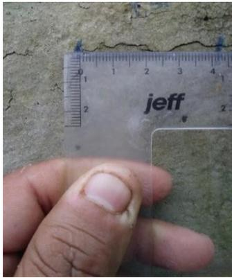
Figura 91. Medición de longitud de fisura # 2 = 4,20 cm
