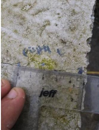
Figura 88. Medición de la longitud de fisura # 4 = 4,90 cm
