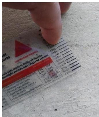
Figura 81. Medición del ancho de fisura # 5 = 0,3556 mm
