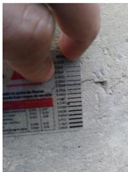
Figura 45. Medición del ancho de las fisuras # 3, #4, # 6 = 0,3048 mm
