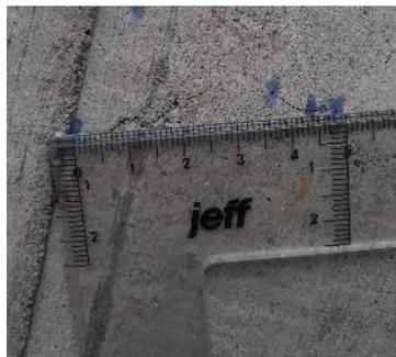
Figura 52. Medición de longitud de fisura #4= 4,40 cm
