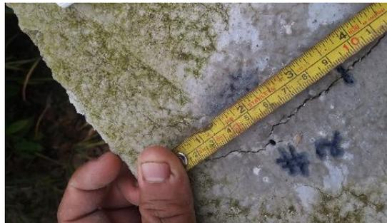
Figura 68. Medición de longitud de fisura # 2 = 9,10 cm
