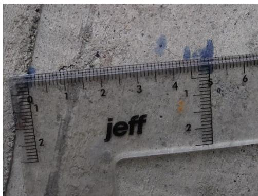
Figura 58. Medición de la longitud de la fisura # 9 = 5,10 cm
