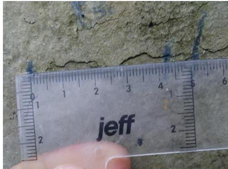
Figura 97. Medición de longitud de fisura #2 = 5,17 cm
