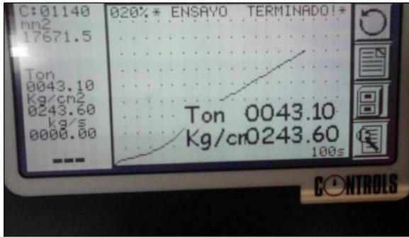
Figura 39. Resistencia obtenida a los 28 días en un cilindro de hormigón tradicional.
