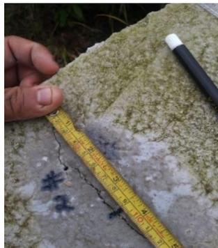
Figura 101. Medición de la longitud de fisura # 1= 9,00 cm
