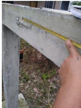
Figura 44. Medición de la longitud de fisura # 4= 39,40 cm
