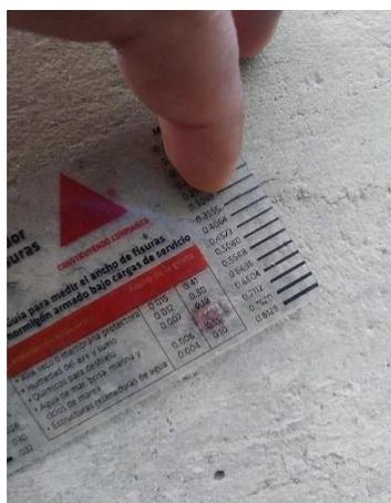
Figura 96. Medición del ancho de fisura # 1 = 0,3556 mm
