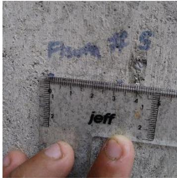
Figura 55. Medición de la longitud de la fisura # 5 = 3,45 cm
