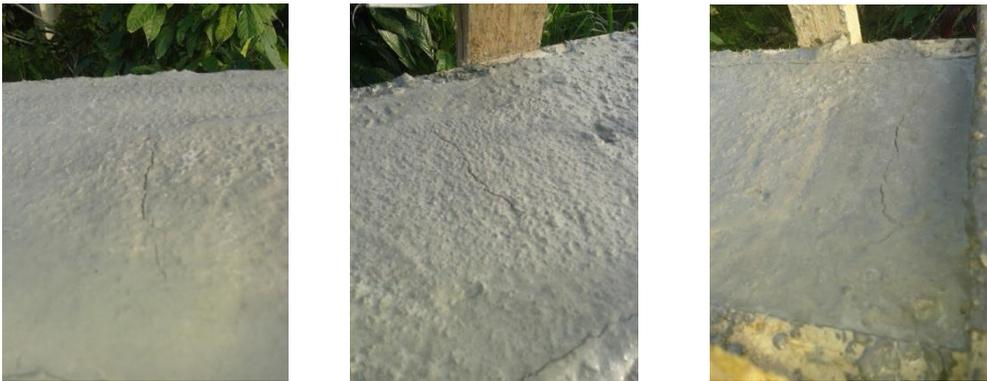
Figura 42. Primeras fisuras localizadas en la parte superior de la viga
