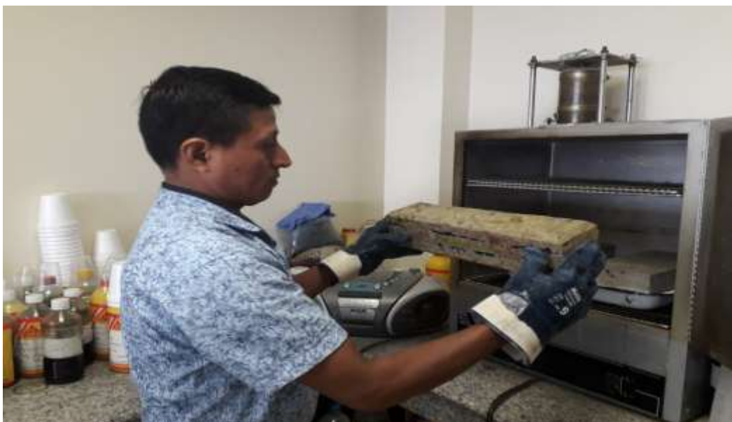
Imagen 19. Ensayo de temperatura del bloque en base PET. Se aumenta la temperatura a 225°C durante 3 horas para comprobar en qué tiempo empieza la fusión. Elaborado por: Pin Parrales, J. (2019)
