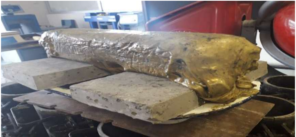
Imagen 23. Estado de fusión del bloque en base PET. Elaborado por: Pin Parrales, J. (2019)
