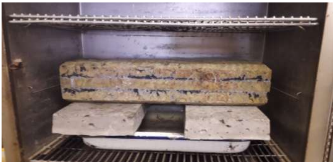
Imagen 18. Ensayo de temperatura del bloque en base PET.
