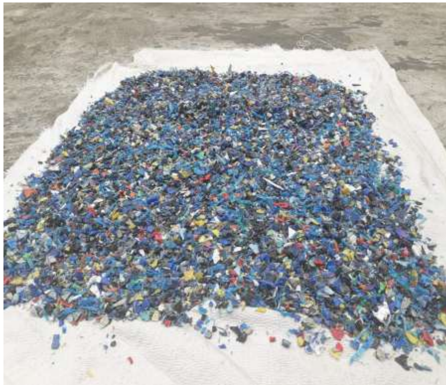
Imagen 3. PET lavado y tendido para secado. Elaborado por: Pin Parrales, J. (2019)
