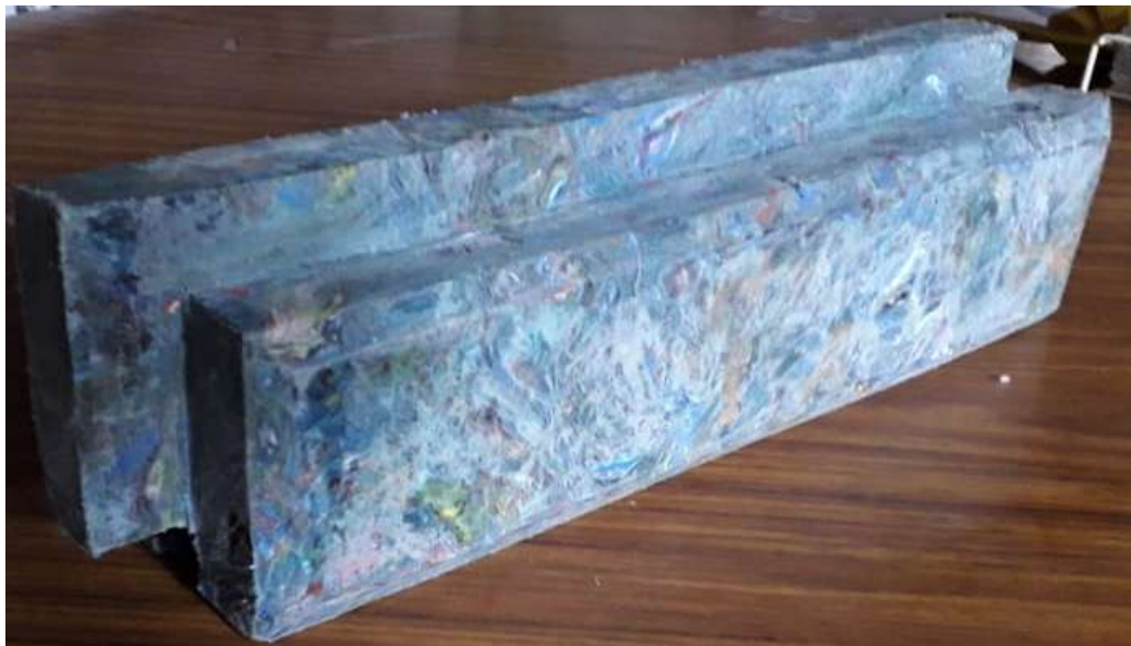
Imagen 24. Estado de fusión del bloque en base PET. Elaborado por: Pin Parrales, J. (2019)
