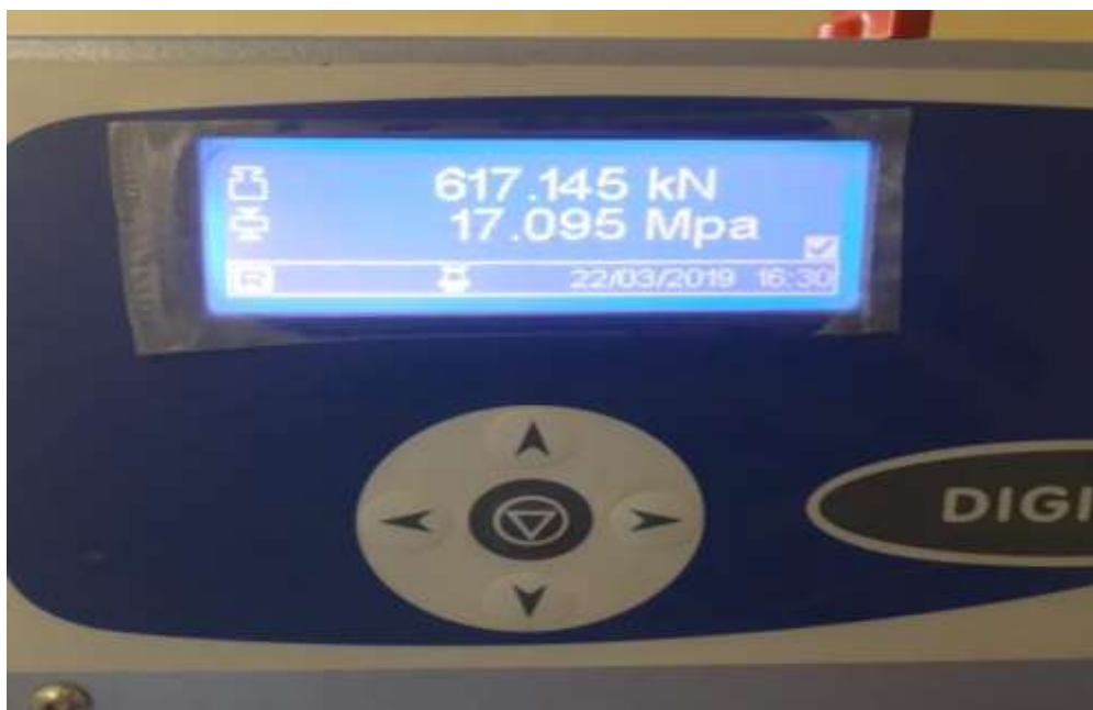
Imagen 15. Ensayo de resistencia a la compresión del bloque en base PET. Se obtienen y registran los datos de resistencias máximas a la compresión.
