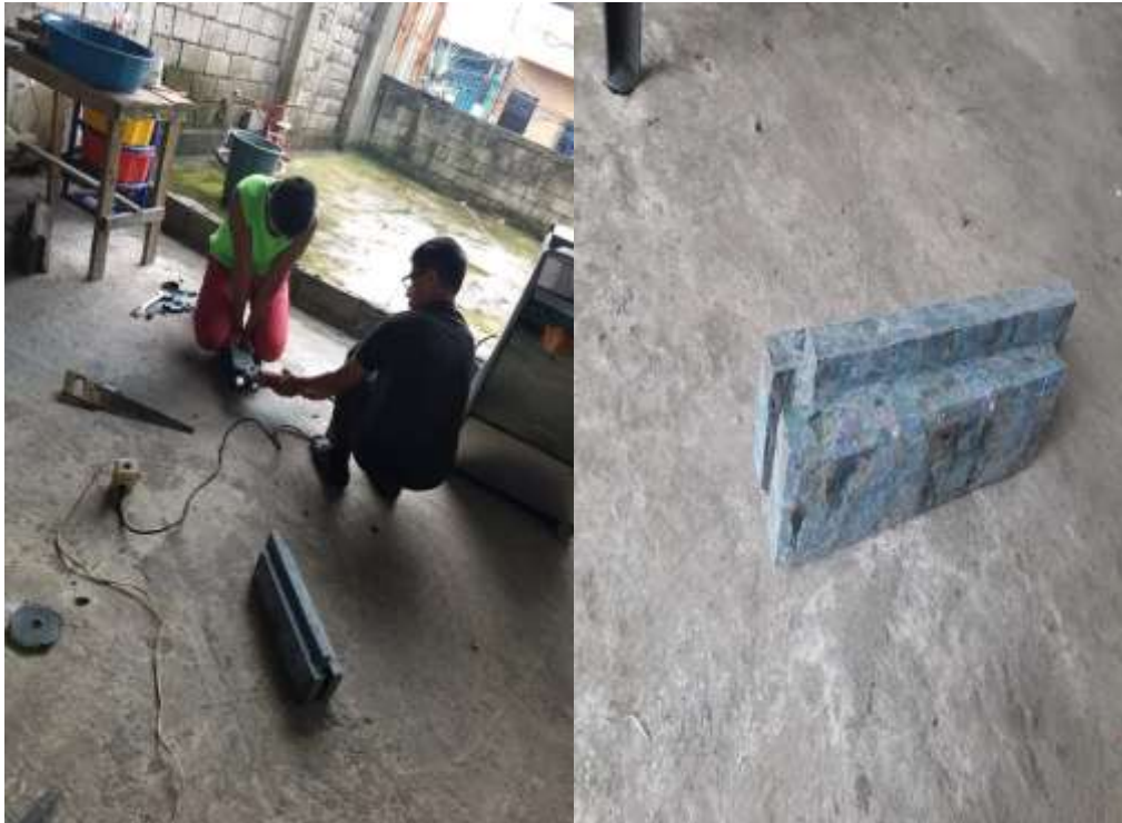
Imagen 10. Eliminación de residuos y limpieza de la muestra.
