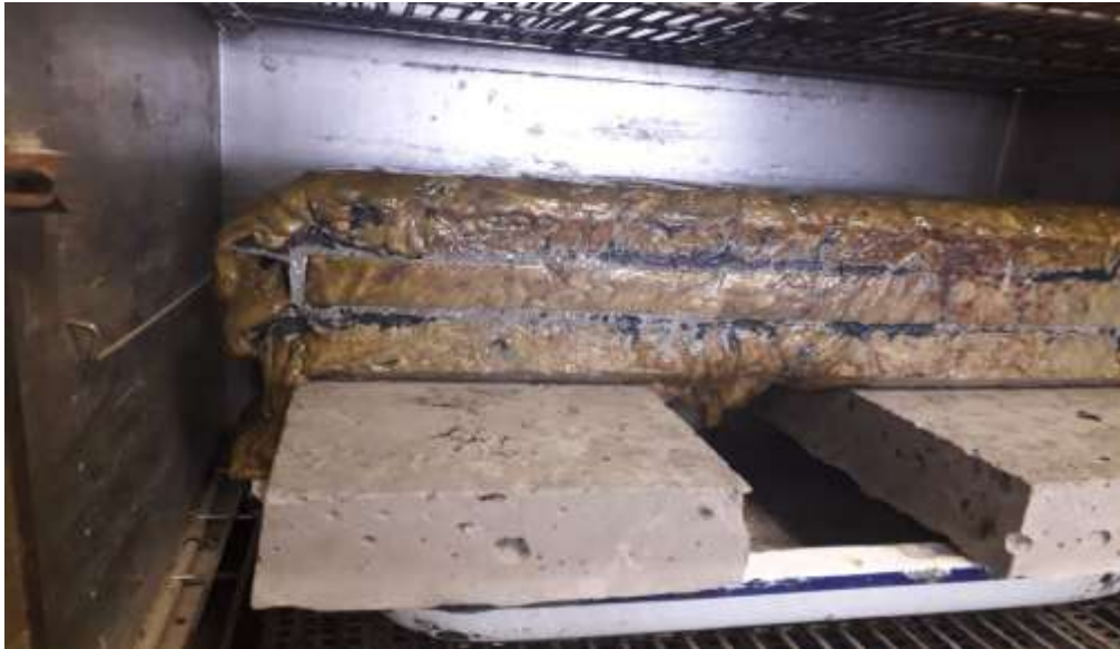
Imagen 21. Ensayo de temperatura del bloque en base PET. Luego de cinco horas la muestra alcanza un punto de fusión del 4%. Elaborado por: Pin Parrales, J. (2019)
