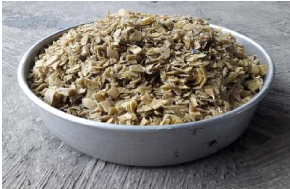
Imagen 5. PET en un recipiente de aluminio para secado. Elaborado por: Pin Parrales, J. (2019)
