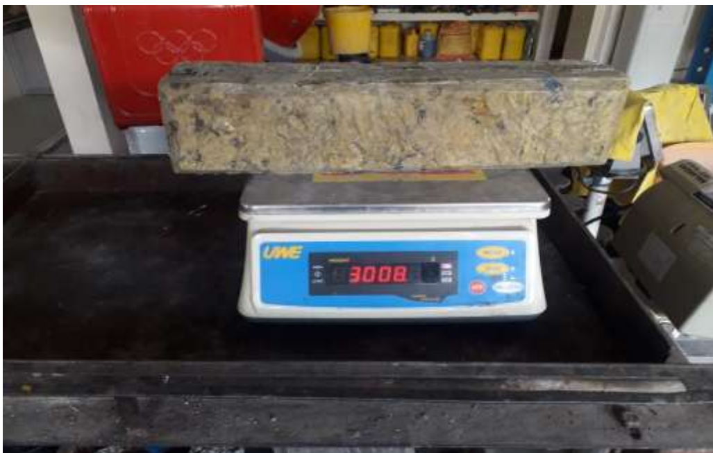
Imagen 11. Ensayo de rotura a la compresión del bloque en base PET. Se procedo a pesar el bloque en una balanza UWE (0 lib a 66 lib). Pesos obtenidos en gramos 3008gr comparado con un bloque tradicional que el peso es de 6860gr.
