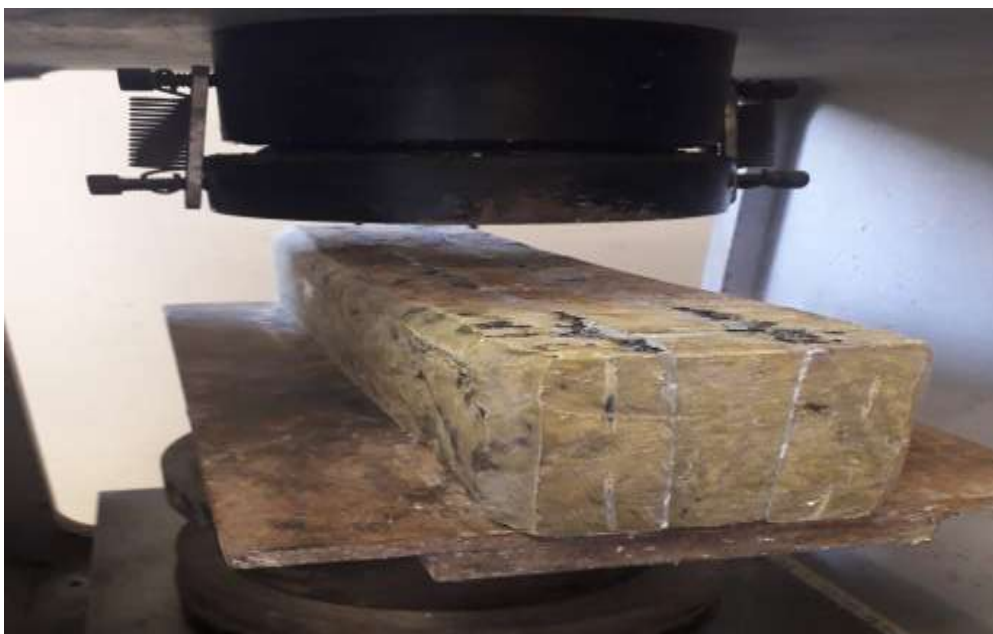
Imagen 16. Ensayo de resistencia a la compresión del bloque en base PET.
