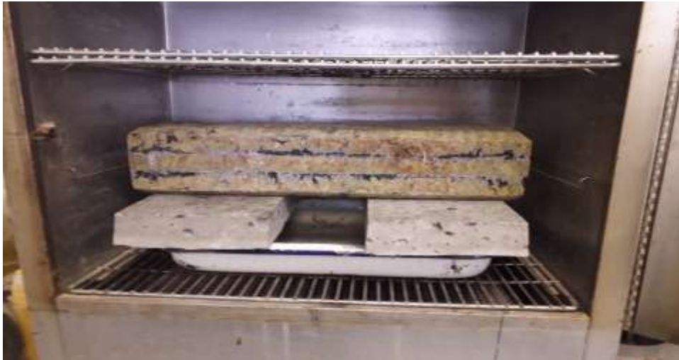
Imagen 17. Ensayo de temperatura del bloque en base PET.
