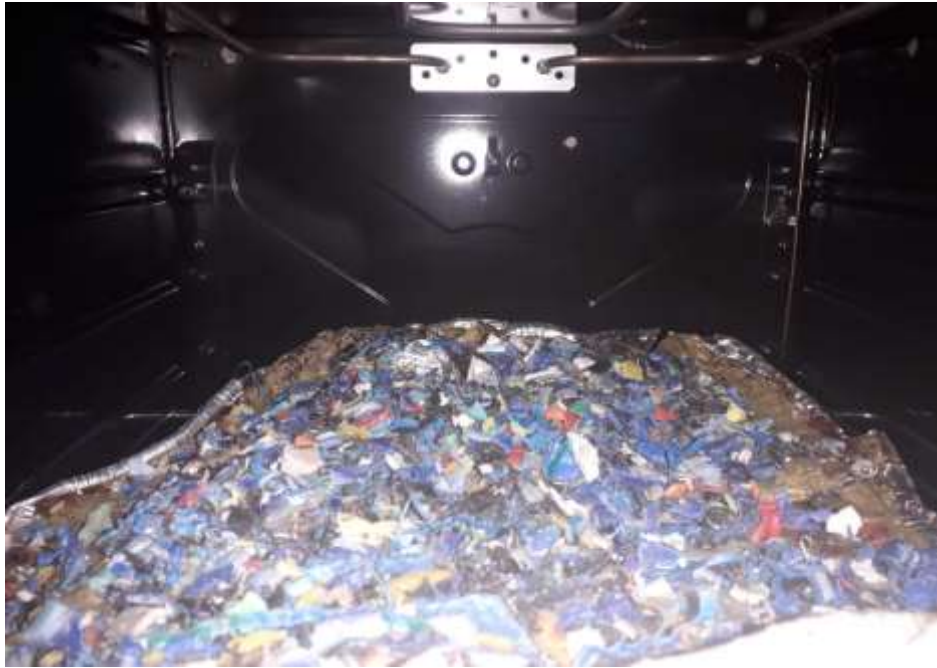
Imagen 4. PET en el horno a 170°. Elaborado por: Pin Parrales, J. (2019)
