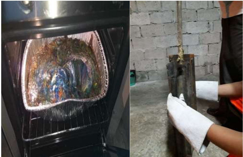
Imagen 7. PET líquido vaciado y luego compactado. Elaborado por: Pin Parrales, J. (2019)
