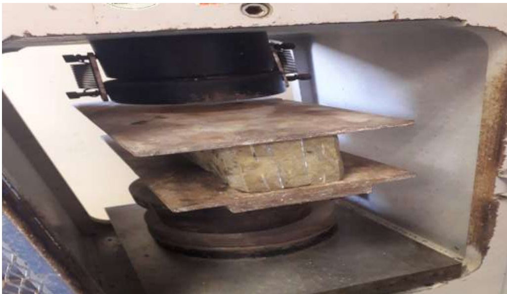
Imagen 13. Ensayo de rotura a la compresión del bloque en base PET.
