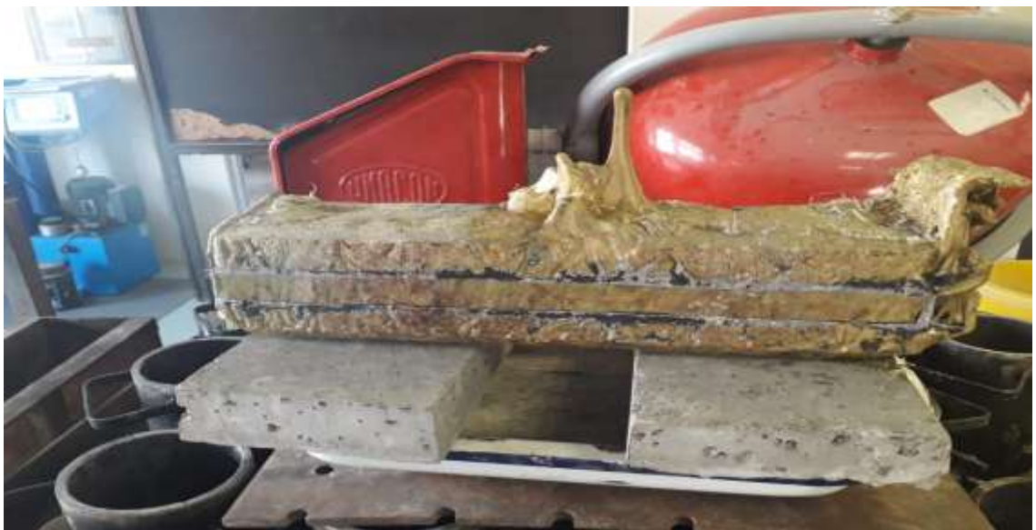
Imagen 24. Estado de fusión del bloque en base PET. Elaborado por: Pin Parrales, J. (2019)
