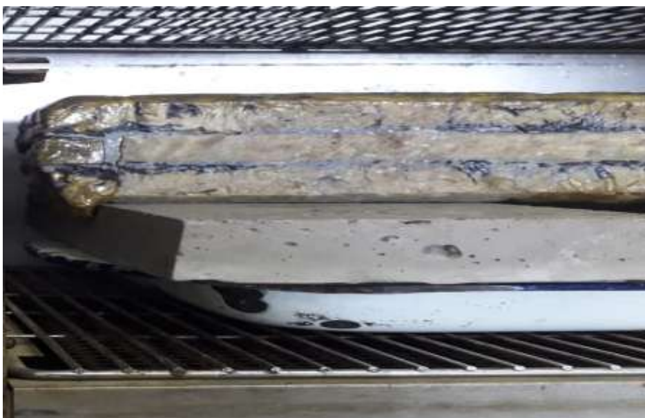
Imagen 20. Ensayo de temperatura del bloque en base PET. Cumplidas las 3 horas el bloque ha empezado en un 2% el punto de fusión. Luego vuelvo a ingresar la muestra durante dos horas más en el horno. Elaborado por: Pin Parrales, J. (2019)
