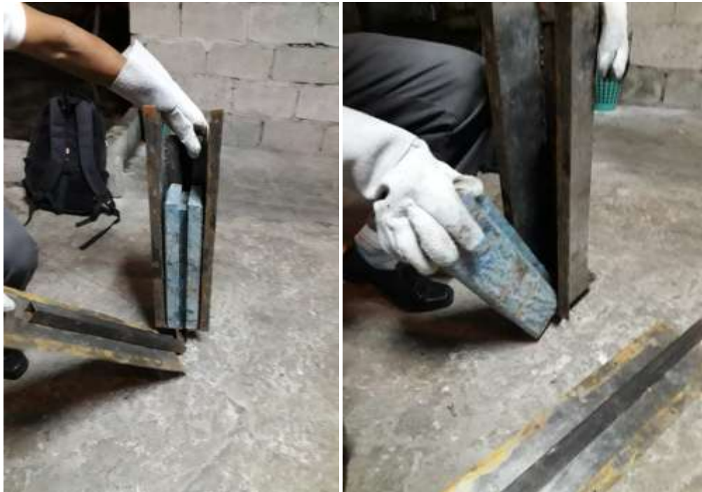
Imagen 9. Muestra retirada del molde. Elaborado por: Pin Parrales, J. (2019)
