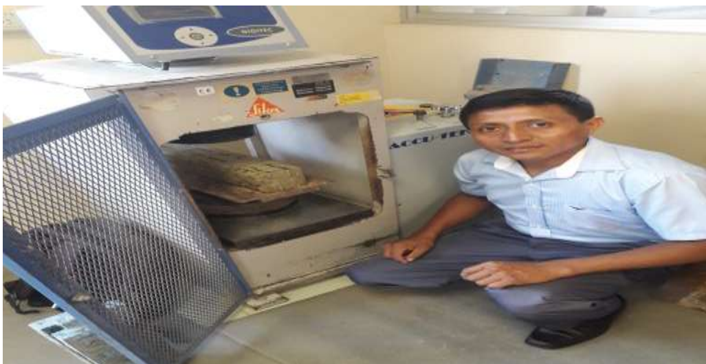
Imagen 12. Ensayo de rotura a la compresión del bloque en base PET. Se introduce el bloque en la máquina de compresión colocando primero una placa de acero de 10 mm de espesor.
