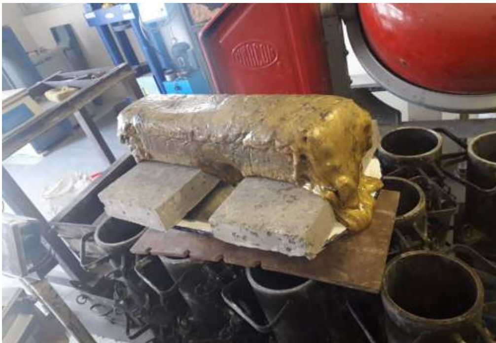
Imagen 22. Ensayo de temperatura del bloque en base PET. Transcurridos 6 horas en el horno a 225°C la muestra alcanza un 6% del 10% que es la totalidad en encontrar el punto de fusión. Elaborado por: Pin Parrales, J. (2019)
