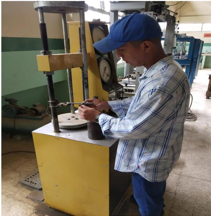
Figura 8. Ensayo De La Tensión En Acero.
