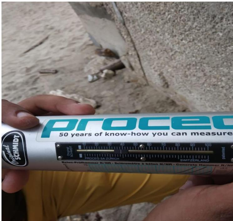
Figura 11 Prueba de resistencia al hormigón mediante el uso del esclerómetro.
