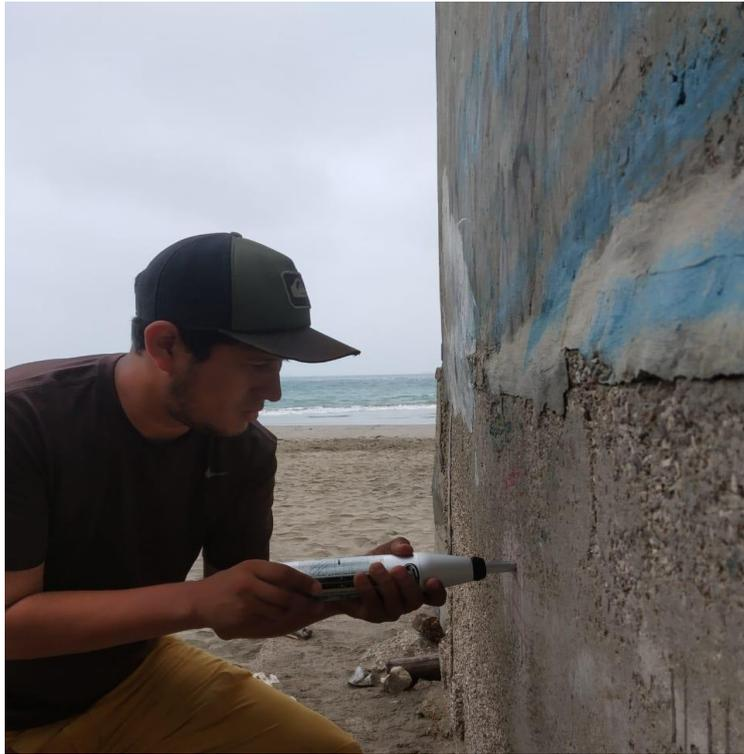
Figura 10. Prueba de resistencia al hormigón mediante el uso del esclerómetro.
