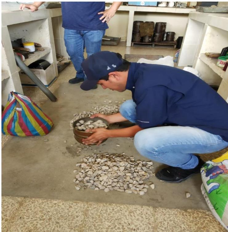
Figura 9. Ensayo de desgaste de sulfatos.
