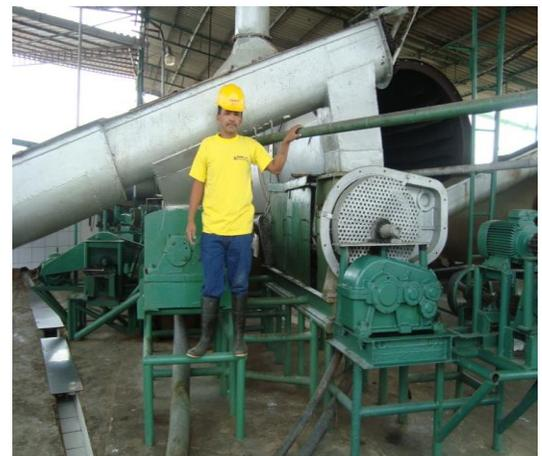
*Imagen3 Cocción - Desagüe - Prensado.*
