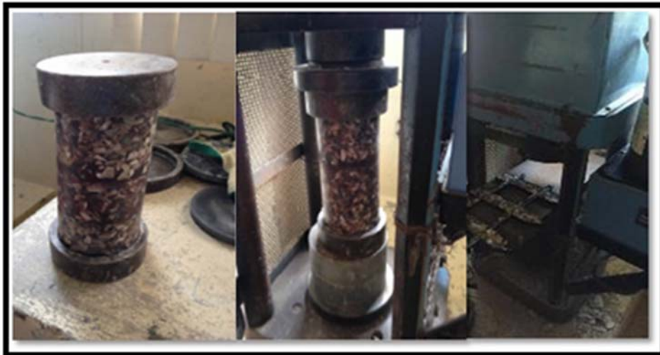
Figura 67. Ajuste de probetas para control de resistencia Elaborado por: Torres, F. (2019)
