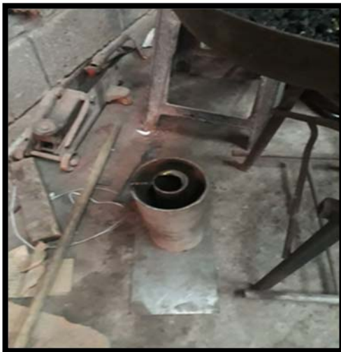
Figura 58. Vertido en el molde Elaborado por: Torres, F. (2019)
