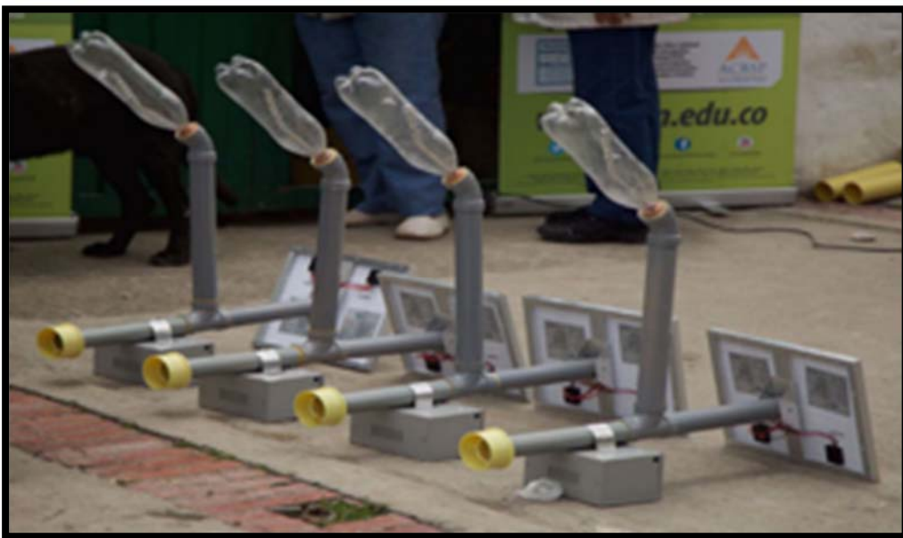
Figura 24. Alumbrado de luz con PVC Fuente: Ecuador forestal, 2012
