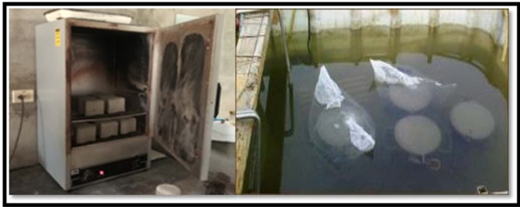
Figura 65 Curado y secado de muestras Elaborado por: Torres, F. (2019)
