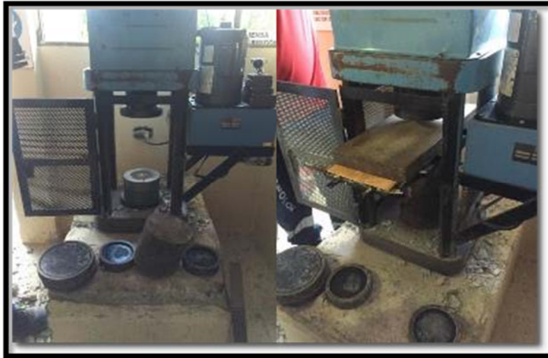
Figura 66. Ajuste de probetas para control de resistencia Elaborado por: Torres, F. (2019)
