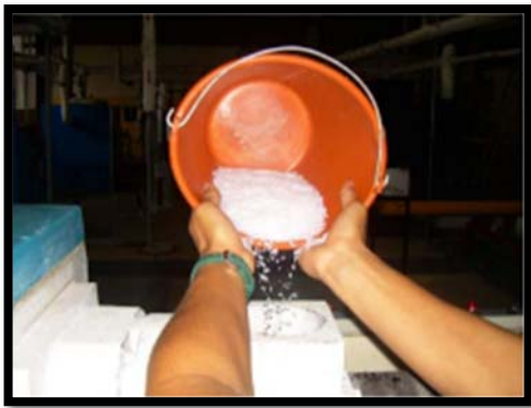
Figura 9. Aplicación de polietileno a la extrusora Fuente: Bravo, 2009
