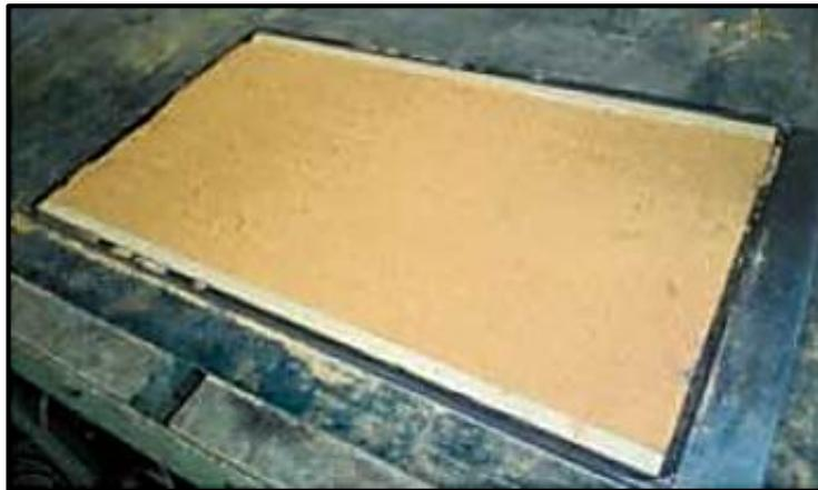
*Ilustración 15: Tablero de polvillo de aserrín en proceso*
