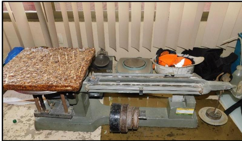
*Ilustración 52: Pesaje después de la sumersión*
