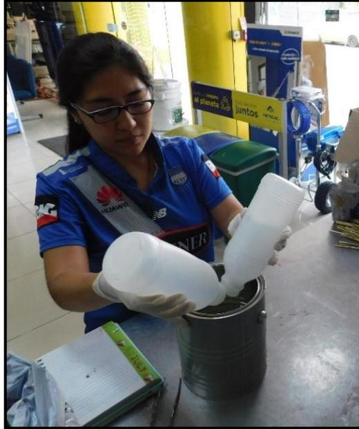
*Ilustración 44: Vertimiento de la resina de poliéster*
