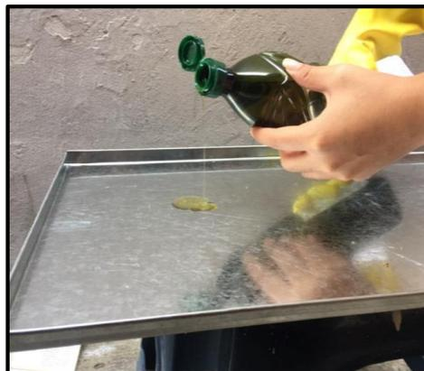
*Ilustración 33: Aplicación del aceite al molde (I)*
