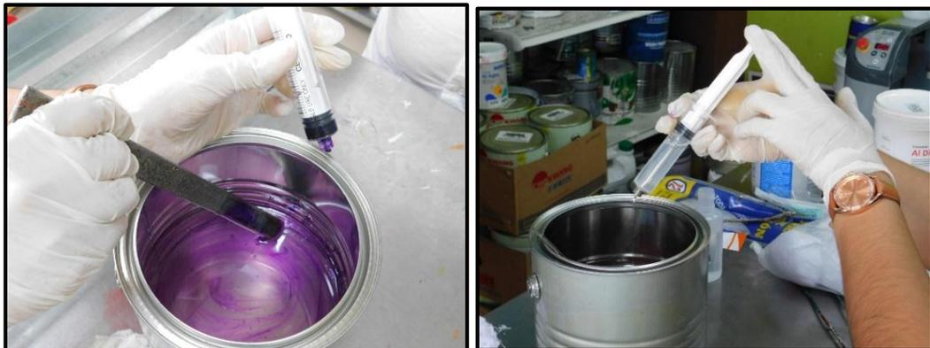
*Ilustración 45: Mezcla de Acelerante y secante al recipiente de resina*
