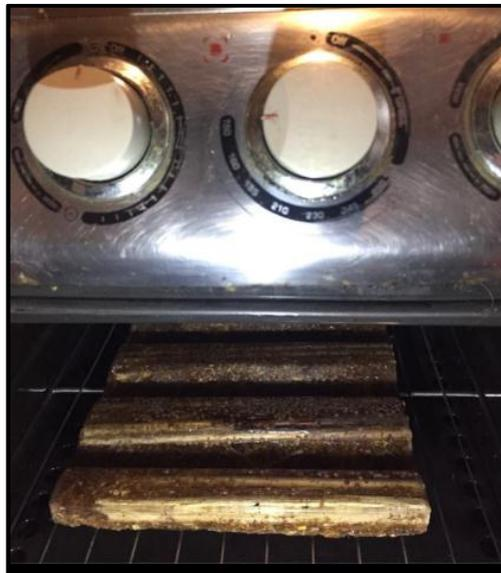
*Ilustración 54: Introducción del panel en horno a 150°C*
