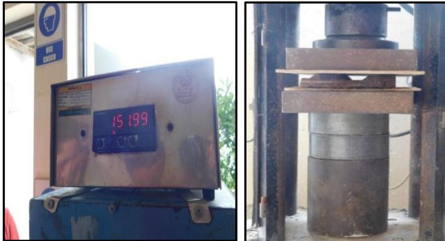
*Ilustración 48: Prueba de compresión al prototipo IV*
