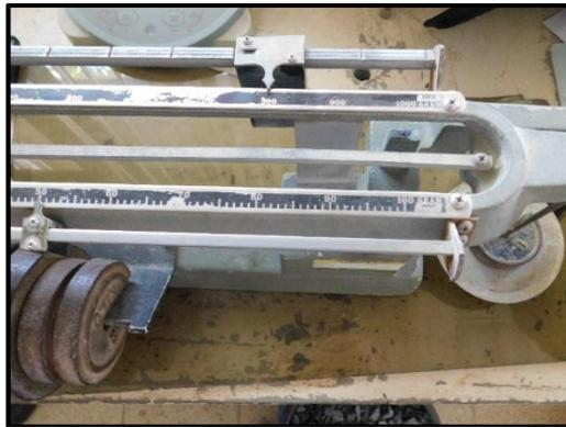
*Ilustración 50: Pesaje del prototipo antes de la sumersión*
