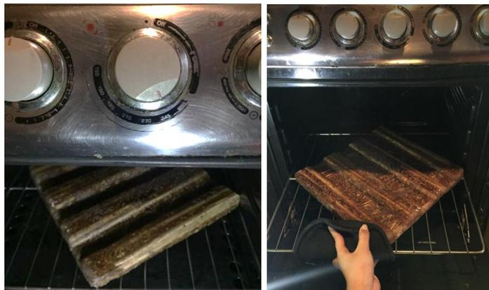
*Ilustración 56: Introducción del panel en horno a 245°C, posterior retiro
