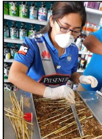
*Ilustración 46: Mezcla de los materiales al molde*
