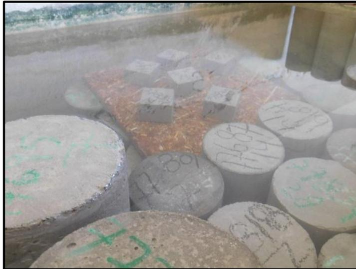
*Ilustración 51: Sumersión del prototipo en tanque de agua*
