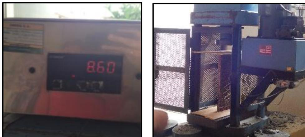
*Ilustración 49: Prueba de flexión*
