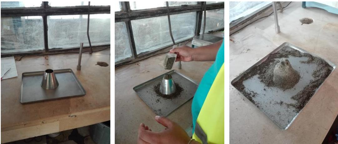
Figura 22. Análisis del material saturado superficialmente seco.
