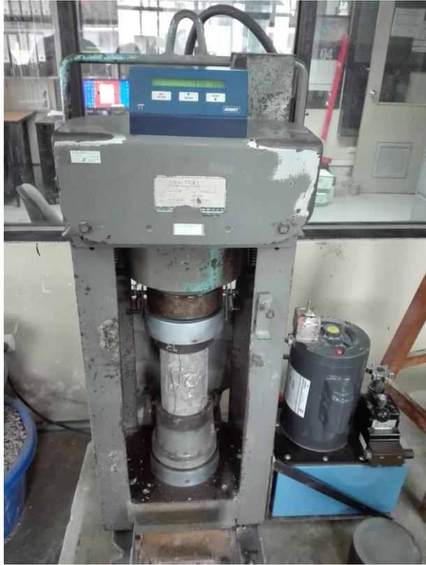
Fotografías 17. Roturas de cilindro
