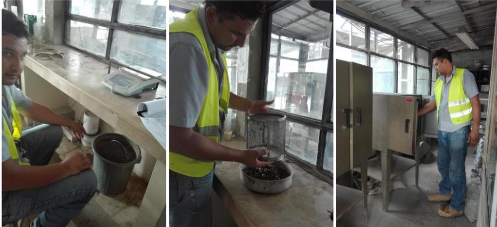
Figura 19. Procedimiento ensayo de gravedad específica y adsorción de agregados grueso
