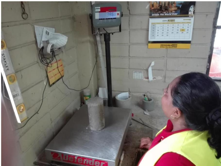
Fotografías 16. Proceso de peso de cada uno de los cilindros.
