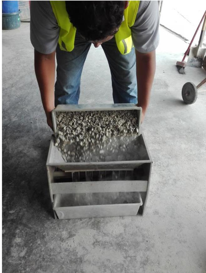
Figura 14. Introducción del material grueso en el bifurcador mecánico
