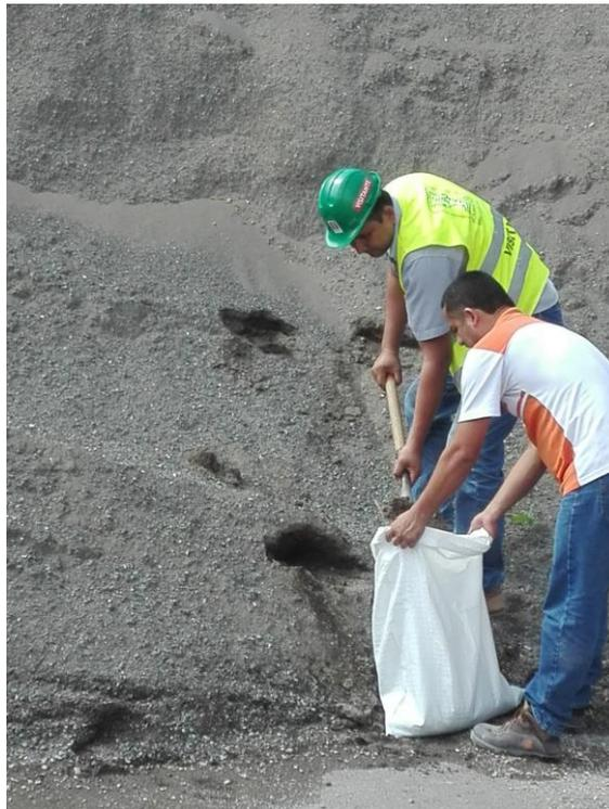
Figura 12. Recolección de Muestra de Agregado Fino
