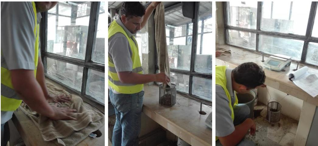
Figura 18. Procedimiento ensayo de gravedad específica y adsorción de agregados grueso
