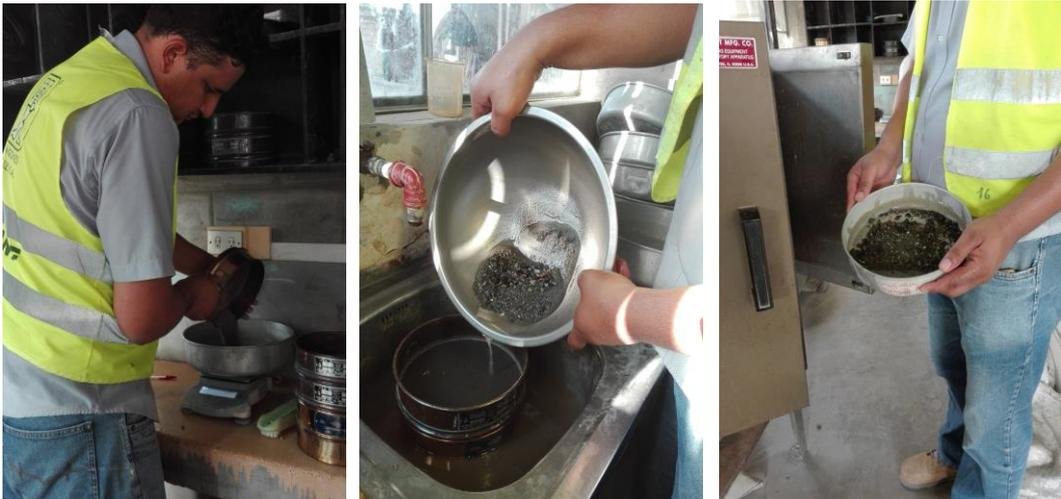
Figura 21. Análisis granulométrico y lavado de agregado fino
