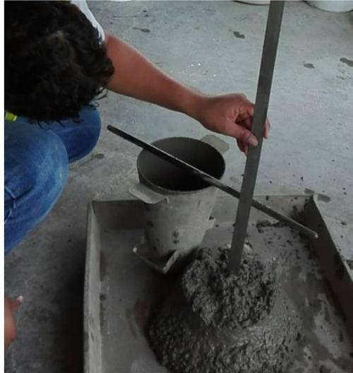
Figura 5. Ensayo de Asentamiento
