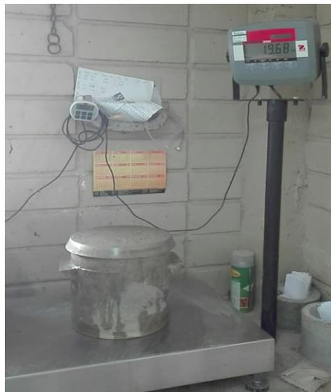
Figura 4. Determinación de la Densidad
