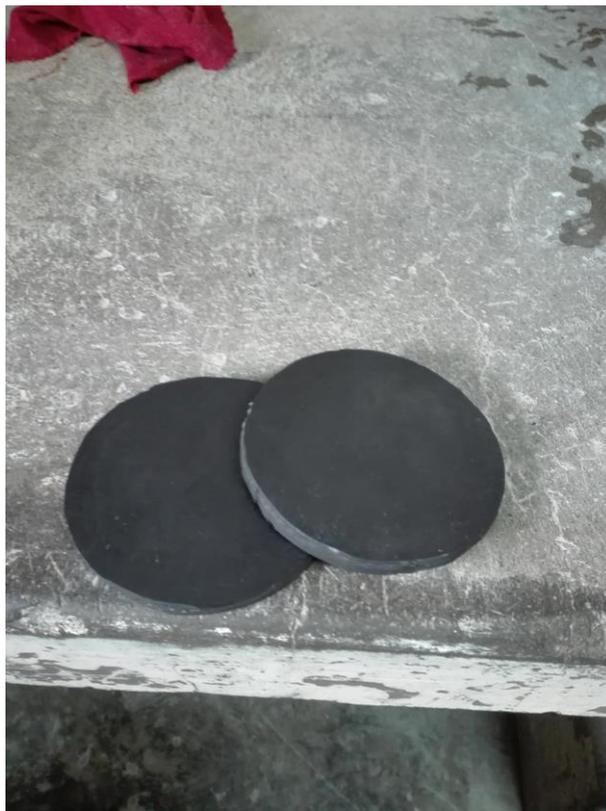
**Fotografías 14. Almohadillas de neopreno cortadas manualmente.**
