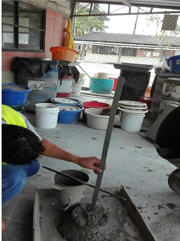
**Fotografías 3 Ensayo de asentamiento**
