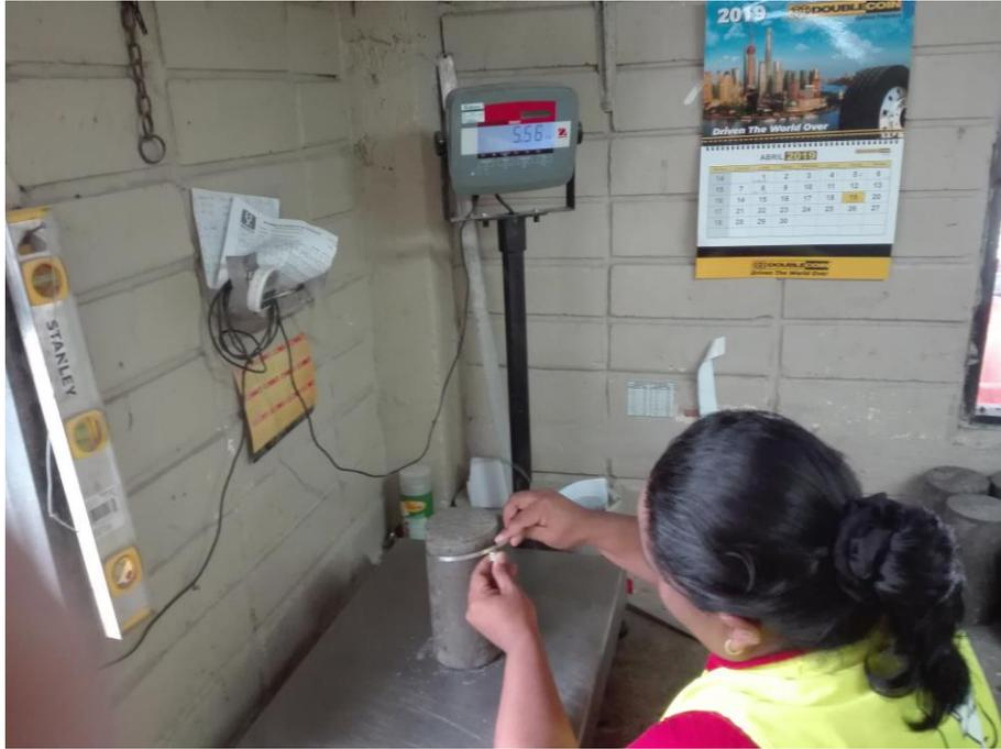
Fotografías 15. Medición de cada cilindro previo a la rotura
