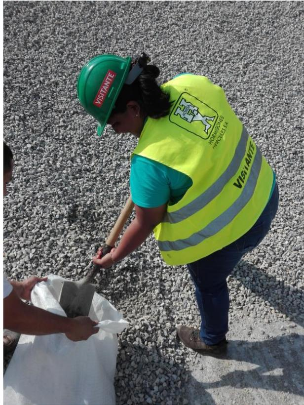
Figura 13. Recolección de la Muestra de Agregado Grueso
