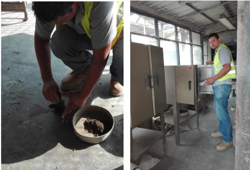
Figura 20. Cuarteo de la muestra previo al ensayo granulométrico
