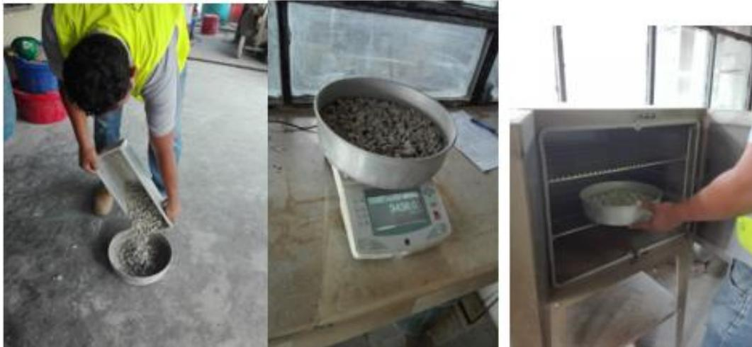
Figura 15. Procedimiento del ensayo granulométrico
