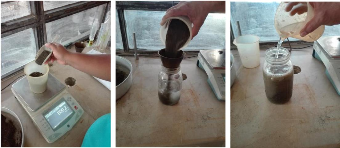
Figura 23. Determinación de la gravedad específica
