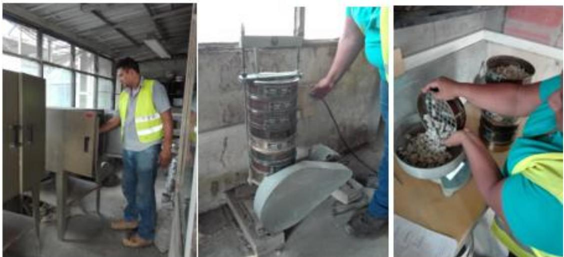
Figura 16. Procedimiento de ensayo granulométrico después de 24 horas
