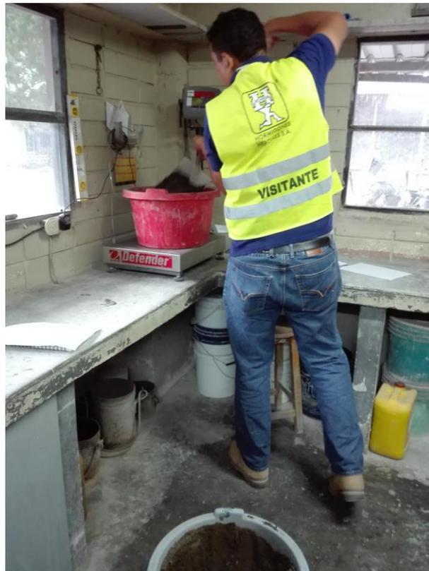
Fotografía 1. Pesando los materiales previos a realizar los cilindros
