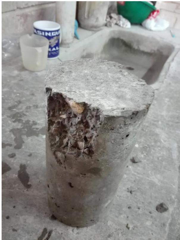
**Fotografías 20. Rotura tipo 5 - realizada con almohadillas de neopreno no certificadas.**
