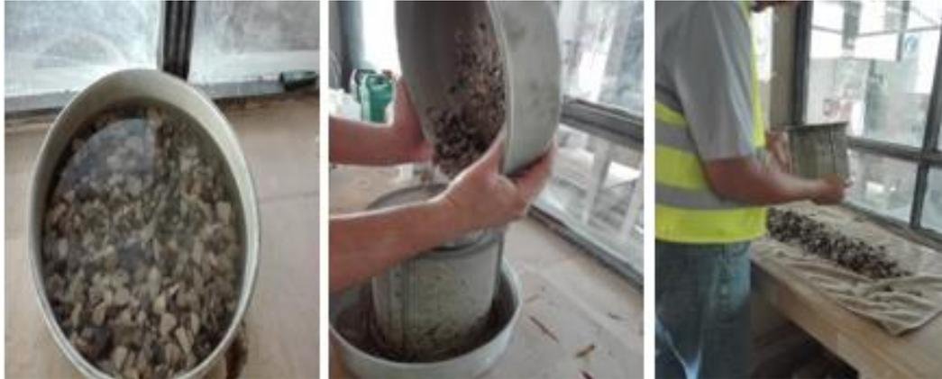
Figura 17. Procedimiento ensayo de gravedad específica y adsorción de agregados grueso
