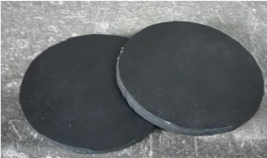
Figura 11. Neoprenos cortados a medida de la norma ASTM C1231
