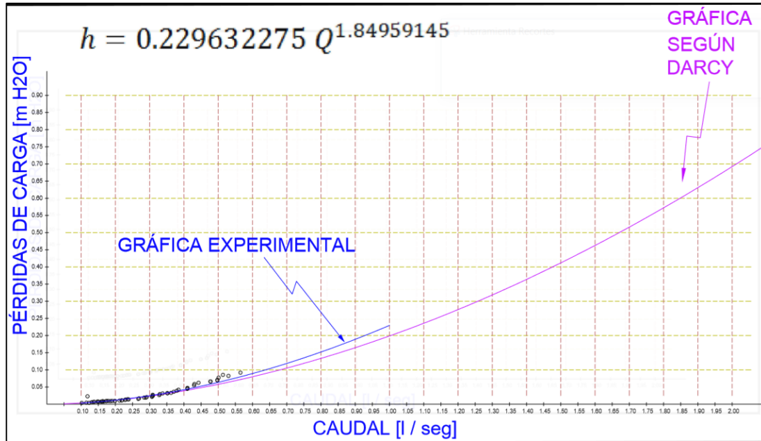
Gráfico 9: Experimental Vs Darcy VC de 25 mm. Elaborado por: Fuentes M., & Macías k. (2019)
