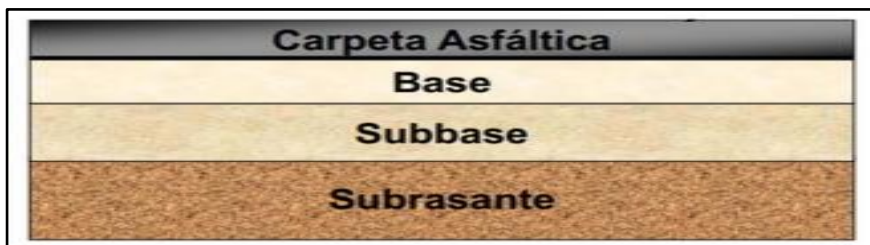
Figura 62: Estructura típica de pavimento flexible. Fuente: repository.udistrital.edu.com.
