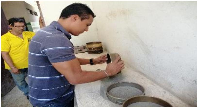
*Gráfico 25* Ensayo de granulometría de la arena.
