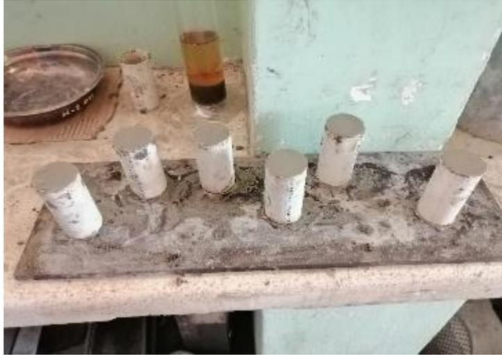
**Gráfico 30** Elaboración de cilindros de mortero para ensayos de compresión
