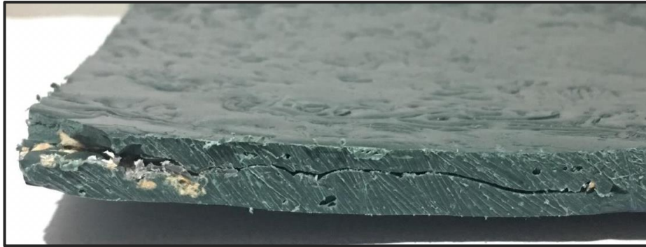
Figura 123: Grieta lateral - Experimento # 10. Elaborado por: Flores (2019)
