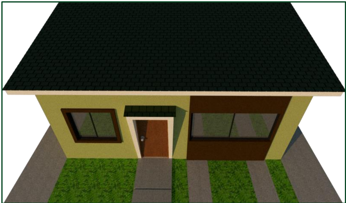
Figura 146: Render de cubierta Ppetbrik en vivienda de una sola planta. Elaborado por: Flores (2019)
