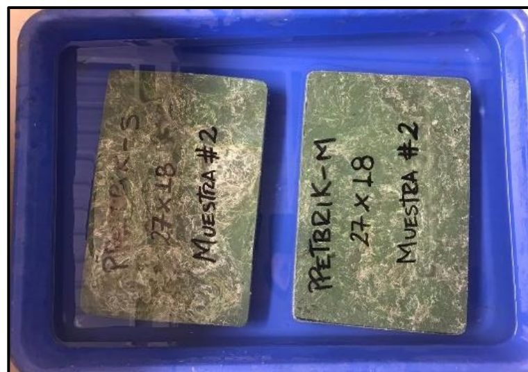
Figura 134: Ensayo de absorción de agua en placas Ppetbrik.
