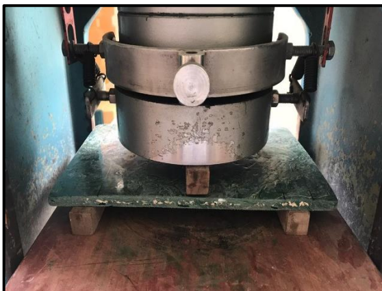
Figura 132: Ensayo de flexión en placa Ppetbrik-S. Elaborado por: Flores (2019)
