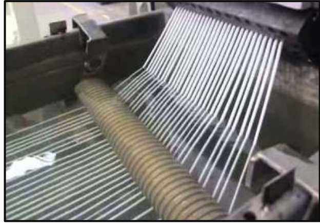
Figura 92: Plástico PET en forma de spaghetti enfriado en baño de agua. Fuente: Google (2019)
