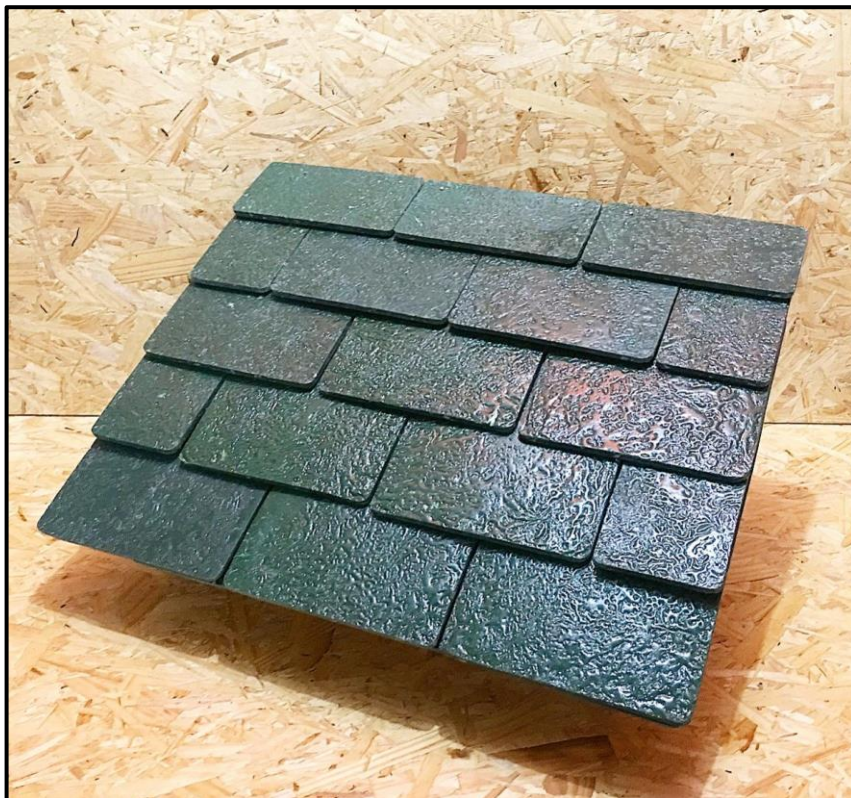
Figura 142: Cubierta Ppetbrik de 55 cm x 45 cm. Elaborado por: Flores (2019)
