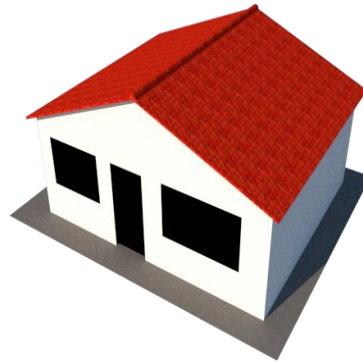
Figura 9: Cubierta a dos aguas. Elaborado por: Flores (2019)
