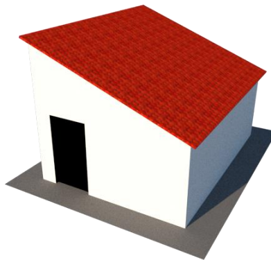
Figura 8: Cubierta a un agua. Elaborado por: Flores (2019)
