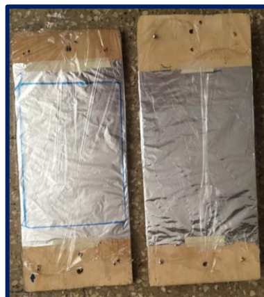
Figura 113: Prensa de pleibo forrada con papel aluminio y plástico de embalaje. Elaborado por: Flores (2019)
