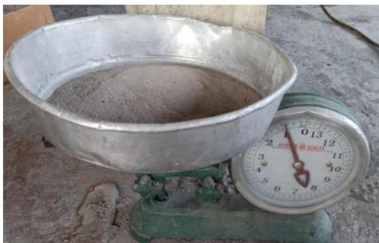
**Figura 39.** Ceniza de cascara de maní obtenida del proceso de incinerado, peso = 0.80 kg
