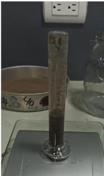
*Figura 21.* Probeta para ensayo de absorción de la ceniza de Cáscara de maní
