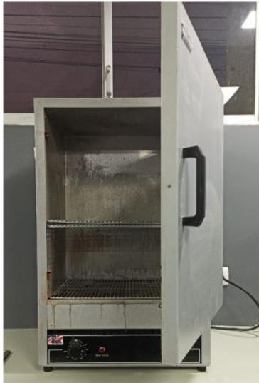
*Figura 20.* Horno ensayo de agregado fino laboratorio de suelos.
