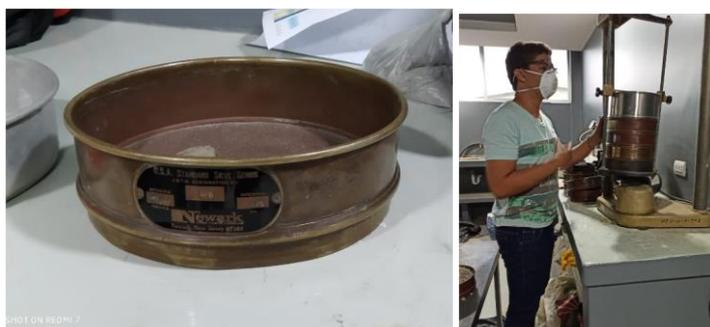
*Figura 17.* Tamiz usado en ensayo de agregado fino.
