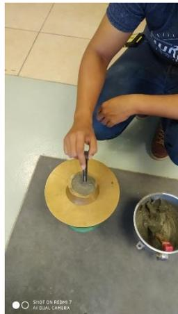
**Figura 45.** Proceso de ensayo fluidez cono lleno.
