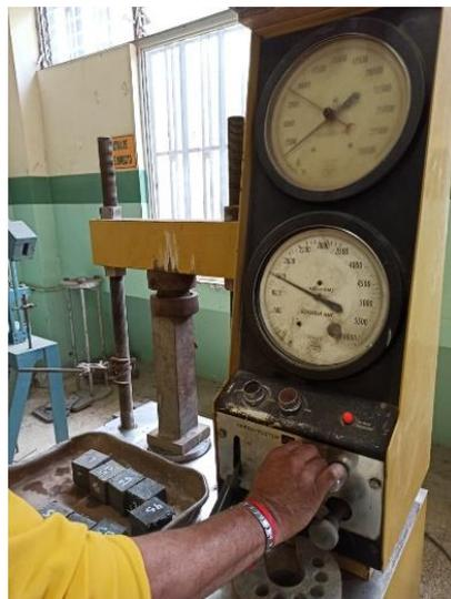
*Figura 29.* Maquina empleada para ensayo a compresión
