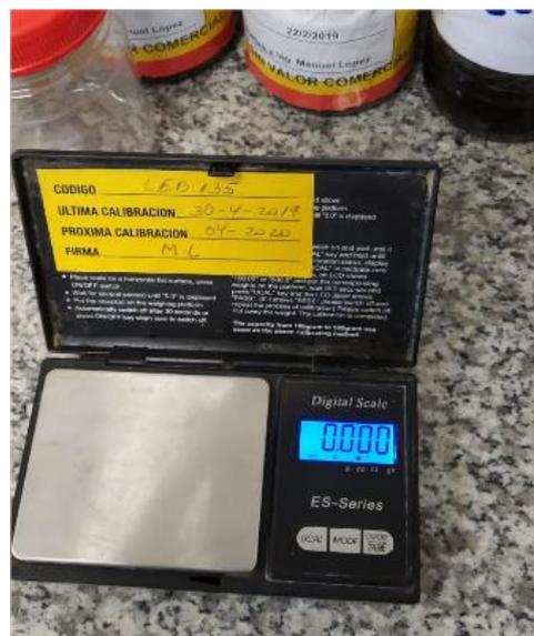
*Figura 19.* Balanza usada en ensayo de agregado fino y Ceniza de cáscara de maní.
