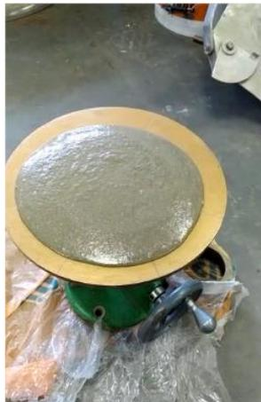
**Figura 47.** Proceso de ensayo fluidez mortero convencional.
