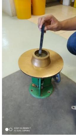
**Figura 44.** Proceso de ensayo fluidez capa 2.5cm.
