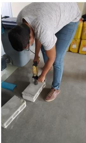
**Figura 55.** Corte superficial de enlucidos con mortero convencional y mortero a base de ceniza de cascara de maní 35% + fibra de polipropileno.
