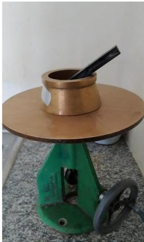
*Figura 42.* Mesa + Cono empleado en ensayo de Fluidéz.
