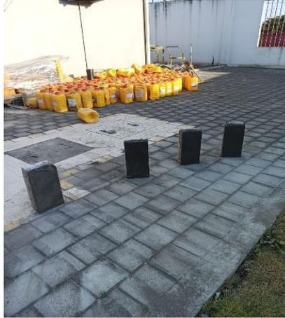
**Figura 53.** Bloques enlucidos con mortero convencional y mortero a base de ceniza de cascara de maní 35% + fibra de polipropileno.
