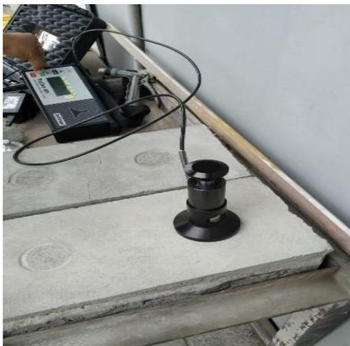
*Figura 59.* Proceso de arrancamiento por tracción perpendicular.
