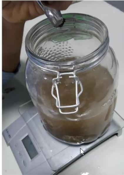
*Figura 28.* Agua añadida en el proceso de ensayo ASTM C128
