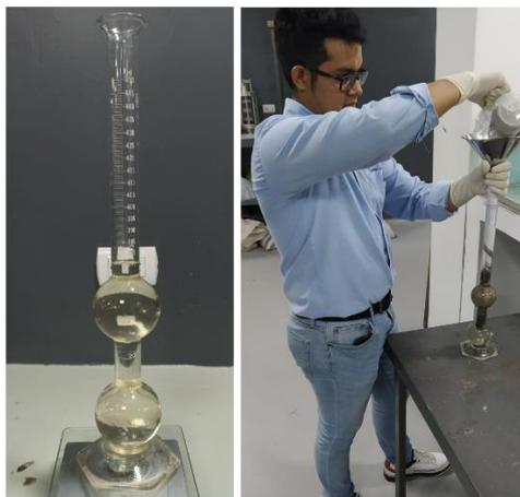
**Figura 25.** Matraz Le Chatelier con queroseno (375 ml) previo a verter la ceniza (64 gr).
