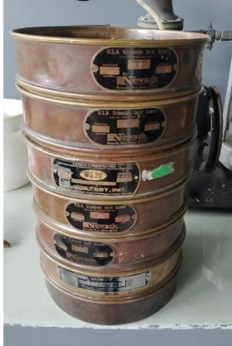
**Figura 33.** Tamices para módulo de finura del agregado fino.
