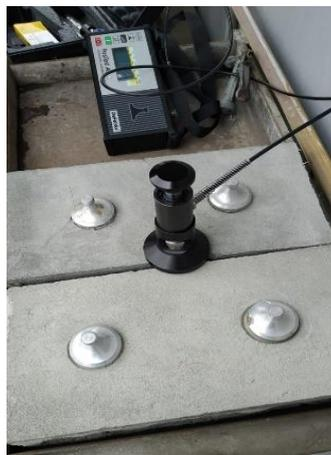
**Figura 58.** Equipo listo para ensayo de adherencia.
