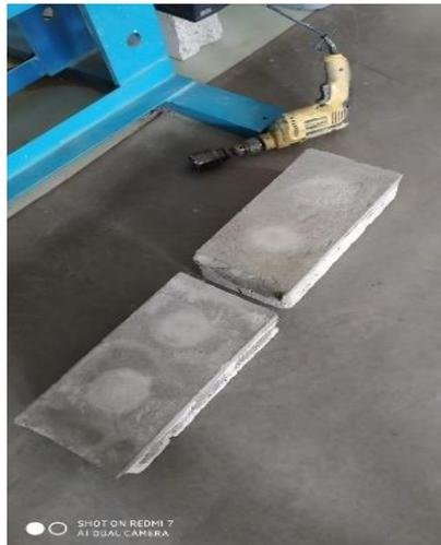
**Figura 54.** Limpieza de enlucidos con mortero convencional y mortero a base de ceniza de cascara de maní 35% + fibra de polipropileno.
