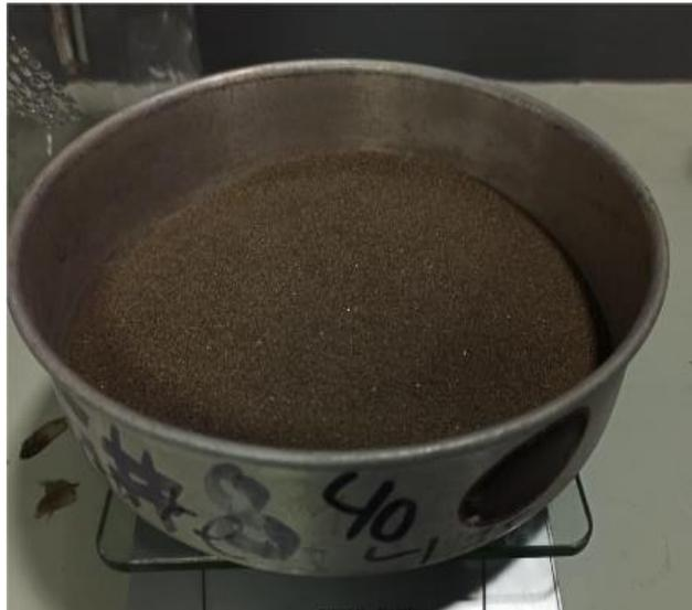
*Figura 27.* Agregado fino como producto final del tamiz 40. (502 gr)
