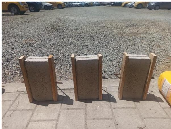
**Figura 51.** Proceso de ensayo adherencia.
