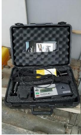
**Figura 50.** Equipo empleado en ensayo de adherencia
