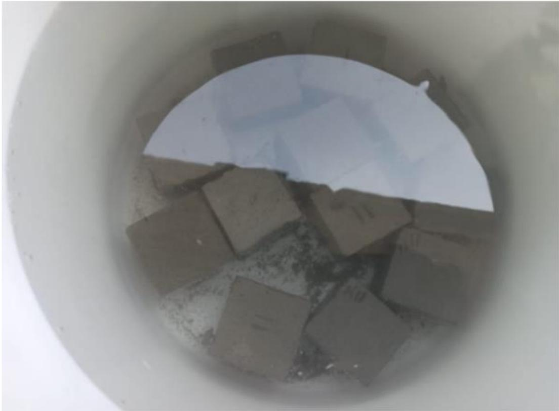
*Figura 41. Muestra de probetas sumergidas en agua para su correcto curado.
