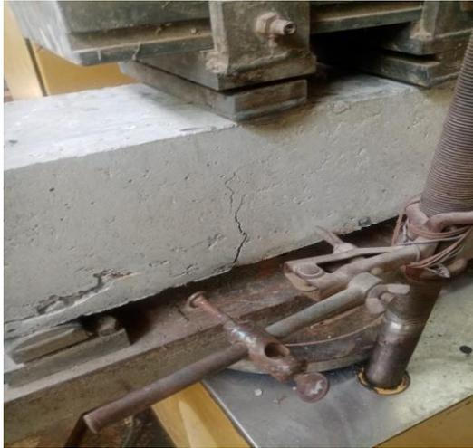
**Foto 5:** Ensayo de flexión.
