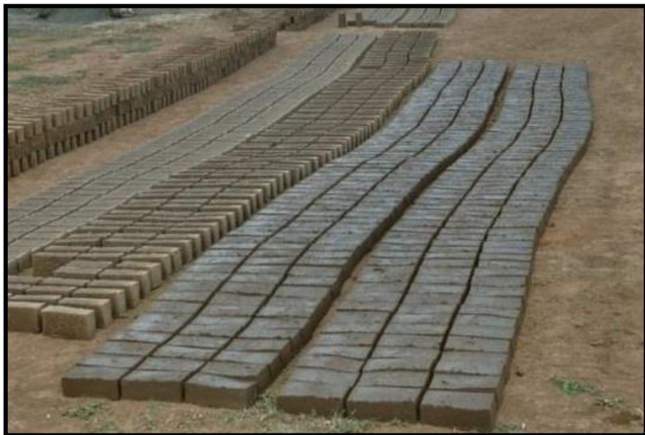
Figura 49. Secado de ladrillos al ambiente.. Fuente: researchgate.net Elaboración: Cedillo, N. (2019)
