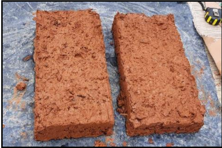
Figura 48. Desmolde de ladrillo. Elaboración: Cedillo, N. (2019)
