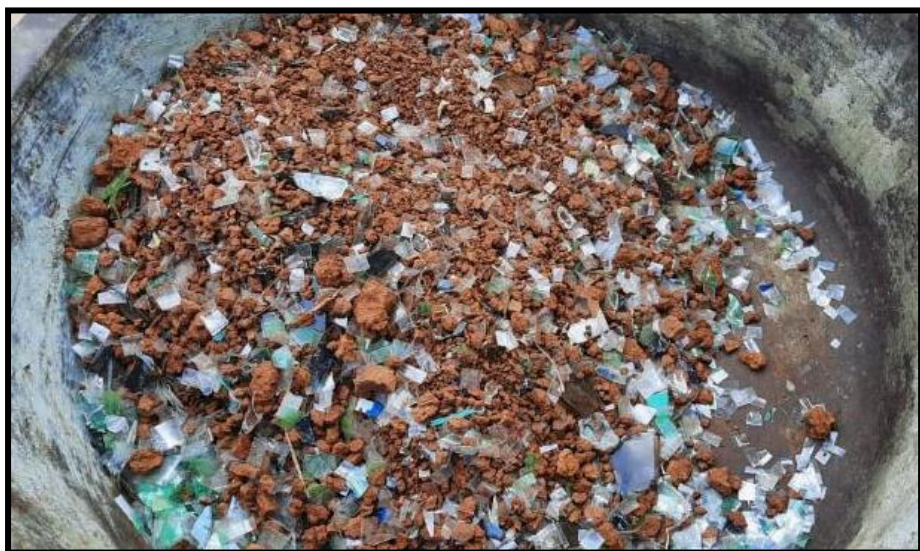
Figura 45. Mezcla de la masa para elaboración de ladrillo
