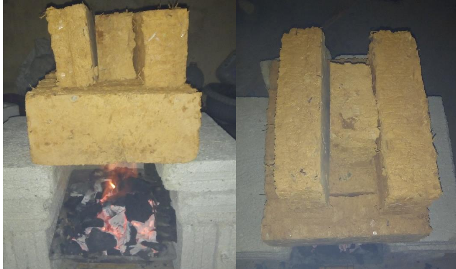
Figura 50. Horno artesanal para realizar las primeras y segundas pruebas.
