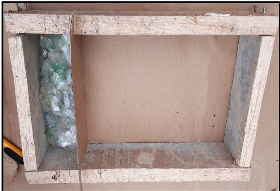
Figura 43. Dosificación de volumen de vidrio al 10%.
