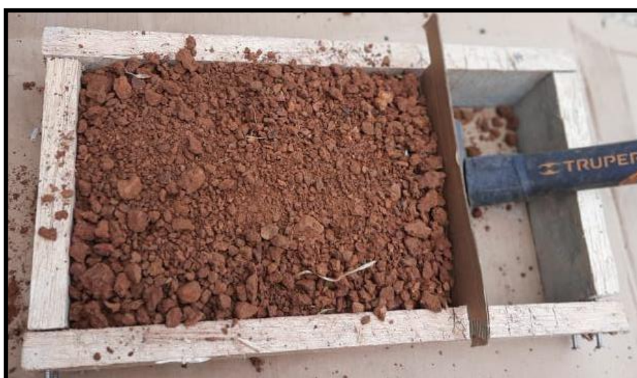
Figura 41. Dosificación de volumen de barro al 70%.
