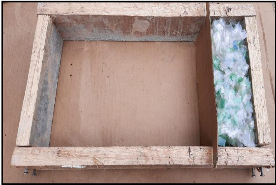
Figura 42. Dosificación de volumen de plástico al 20%.
