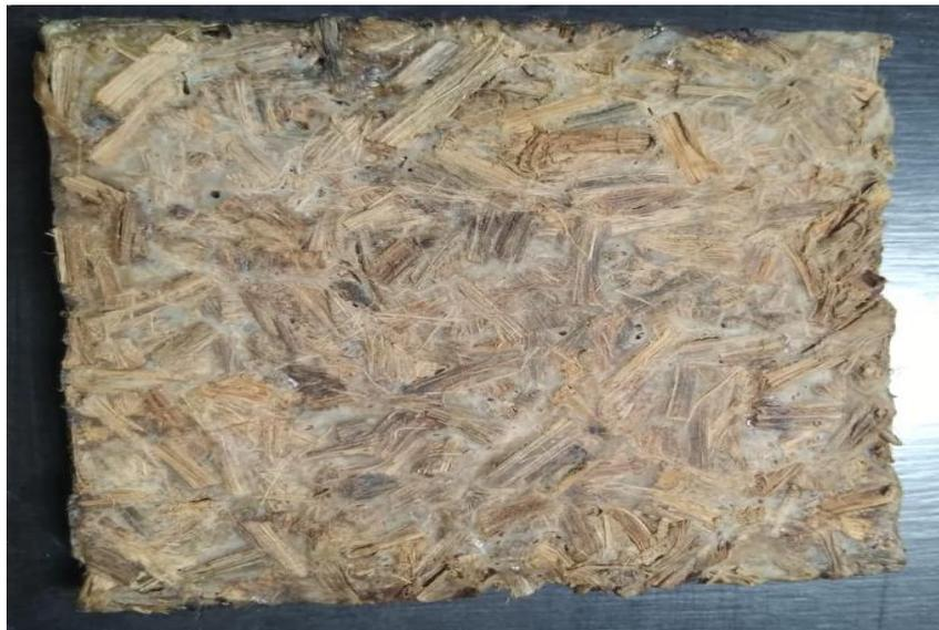
*Figura 49: Tablero M2 con fibra picada*
