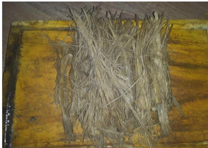
*Figura 36: Desfibrado de fibra con tenedor.*
