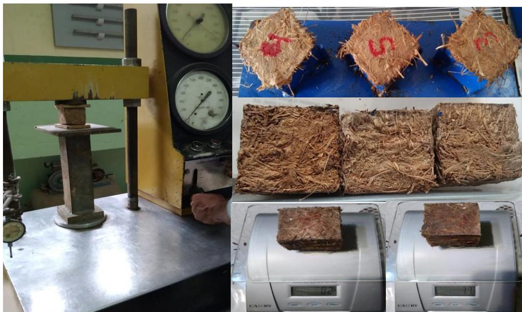
Figura 55: Proceso de elaboración de probetas y ensayo a compresión simple.
