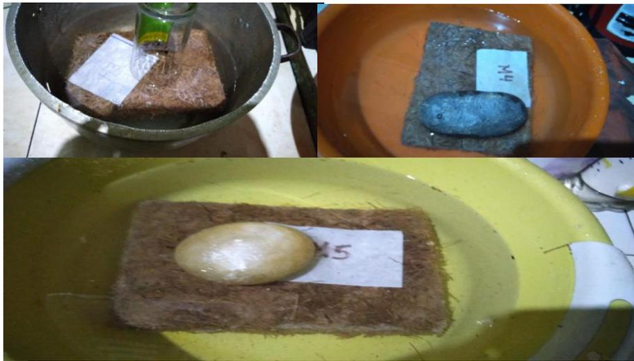
*Figura 57: Ensayo de absorción de agua.*
