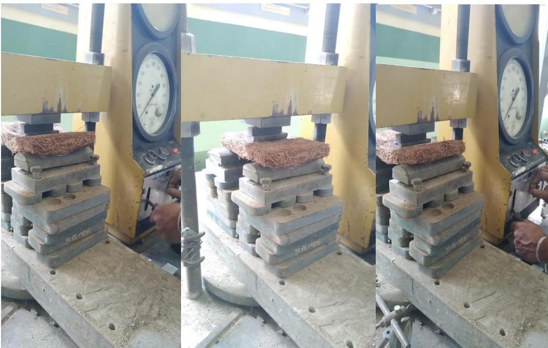
**Figura 56: Ensayo de flexión estática.**
