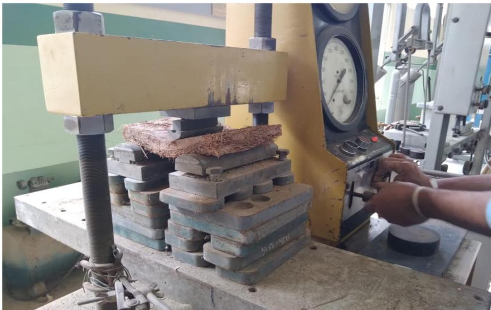
*Figura 16: Ensayo de flexión.*
