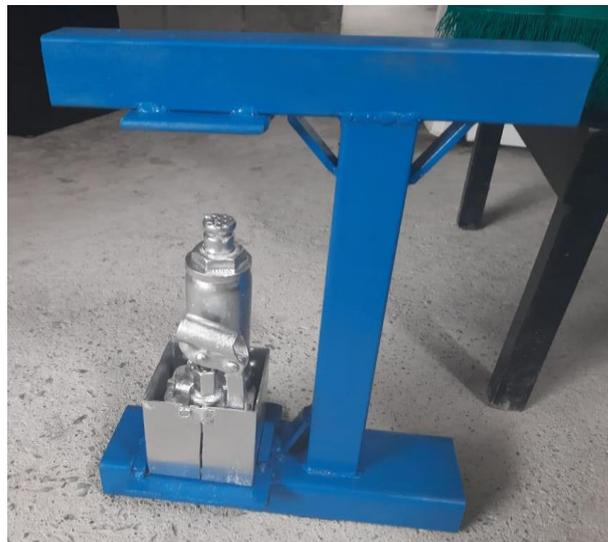
*Figura 19: Prototipo de prensa hidráulica con gata de 2 Ton.*
