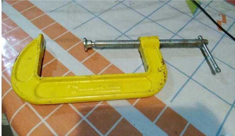
*Figura 22: Prensa tipo c*
