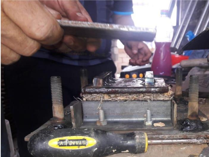
*Figura 41: Colocación de mezcla en molde para generar presión.*
