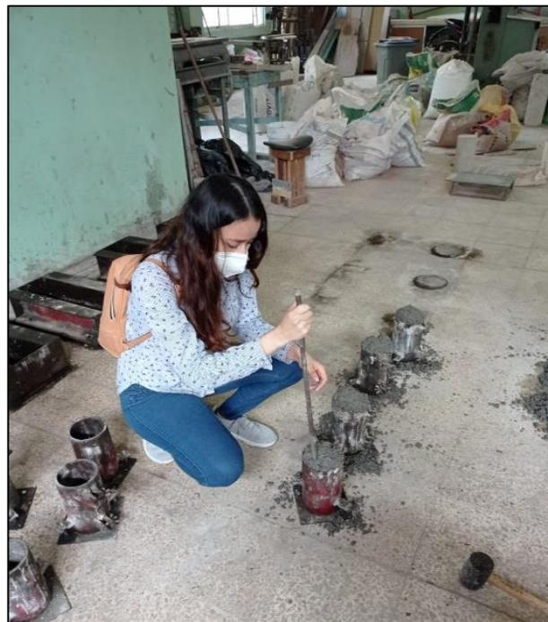
Figura 4. Preparación de los cilindros
