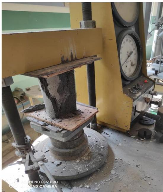
Figura 5. Roturas de cilindros
