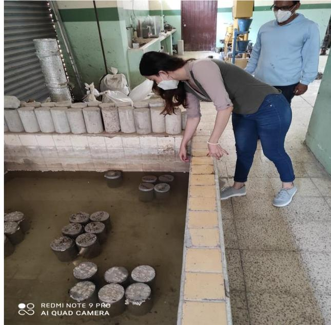
Figura 4. Curado de cilindros de hormigón
