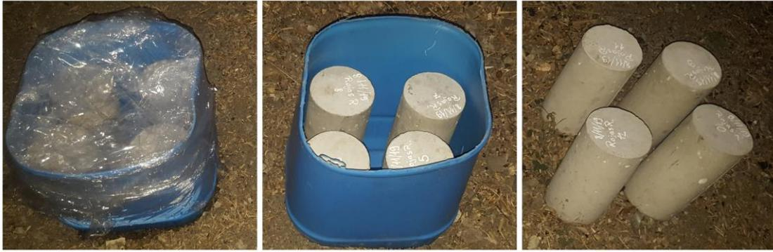
**Figura 55.** Probetas de hormigón al primer día tras fundición - noche
