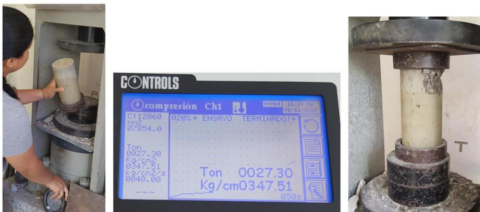
**Figura 87.** Rotura de probeta #14
