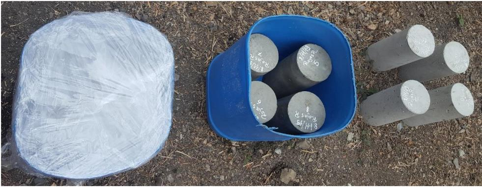
**Figura 58.** Probetas de hormigón al cuarto día tras fundición
