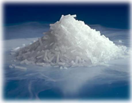
**Figura 8.** Hielo seco tipo pellets de 3 mm
