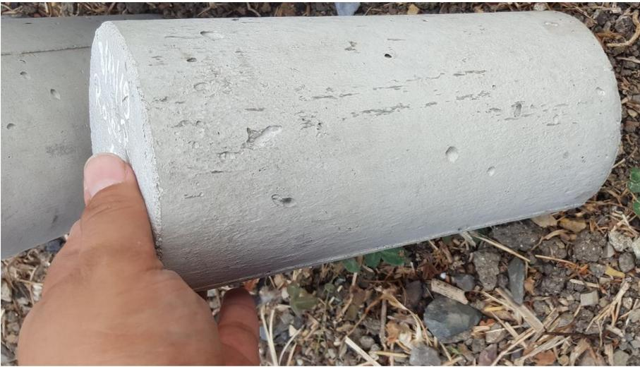
**Figura 64.** Probeta de hormigón 12
