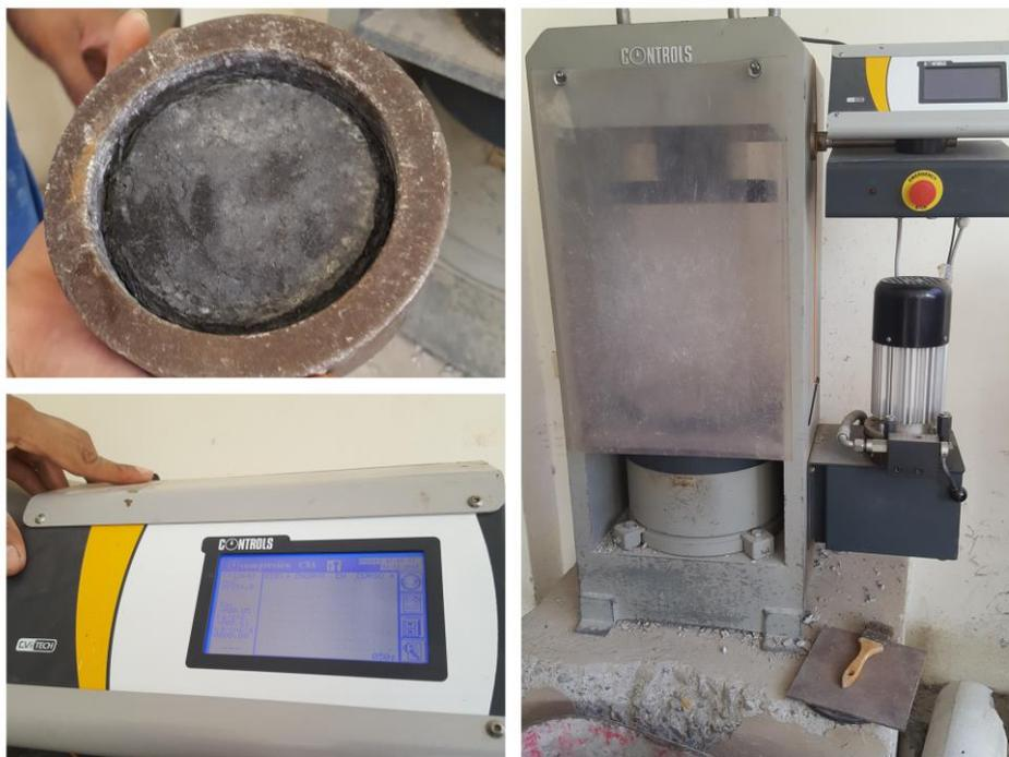
**Figura 76.** Máquina para pruebas de compresión
