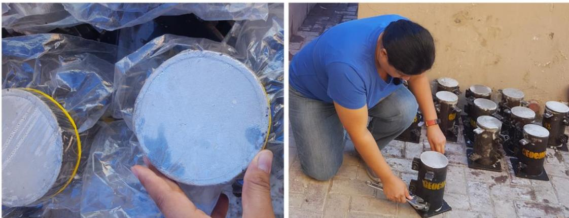
**Figura 49.** Desmolde de probetas
