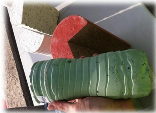
**Figura 16.** Muestra de hormigón auto compactable
