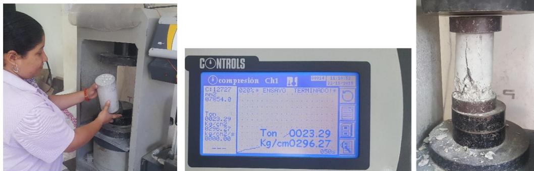
**Figura 81.** Rotura de probeta #2
