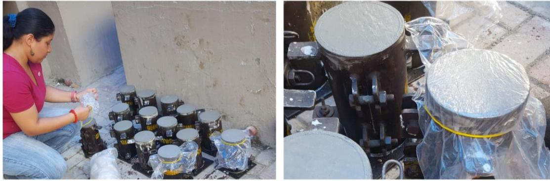
**Figura 48.** Curado inicial de probetas
