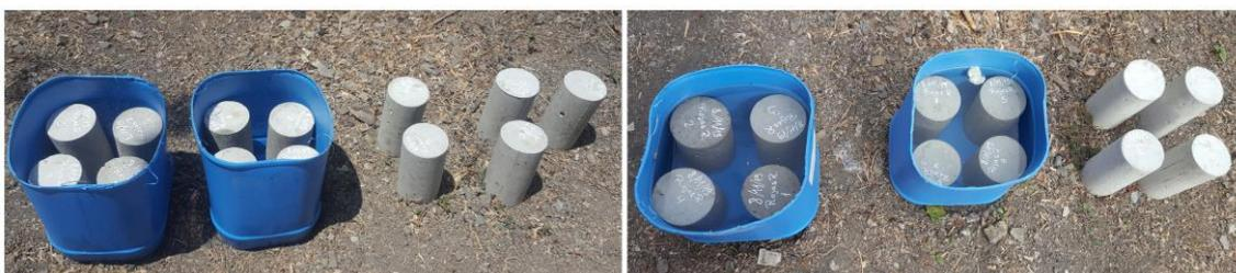
**Figura 52.** Probetas de hormigón previo a curado
