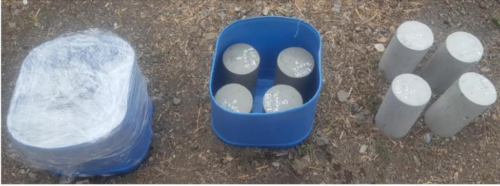
**Figura 60.** Probetas de hormigón al sexto día tras fundición
