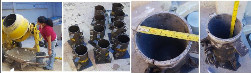
**Figura 39.** Preparación de herramientas para obtención de probetas
