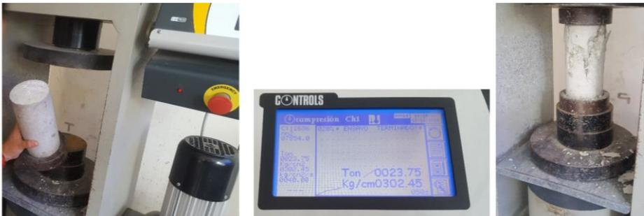
**Figura 78.** Rotura de probeta #5
