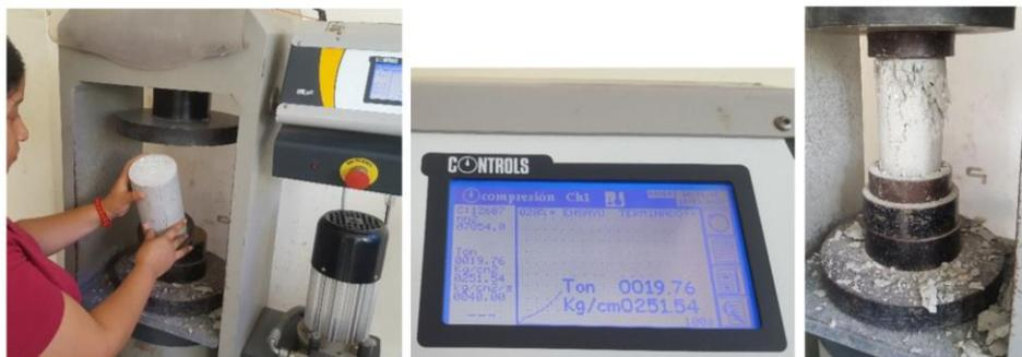
**Figura 79.** Rotura de probeta #9
