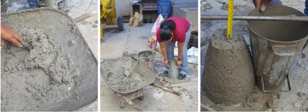
**Figura 44.** Ensayo de cono de Abrams
