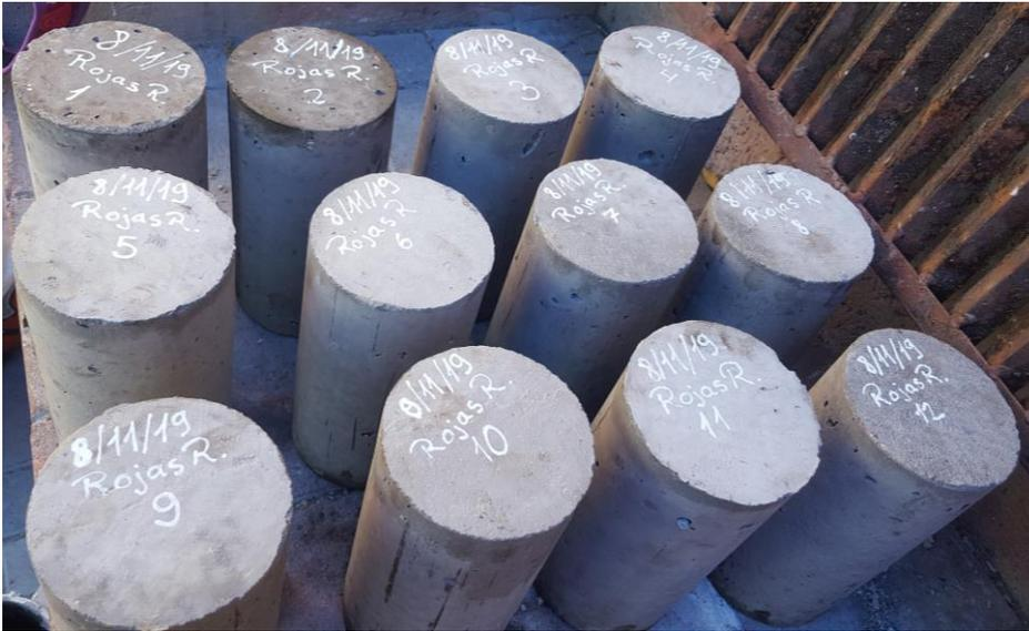
**Figura 50.** Probetas de hormigón desmoldadas
