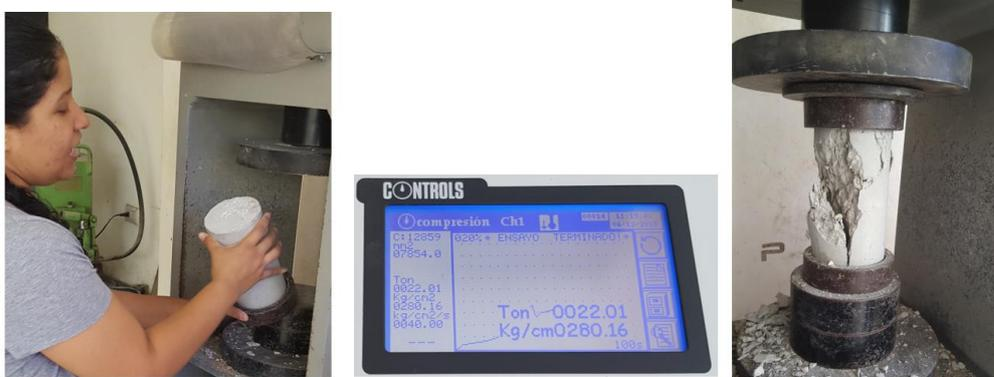
**Figura 86.** Rotura de probeta #11
