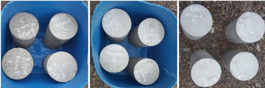
**Figura 56.** Probetas de hormigón al segundo día tras fundición
