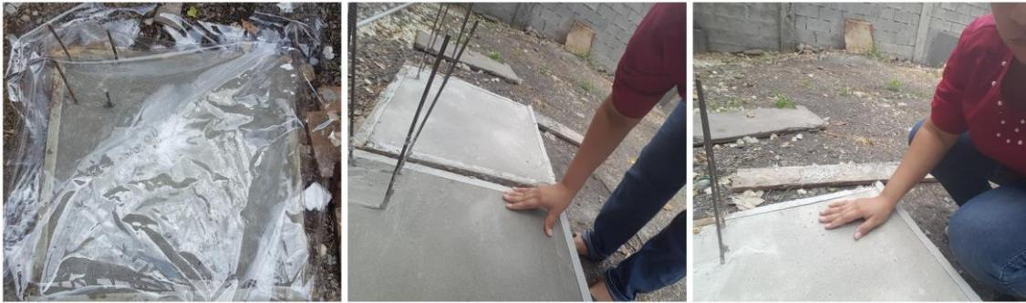
**Figura 74.** Segmentos de losa de hormigón al séptimo día tras fundición
