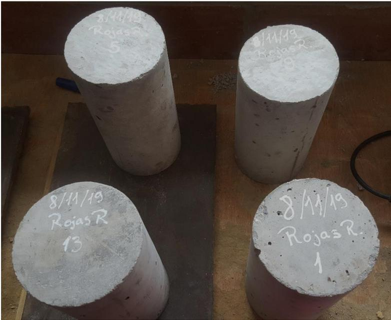
**Figura 75.** Probetas de hormigón en laboratorio para prueba tras siete días
