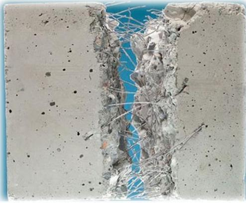
**Figura 17.** Muestra de hormigón con fibras
