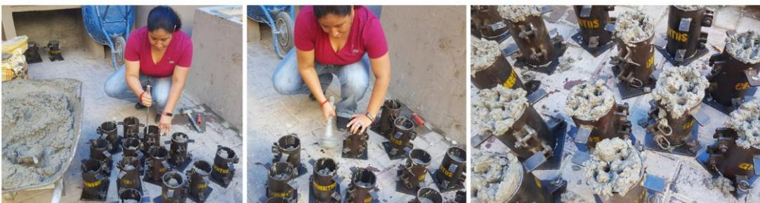
**Figura 45.** Relleno de probetas de hierro fundido
