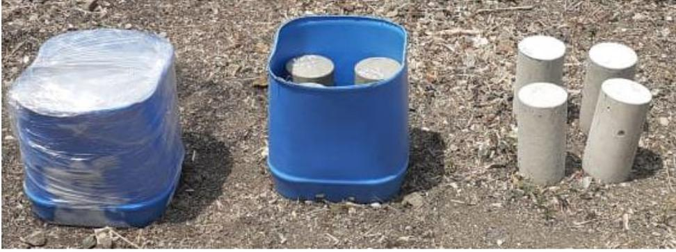
**Figura 57.** Probetas de hormigón al tercer día tras fundición
