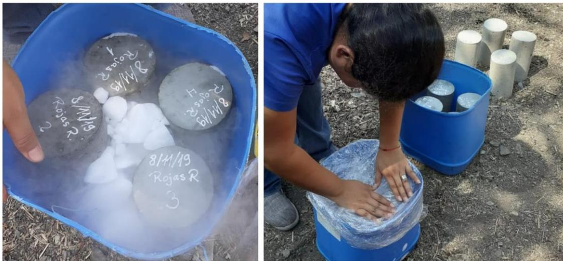
**Figura 54.** Probetas de hormigón al primer día tras fundición - día
