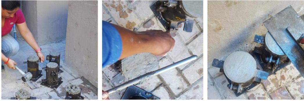
**Figura 46.** Acabado de probetas
