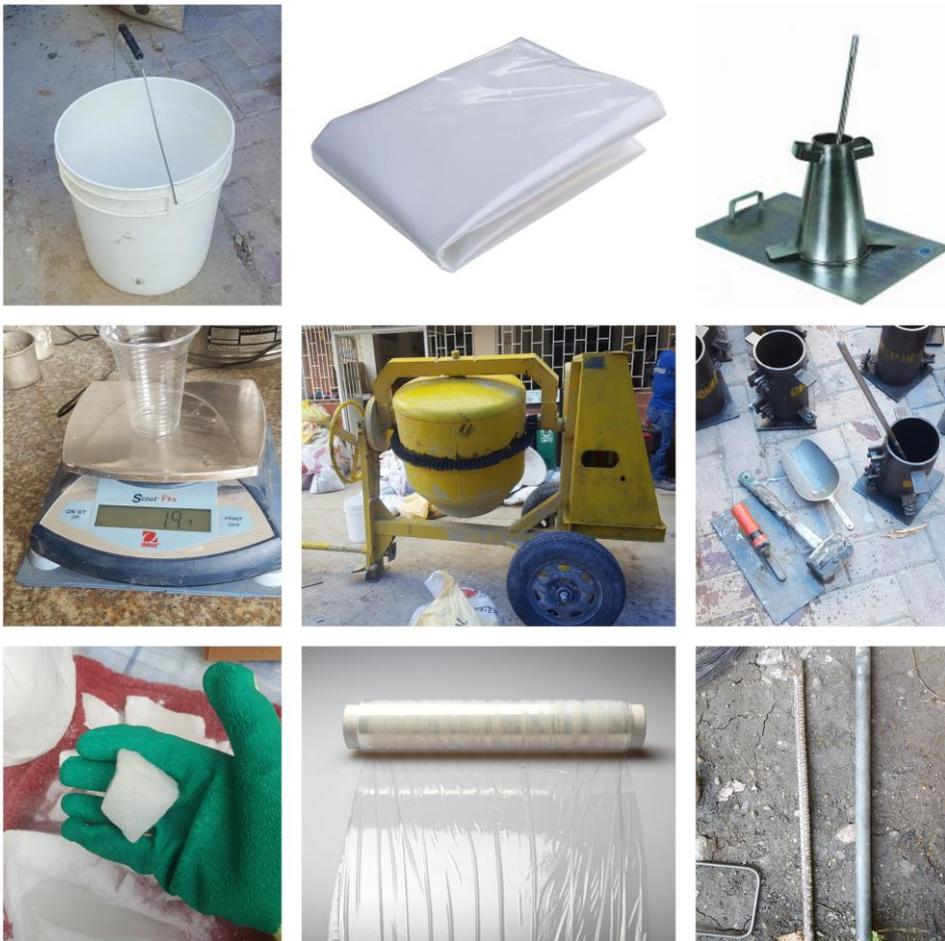
**Figura 38.** Herramientas para probetas y segmentos de losa
