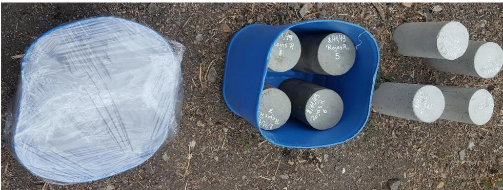
**Figura 59.** Probetas de hormigón al quinto día tras fundición
