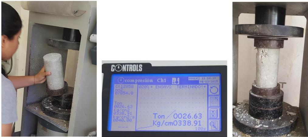
**Figura 85.** Rotura de probeta #7
