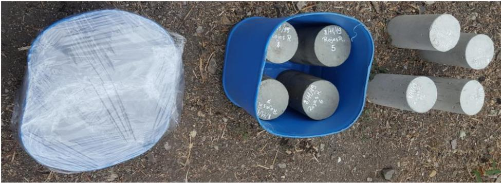
**Figura 61.** Probetas de hormigón al séptimo día tras fundición
