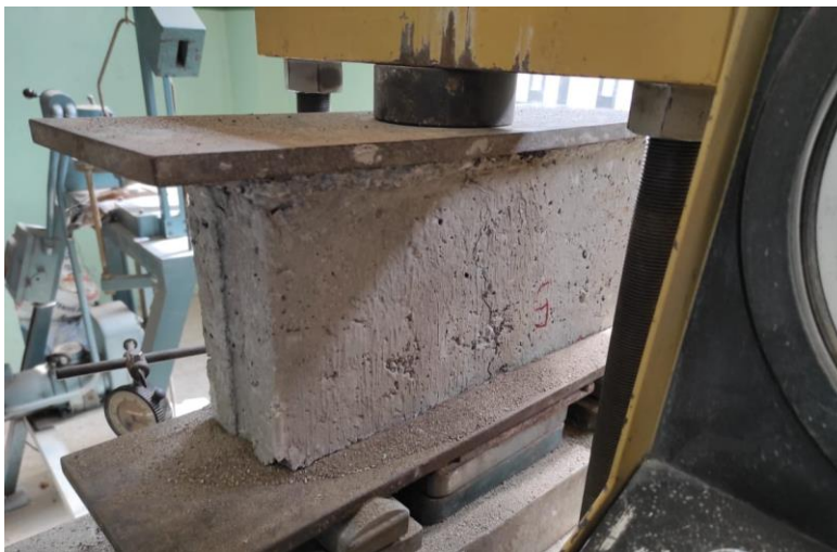
Figura 44: Bloque sometido a la compresión Fuente: Alvarado & Torres (2021)
