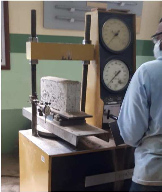
Figura 43: Bloque ubicado en la máquina de ensayo a la compresión Fuente: Alvarado & Torres (2021)
