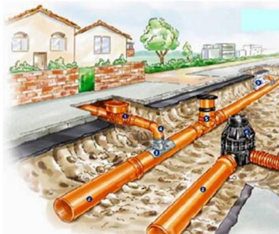
**Imagen 5.** Alcantarillado Semi- combinado
