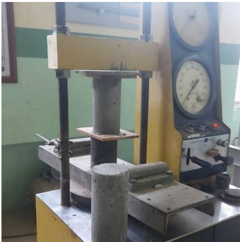
Figura 15 Ensayo a compresión del hormigón. Elaborado por: Cobos (2021)
