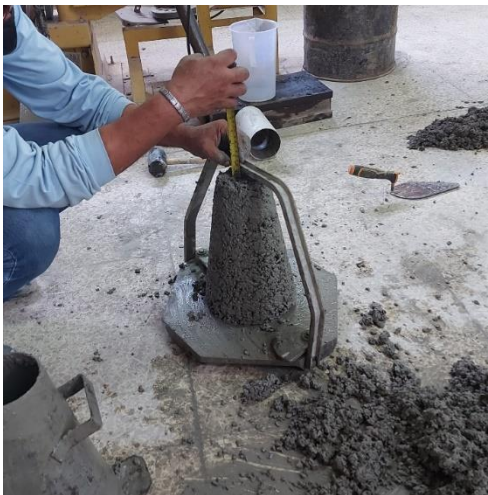
Figura 9 Ensayo de asentamiento del concreto.
