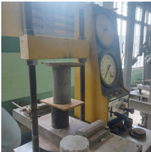
Figura 5 Prensa hidráulica utilizada para evaluar la resistencia a compresión del hormigón. Elaborado por: Cobos (2021)
