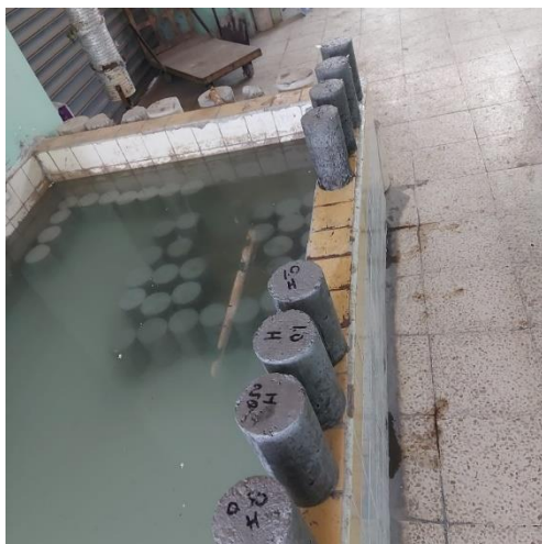
Figura 12 Curado de cilindros de hormigón. Elaborado por: Cobos (2021)
