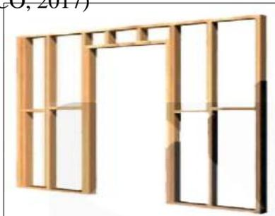
**Figura 48** Panel entramado de madera
