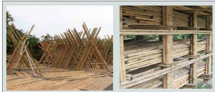
**Figura 39** Proceso de secado del Bambú en el Ecuador
