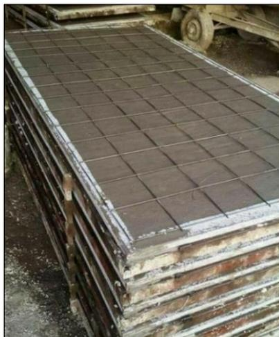
**Figura 32** Elaboración de las planchas de Fibrocemento
