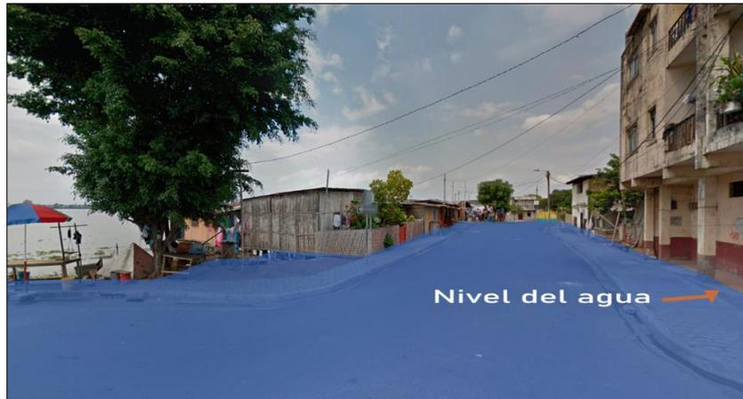
**Figura 94** Nivel del agua que alcanza durante una inundación en la ribera del río Babahoyo
