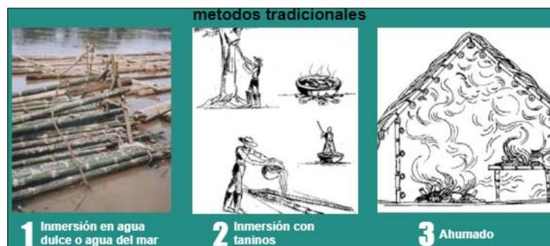
**Figura 38** Proceso de secado del Bambú en el Ecuador
