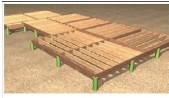
**Figura 47** Estructura de vigueta y pisos
