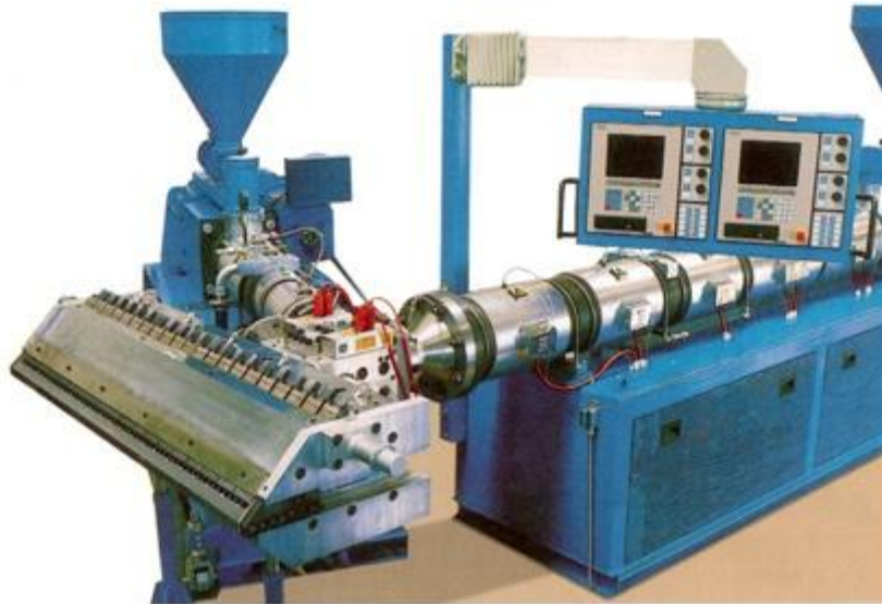
Ilustración 3: Máquina Extrusora Simple (Interplan S. A.)
