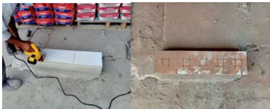
Figura 45. Corte de áreas de 25cm 2 Elaborado por: (Granoble Garcia & Tarira Santander, 2020)
