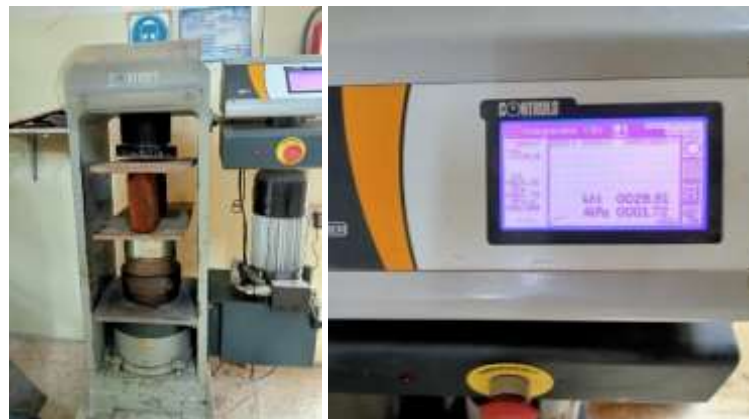
Figura 34. Resultado a compresión Elaborado por: (Granoble Garcia & Tarira Santander, 2020)
