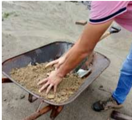
Figura 24. Mezcla de arcilla y aserrín Elaborado por: (Granoble Garcia & Tarira Santander, 2020)
