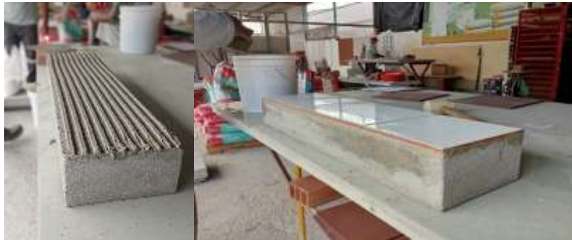
Figura 44. Pegado de cerámica para obtener superficie lisa Elaborado por: (Granoble Garcia & Tarira Santander, 2020)
