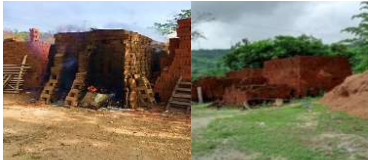
Figura 29. Cocción de ladrillos Elaborado por: (Granoble Garcia & Tarira Santander, 2020)
