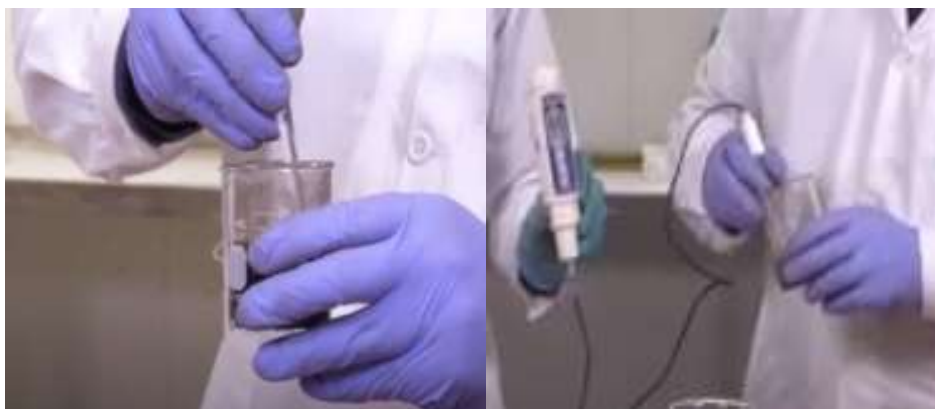
Figura 18. Mezclado de lodo para saber el pH Elaborado por: (Granoble Garcia & Tarira Santander, 2020)
