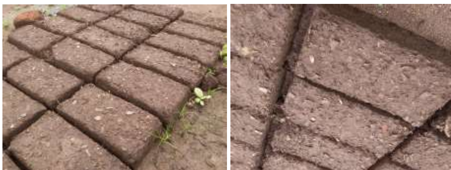
Figura 28. Secado al aire libre durante 15 días Elaborado por: (Granoble Garcia & Tarira Santander, 2020)
