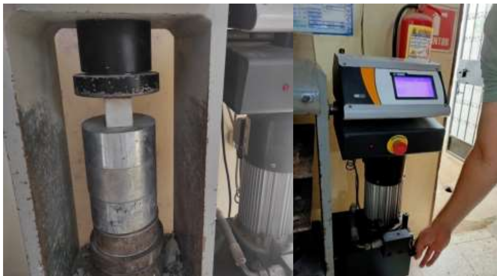
Figura 41. Ensayo a compresión de mortero Elaborado por: (Granoble Garcia & Tarira Santander, 2020)
