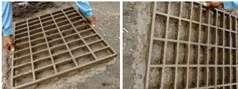
Figura 27. Desmoldado Elaborado por: (Granoble Garcia & Tarira Santander, 2020)
