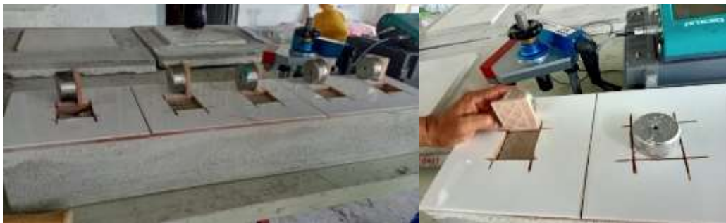
Figura 47. Extracción de disco Elaborado por: (Granoble Garcia & Tarira Santander, 2020)
