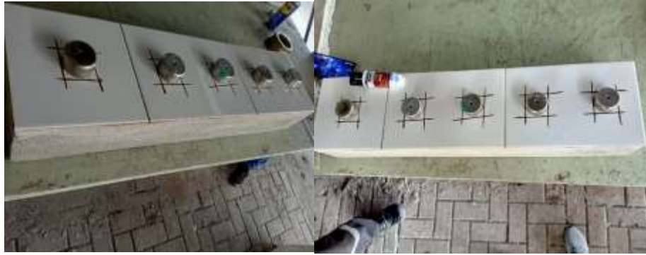
Figura 46. Pegado de disco de extracción Elaborado por: (Granoble Garcia & Tarira Santander, 2020)
