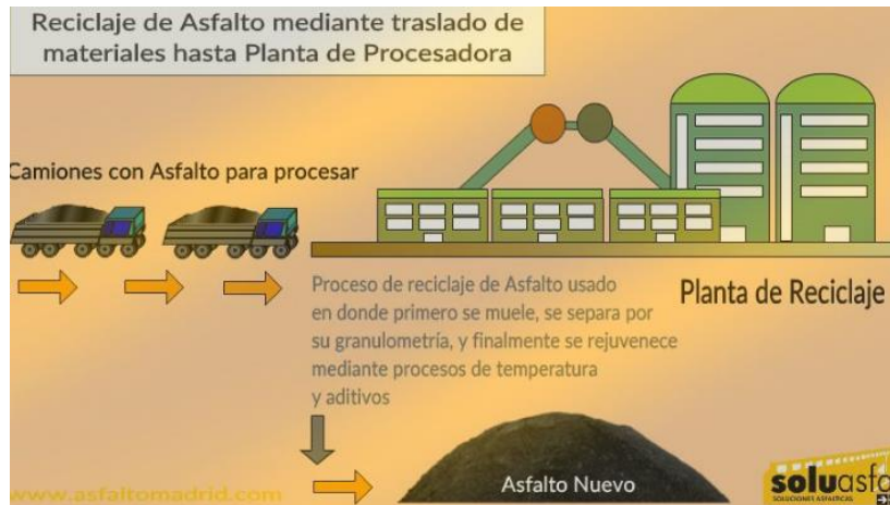
Figura 9: Reciclado de material en planta
