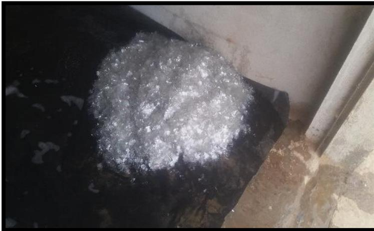
*Figura 39.* Plástico pet1 triturado 0.01m x 0.01m.
