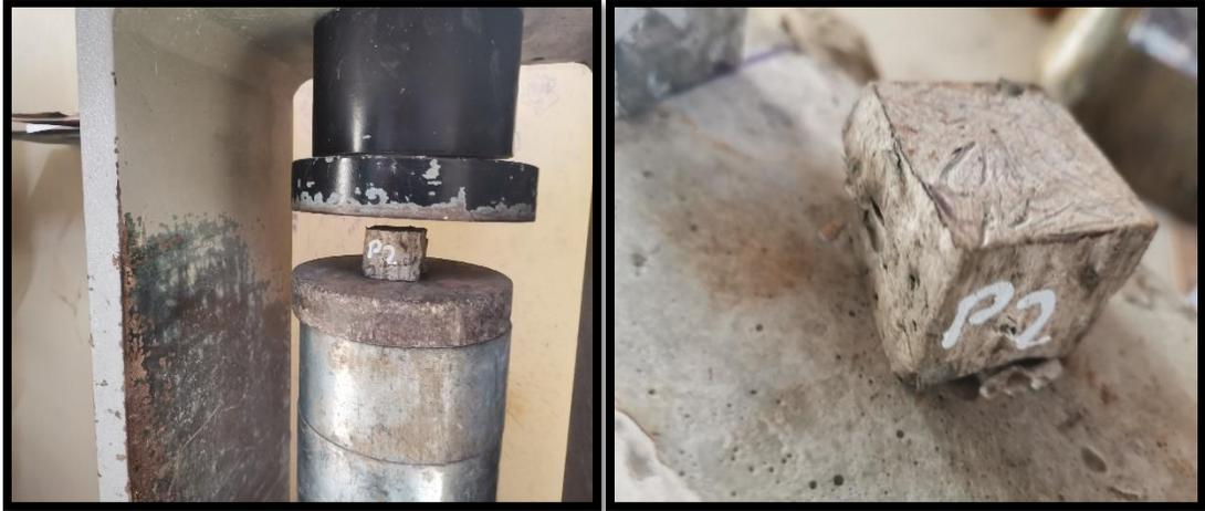
**Figura 61.** Visualización de rotura a los 28 días probeta 2
