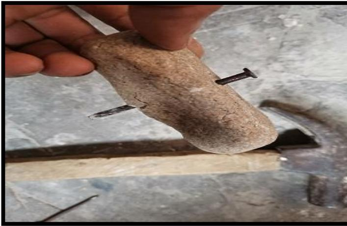
*Figura 82.* Clavada de clavo, probeta
