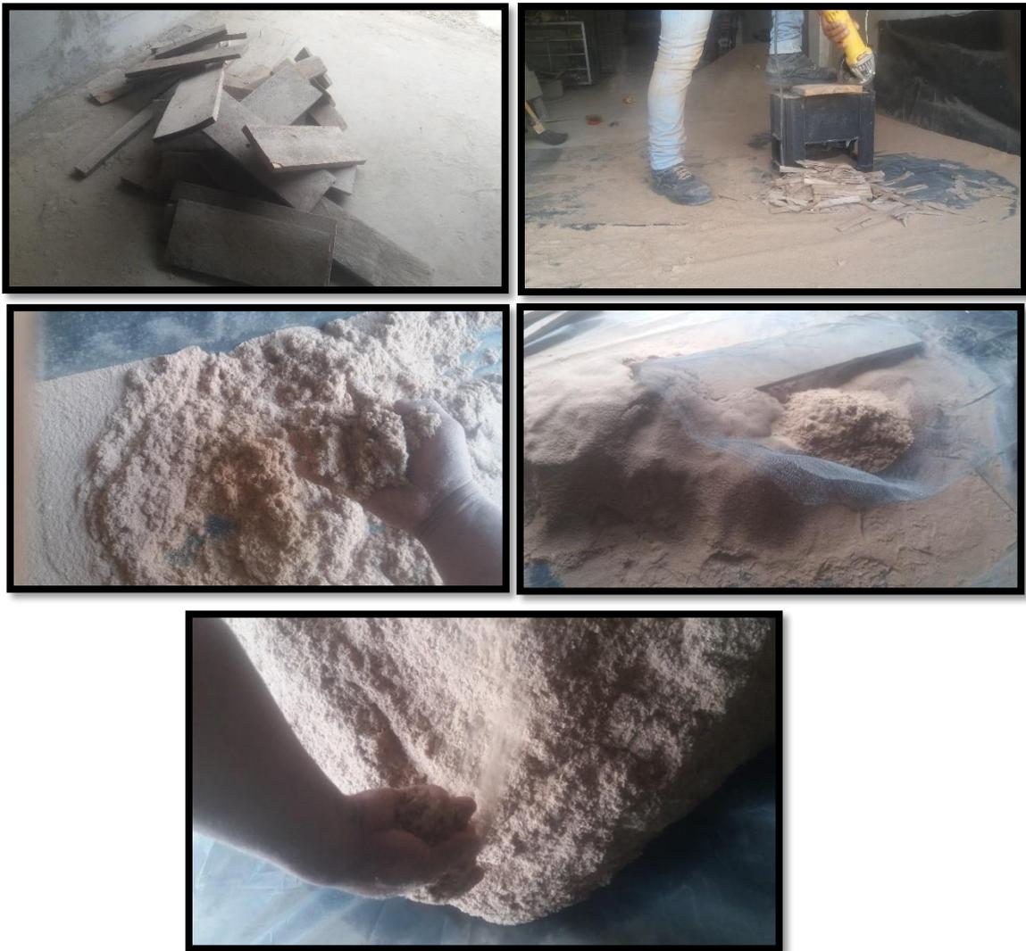
*Figura 43.* Obtención del aserrín
