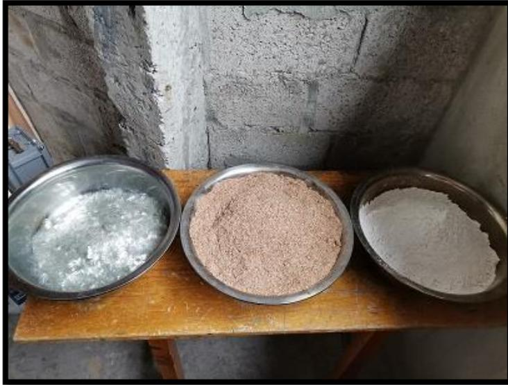
**Figura 50.** Visualización de proporciones, plástico, aserrín y yeso
