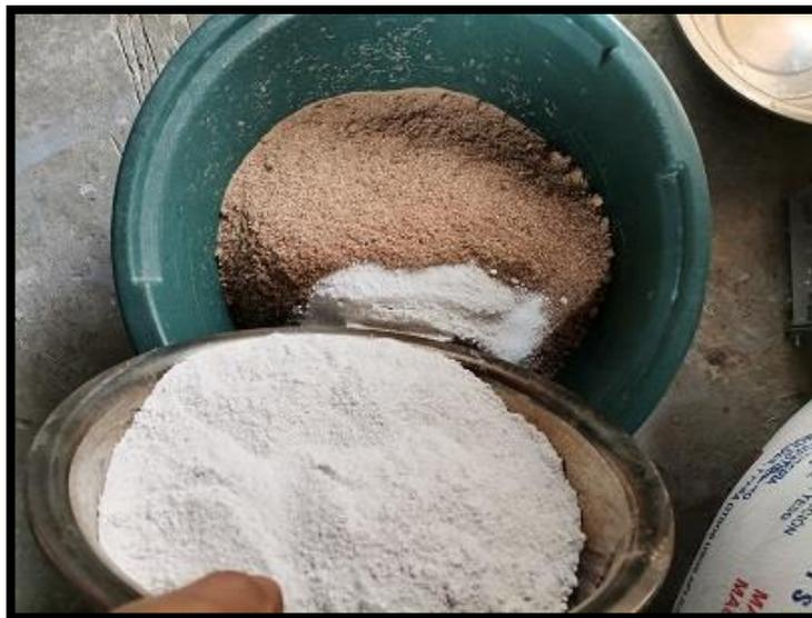
**Figura 51.** Mezcla en seco proporción aserrín-yeso
