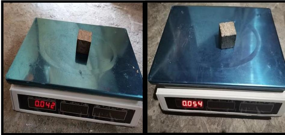
*Figura 70.* Peso antes y después de sumergido al agua, probeta 2
