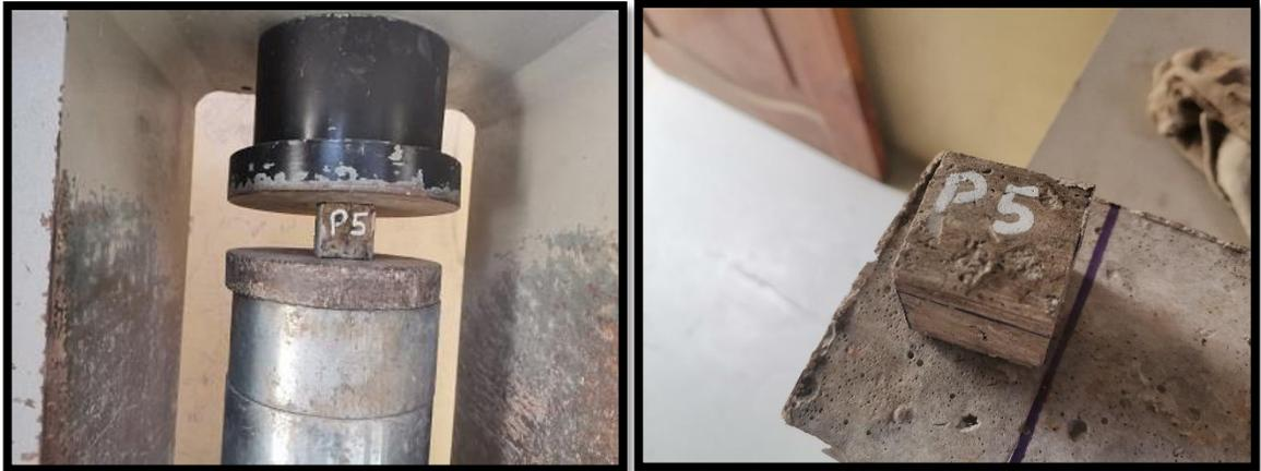
**Figura 65.** Visualización de rotura a los 28 días, Probeta 5
