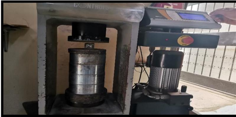
*Figura 60.* Equipos de ensayos compresion y flexión
