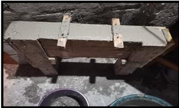
**Figura 88.** Viga de hormigón armado 0.07 x 0.18 x 0.65 m.
