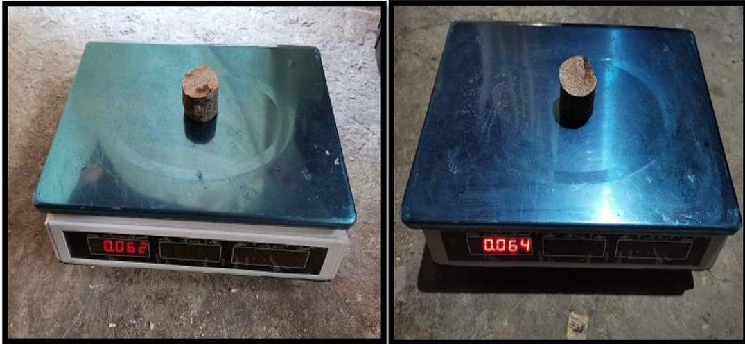
*Figura 72.* Peso antes y después de sumergido al agua, probeta 5
