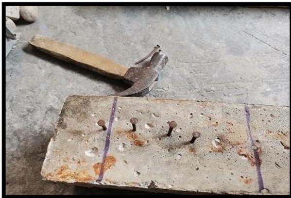
**Figura 81.** Clavada de clavos, prototipo
