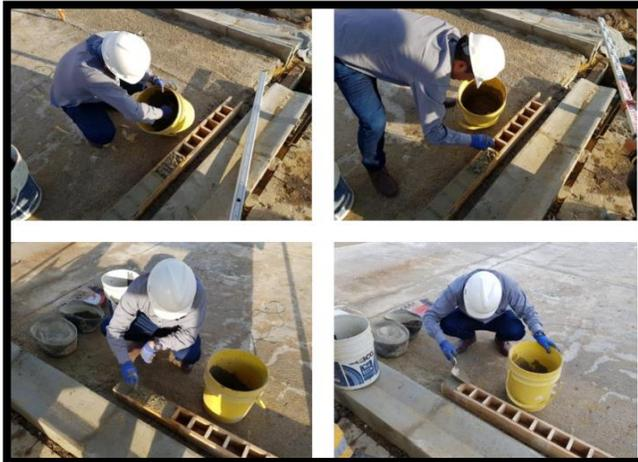
**Figura 4.** Probetas de hormigón adicionados con PET1
