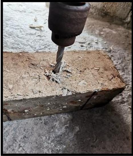
**Figura 80.** Perforación (método taladro)
