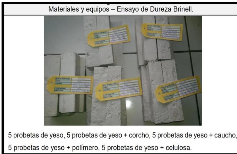
**Figura 1.** Probetas de yeso adicionados con corcho, caucho, polímero y celulosa
