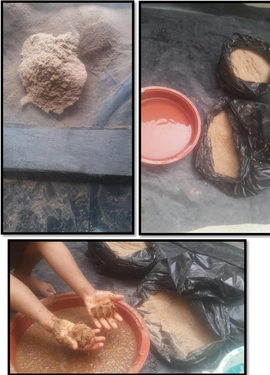
*Figura 44.* Limpieza y lavado del aserrín
