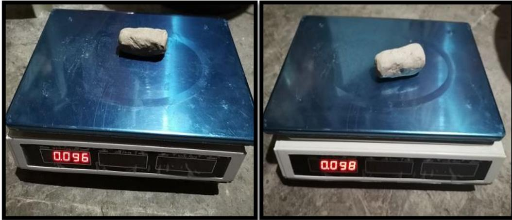
*Figura 71.* Peso antes y después de sumergido al agua, probeta 4
