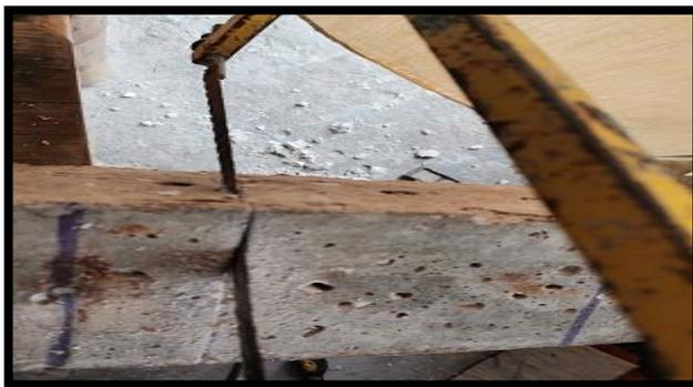
*Figura 83.* Corte del prototipo con sierra manual
