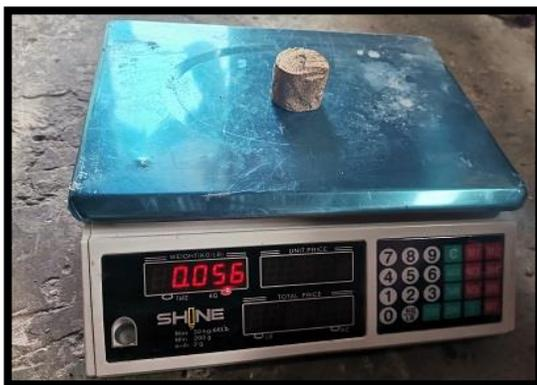
*Figura 76. Peso seco al horno probeta 5
