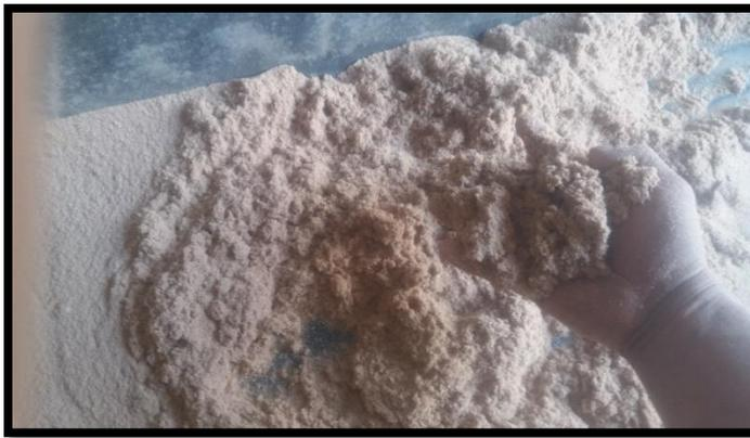
*Figura 37.* Aserrín fino (desechos de maderas de encofrado)
