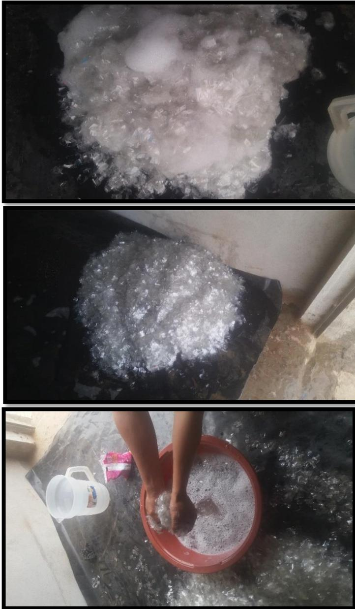
**Figura 47.** Lavado y secado del plástico PET 1
