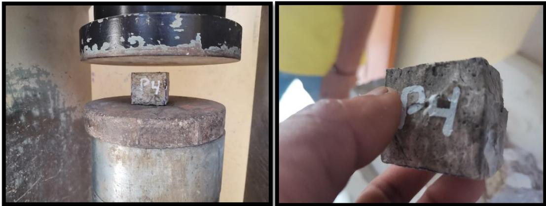
**Figura 63.** Visualización de rotura a los 28 días, Probeta 4
