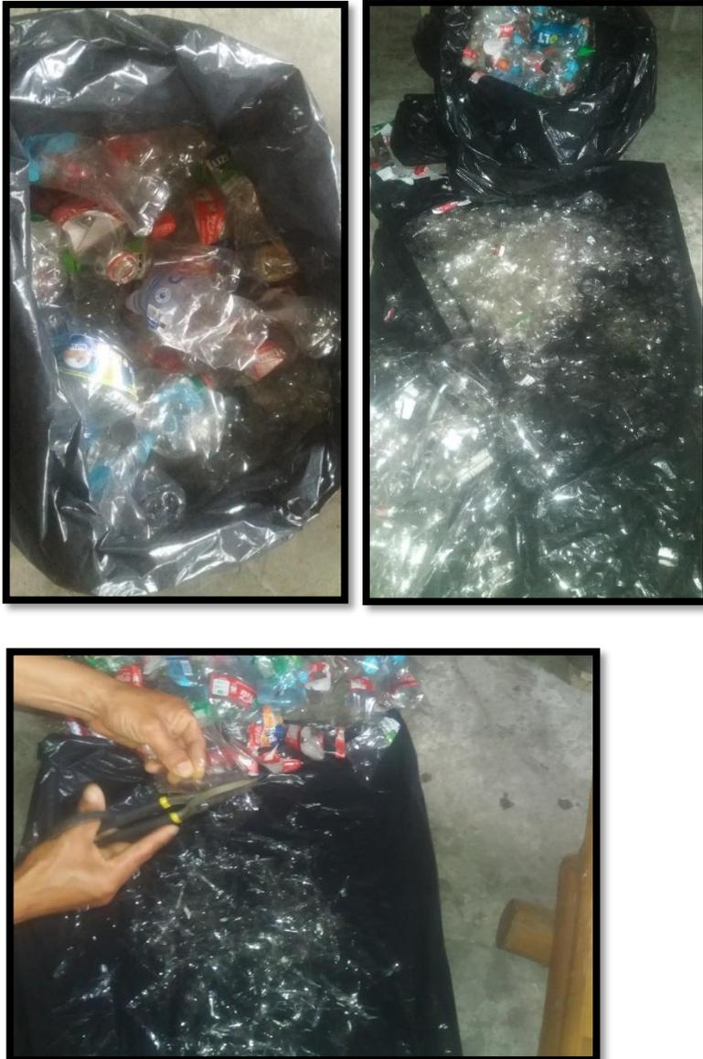
*Figura 46.* Obtención del Plástico Pet1
