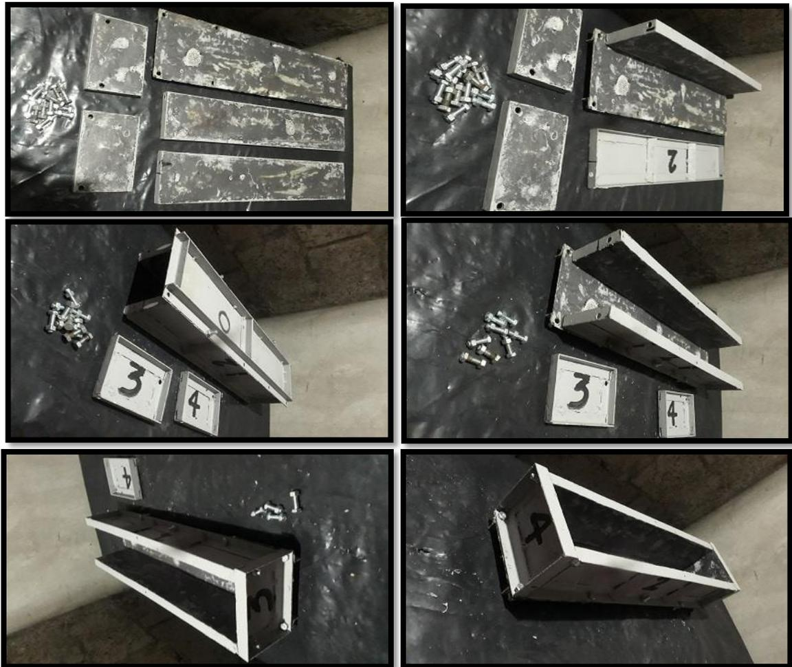
*Figura 35.* Molde metálico, 0.10 x 0.10 x 0.55 m.
