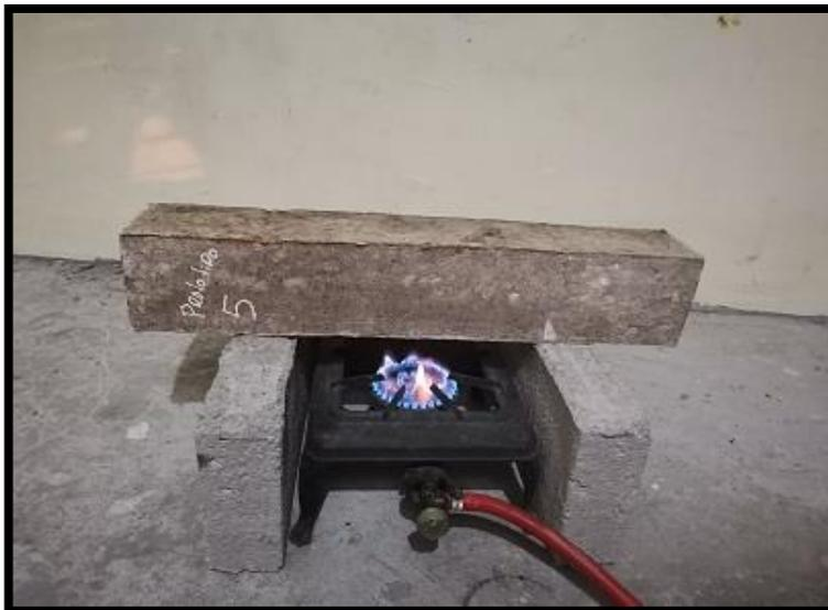
*Figura 77.* Prototipo sometido al fuego
