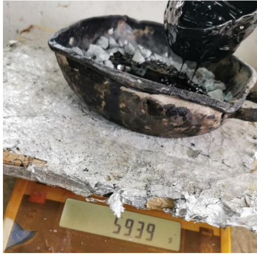
Figura 24 – Determinación de peso de los agregados de la briqueta. Elaborado por: Tapia (2021)
