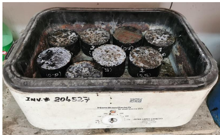
Figura 31 – Especímenes en baño maría. Elaborado por: Tapia (2021)
