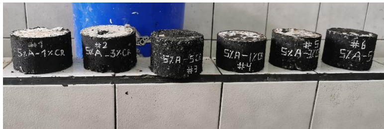
Figura 45 – Especímenes con la adición de CR al 1, 3, 5 %. Elaborado por: Tapia (2021)
