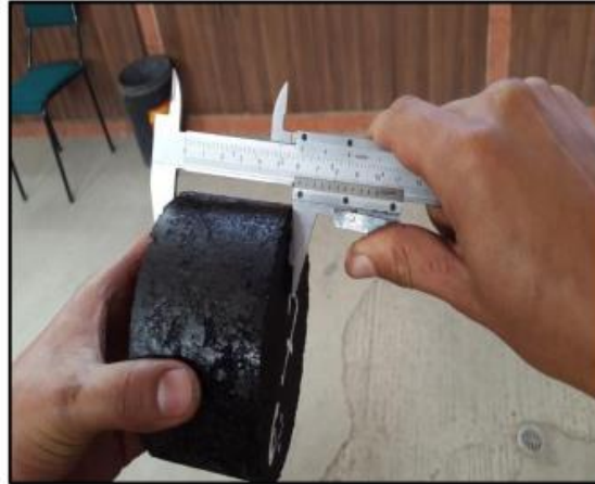
Figura 28 – Dimensionamiento de la briquetas. Elaborado por: Tapia (2021)
