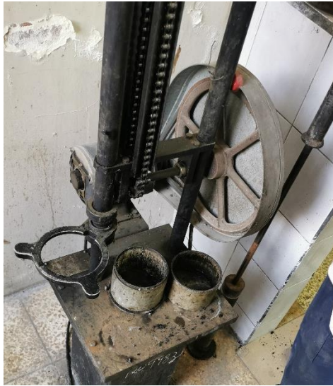
Figura 26 – Elaboración de briquetas de ensayo. Elaborado por: Tapia (2021)
