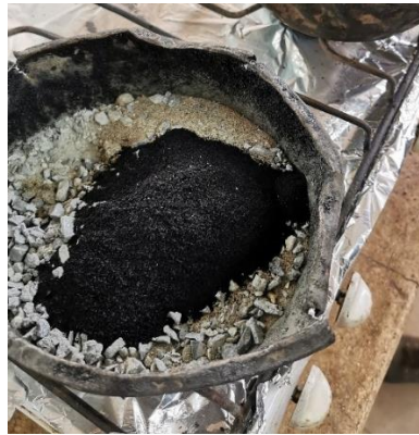
Figura 41 –Adición de polvo de caucho. Elaborado por: Tapia (2021)
