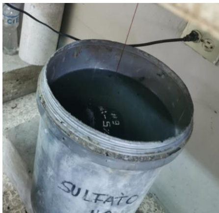
Figura 29 – Pesos al aire, sumergidos. Elaborado por: Tapia (2021)
