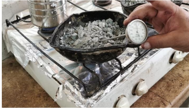
Figura 40 – Determinación de temperatura de los agregados. Elaborado por: Tapia (2021)
