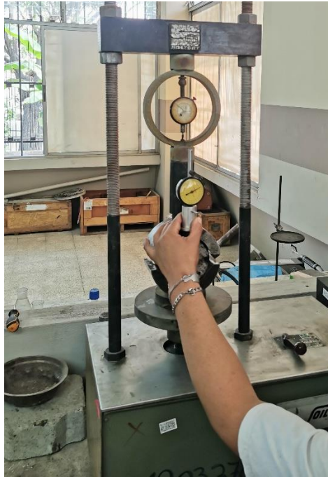
Figura 32 – Ensayo Marshall de Estabilidad y Flujo. Elaborado por: Tapia (2021)
