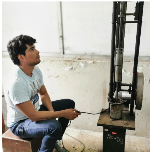
Figura 44 – Elaboración de las briquetas. Elaborado por: Tapia (2021)
