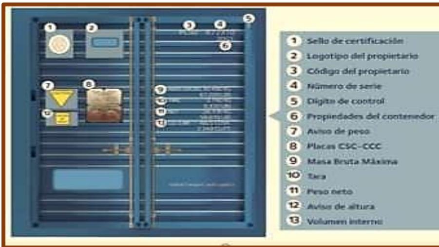
Figura 31. Sistema de Identificación en el contenedor. Extraído de: (DSV, 2019)
