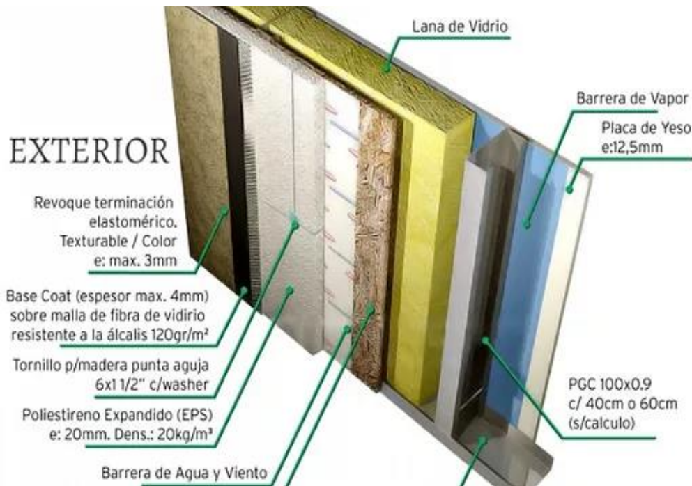
Figura 28. Materiales que Componen el Steel Framing Fuente: (Arkiproject, s.f.)
