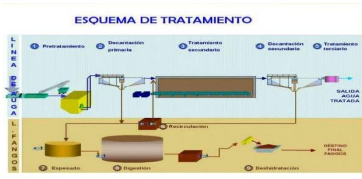
**Figura 8. Esquema de tratamiento de aguas residuales**
