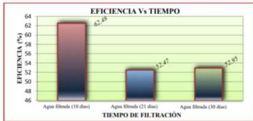
**Figura 3. Eficiencia del filtro vs tiempo.**
