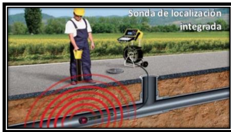
Figura 36. Inspección con CCTV con sistema de empuje manual. Elaborado por: Villafuerte, L. (2022)
