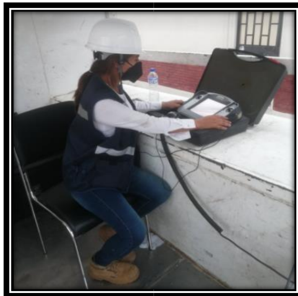
Figura 52. Diagnóstico del sistema de AA.LL. haciendo uso del Robot Rovver x. Elaborado por: Villafuerte, L. (2022)
