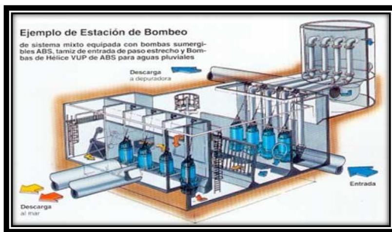
Figura 21. Estación de bombeo Elaborado por: Villafuerte, L. (2022)
