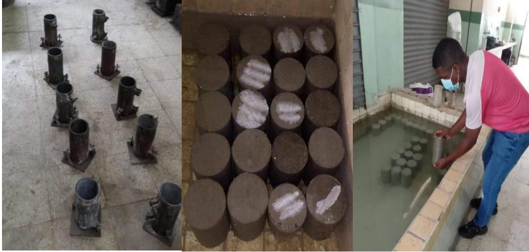
Figura 7 Procesos y curado de cilindro de hormigón Elaborado por: Jhayya (2022).
