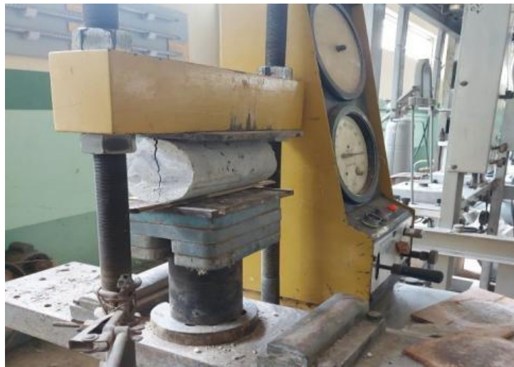
Figura 57. Ensayo brasileño Fuente: (Moya , Guaman, & Pinenla, 2019).
