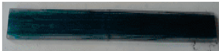
Figura 4. Fabricación del composite reforzado con fibra de cabuya Fuente: (Rocha, Pucha, Peralta, & Llanes, 2019).
