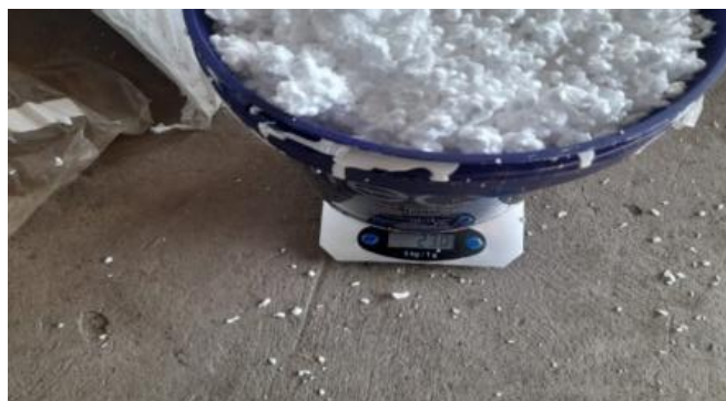
Figura 72. Peso y cubicación de recipiente para medidas de dosificación de bloques Elaborado por: Malla, H y Choez, M (2022).
