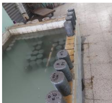
Figura 56. Curado de cilindros de hormigón Fuente: (Moya , Guaman, & Pinenla, 2019).
