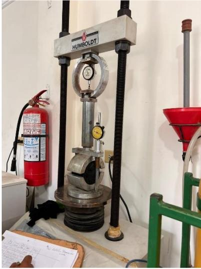
**Foto 9:** Ensayo de Marshall.
