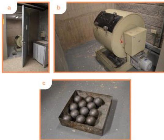
**Figura 10:** Ensayo de abrasión
