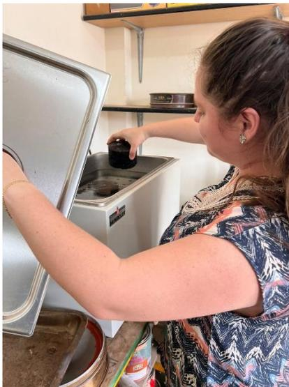
**Foto 8:** Colocación de las briquetas al baño de maría
