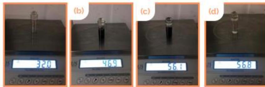
**Figura 6:** Ensayo densidad relativa
