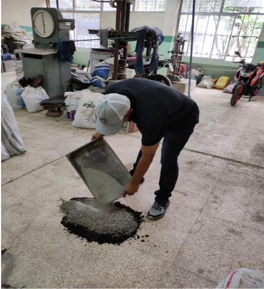
*Figura 27: Agregado de piedra, arena y cemento.*
