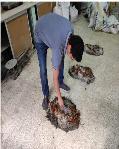
*Figura 28: Agregado de materiales propuestos Fibra de coco, fibra sorbete plástico, ceniza cascara de maní.*
