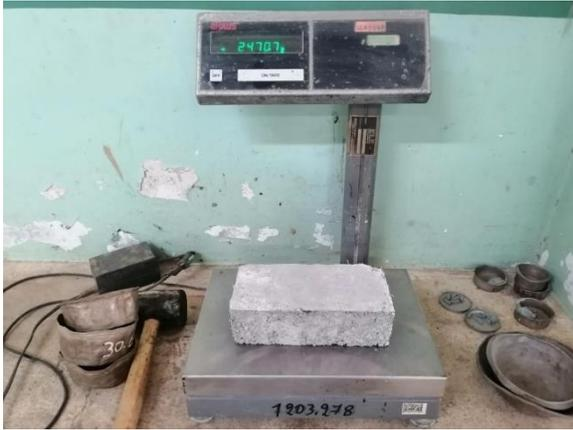
Figura 37: Foto 38.- Peso de adoquín al 15% (24707)
