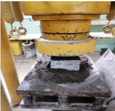
Figura 39: Rotura de adoquín al 10%
