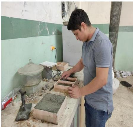
*Figura 33: Fundición de adoquines.*
