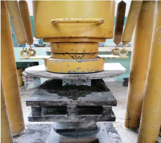
*Figura 43: Rotura de adoquín al 20%.*
