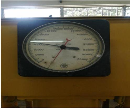
*Figura 40: Resultado de rotura de adoquín al 10%.*
