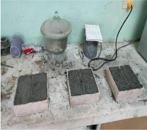
*Figura 34: Muestras de adoquín ya fundidas*
