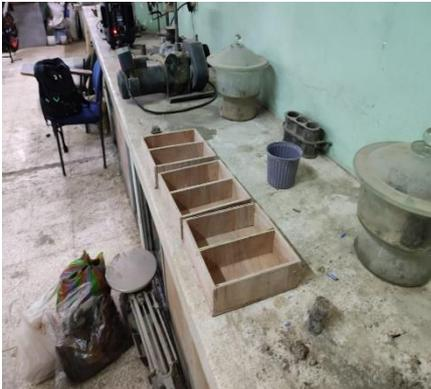
*Figura 32: Encofrado de madera para adoquines*
