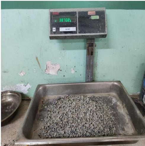
*Figura 9: Foto 8.- Piedra para la mezcla de hormigón.*
