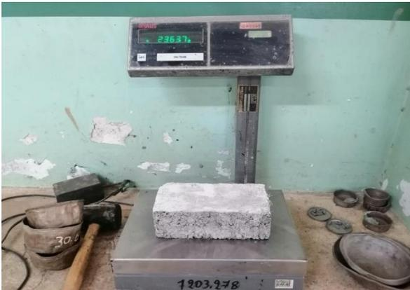
Figura 38: Peso de adoquín al 20% (23637)
