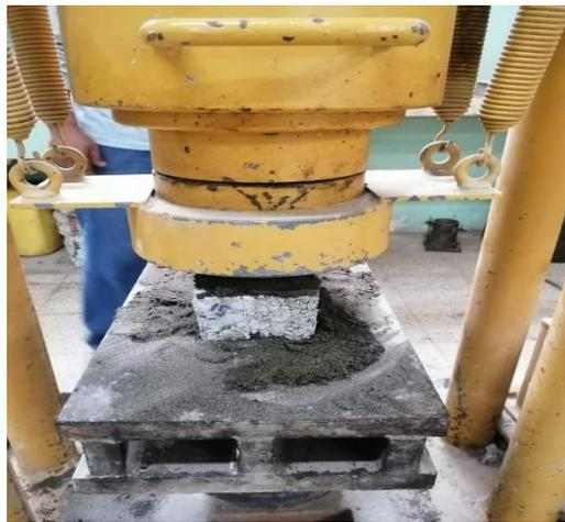
*Figura 41: .- Rotura de adoquín al 15%.*
