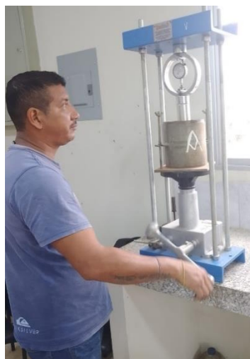
Foto 12: Ensayo CBR Elaborado por: Mendoza y Ponce (2022).
