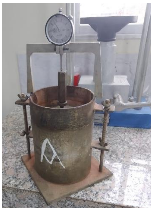
Foto 11: Ensayo CBR toma lectura expansión Elaborado por: Mendoza y Ponce (2022).
