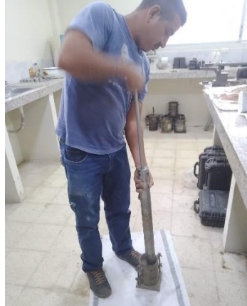
Foto 10: Ensayo de proctor Elaborado por: Mendoza y Ponce (2022).
