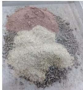
Foto 9: Mezcla para el ensayo de proctor Elaborado por: Mendoza y Ponce (2022)
