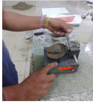
Foto 8: Límite líquido a la mezcla con arcilla cáscara de arroz y cerámica triturada Elaborado por: Mendoza y Ponce (2022)
