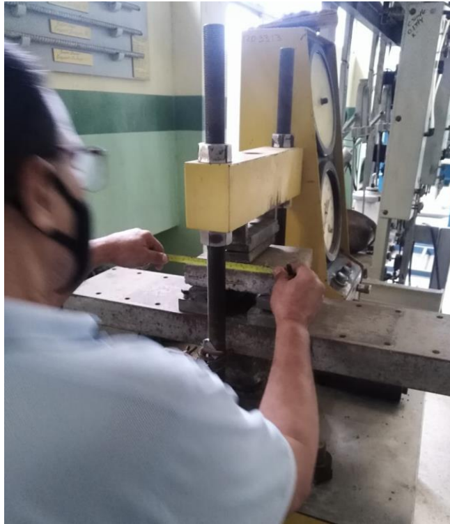
Figura 51 Preparación del prototipo prueba a Flexión PTYH04 Elaborado por: Contreras & Montalván (2022)
