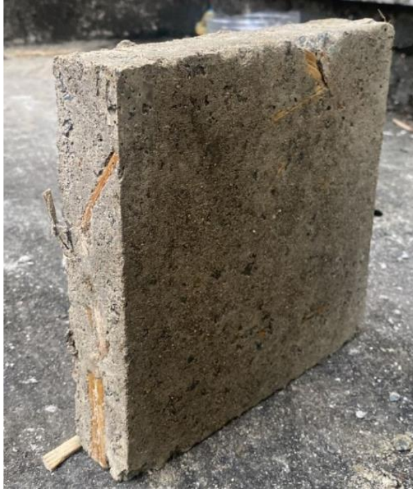
Figura 36 Desencofrado del prototipo PTYH 03 Elaborado por: Contreras & Montalván (2022)
