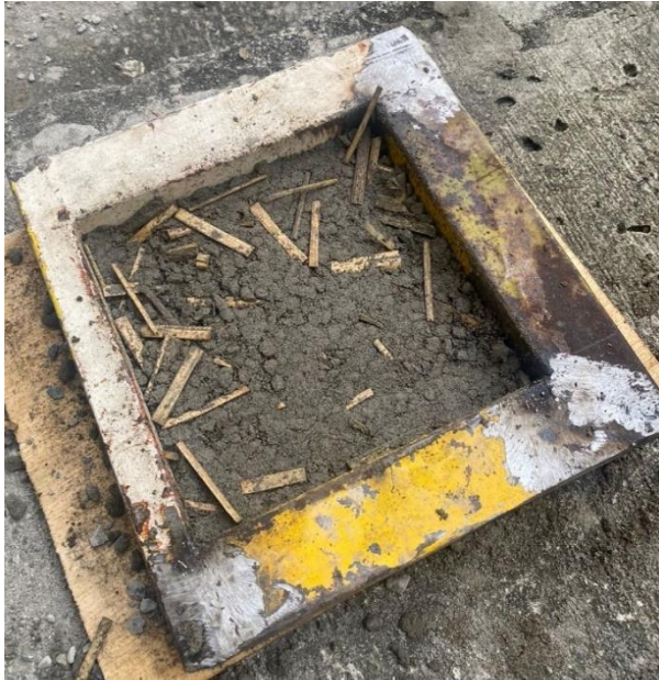
Figura 31 Encofrado del prototipo PTYH 02 Elaborado por: Contreras & Montalván (2022)
