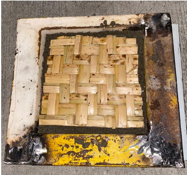
Figura 28 Encofrado del hormigón y totora tejida prototipo PTYH 01 Elaborado por: Contreras & Montalván (2022)
