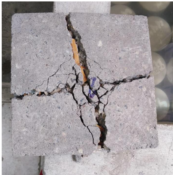
Figura 45 Resultado de la prueba a compresión del prototipo PTYH 02 Elaborado por: Contreras & Montalván (2022)
