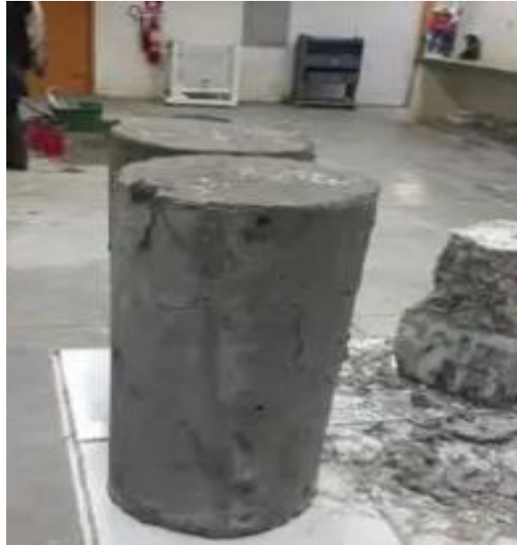
Figura 11 Concreto Reforzado con Fibra de Penca Fuente: (Cotez & Tasilla, 2017).
