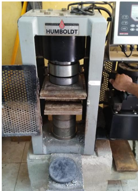
Figura 46 Prueba a compresión del prototipo PTYH 03 Elaborado por: Contreras & Montalván (2022)
