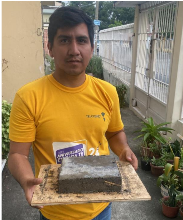
Figura 40 Desencofrado del prototipo PTYH 04 Elaborado por: Contreras & Montalván (2022)
