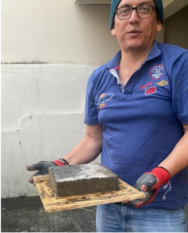
Figura 42 Desencofrado del prototipo PTYH 05 Elaborado por: Contreras & Montalván (2022)
