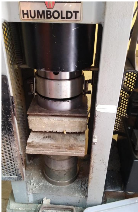
Figura 48 Prueba a compresión del prototipo PTYH 04 Elaborado por: Contreras & Montalván (2022)
