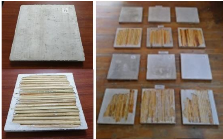
Figura 2 Ensayo probetas yeso-totora
