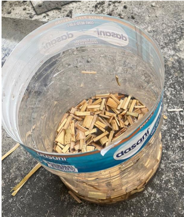
Figura 37 Hidratación de la totora en pedazos de 5cm prototipo PTYH 04 Elaborado por: Contreras & Montalván (2022)
