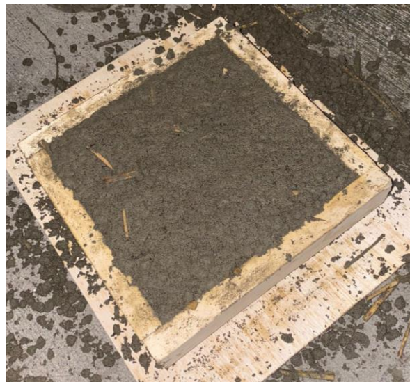
Figura 29 Encofrado del hormigón y totora tejida prototipo PTYH 01 Elaborado por: Contreras & Montalván (2022)
