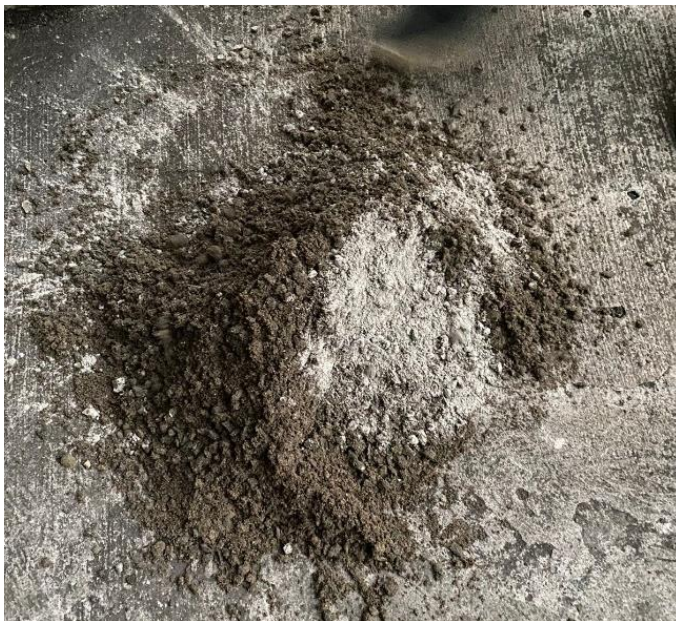
Figura 27 Mezcla arena piedra#18 y cemento prototipo PTYH 01 Elaborado por: Contreras & Montalván (2022)
