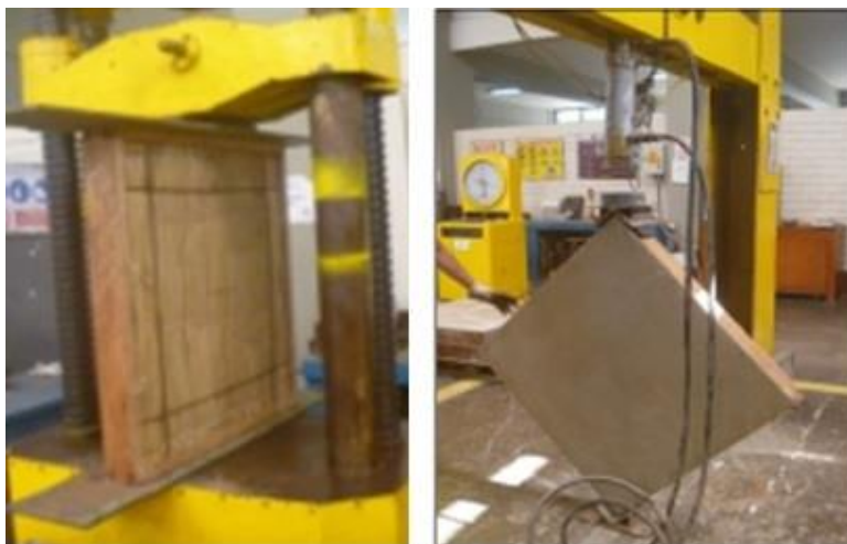
Figura 1 Panel Sometido a Compresión
