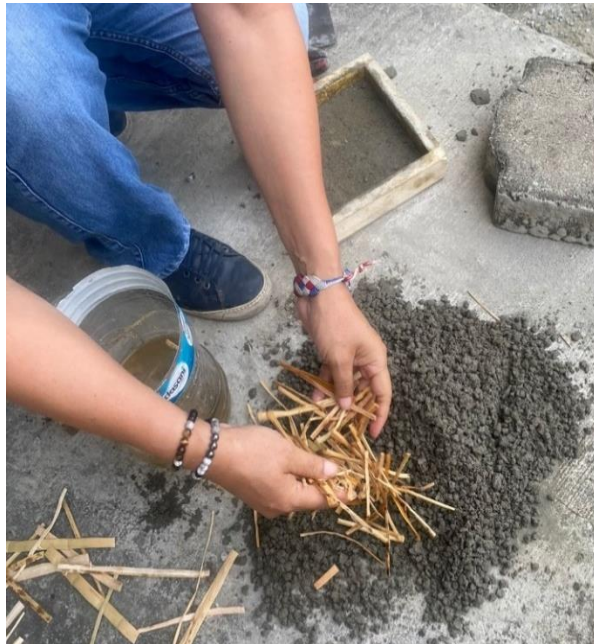
Figura 38 Totora hidratada a 5cm prototipo PTYH04 Elaborado por: Contreras & Montalván (2022)
