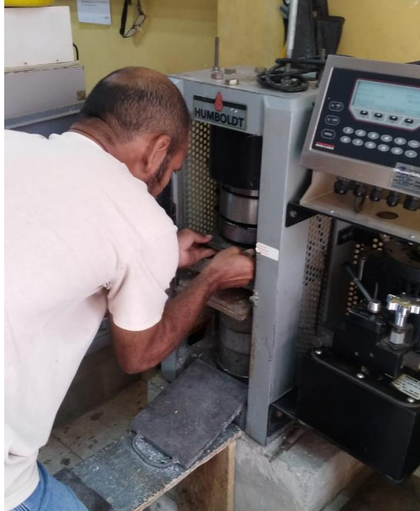
Figura 44 Prueba a compresión del prototipo PTYH 02 Elaborado por: Contreras & Montalván (2022)
