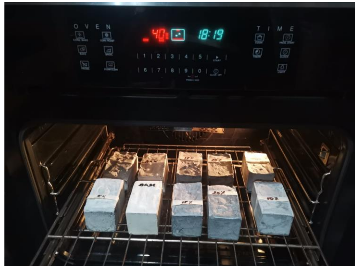
Figura 50. Muestras en horno para absorber la humedad Elaborado por: Izquierdo, K. y Sandoval, D. (2022)
