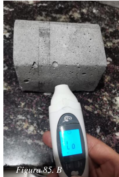
Figura 85. A-B Toma de temperatura a la muestra 20% grafito Elaborado por: Izquierdo, K. y Sandoval, D. (2022)
