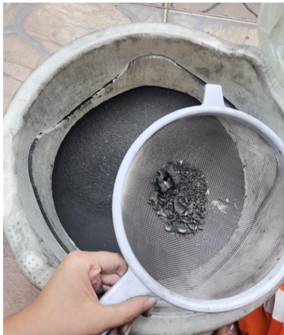
Figura 30. Primer tamizado de la piedra de grafito Elaborado por: Izquierdo, K. y Sandoval, D. (2022)
