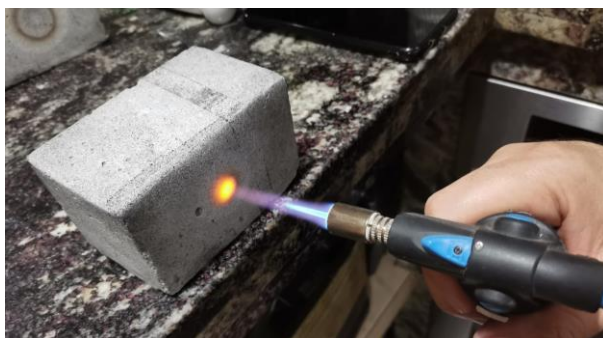
Figura 84. Prueba de resistencia al fuego muestras 20% grafito Elaborado por: Izquierdo, K. y Sandoval, D. (2022)
