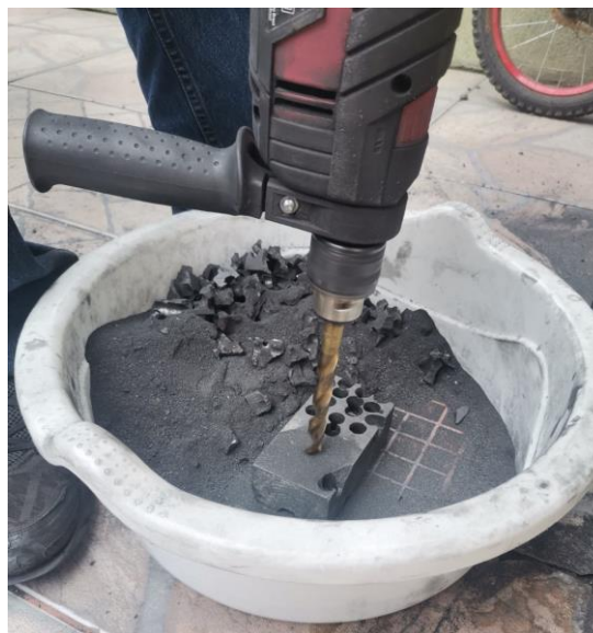
Figura 24. Proceso para triturar el molde exotérmico Elaborado por: Izquierdo, K. y Sandoval, D. (2022)
