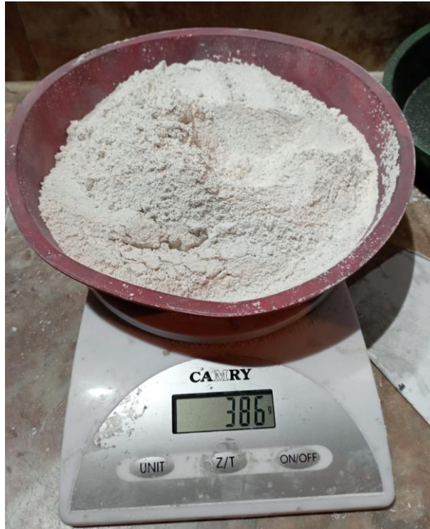
Figura 44. Pesaje del yeso para muestra con 15% de grafito Elaborado por: Izquierdo, K. y Sandoval, D. (2022)
