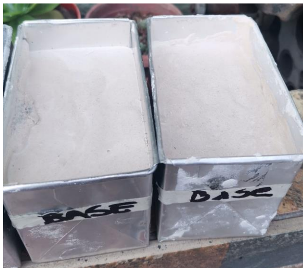
Figura 35. Muestras de yeso de referencia sin adiciones puestas en molde Elaborado por: Izquierdo, K. y Sandoval, D. (2022)
