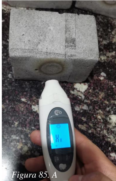
Figura 85. A-B Toma de temperatura a la muestra 20% grafito Elaborado por: Izquierdo, K. y Sandoval, D. (2022)
