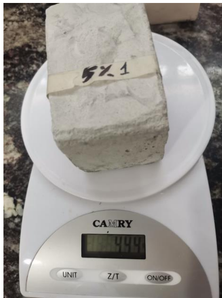
Figura 52. Muestra de yeso con 5% de grafito elegida para prueba física Elaborado por: Izquierdo, K. y Sandoval, D. (2022)
