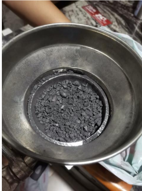
Figura 27. Segundo triturado de la piedra del grafito Elaborado por: Izquierdo, K. y Sandoval, D. (2022)
