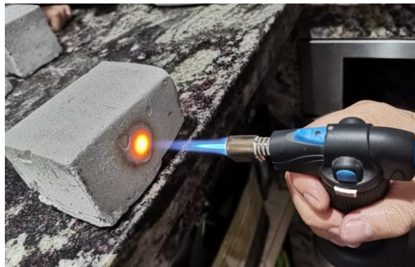
Figura 78. Prueba de resistencia al fuego muestras 5% de grafito Elaborado por: Izquierdo, K. y Sandoval, D. (2022)
