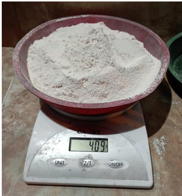
Figura 41. Pesaje del yeso para muestra con 10% de grafito Elaborado por: Izquierdo, K. y Sandoval, D. (2022)
