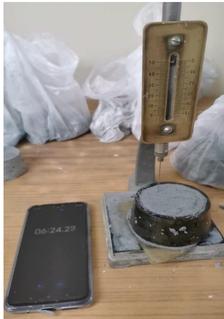
Figura 73. Determinación del tiempo de fraguado en muestra de 20% Elaborado por: Izquierdo, K. y Sandoval, D. (2022)
