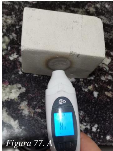
Figura 77. A-B toma de temperatura muestra YBASE Elaborado por: Izquierdo, K. y Sandoval, D. (2022)
