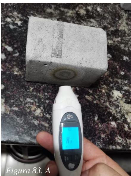
Figura 83. A-B Toma de temperatura a la muestra 15% grafito Elaborado por: Izquierdo, K. y Sandoval, D. (2022)
