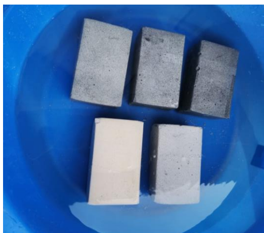
Figura 74. Prueba para determinar la absorción del agua Elaborado por: Izquierdo, K. y Sandoval, D. (2022)
