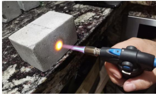
Figura 80. Prueba de resistencia al fuego muestras 10% de grafito Elaborado por: Izquierdo, K. y Sandoval, D. (2022)
