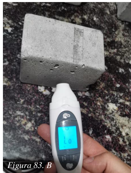
Figura 83. A-B Toma de temperatura a la muestra 15% grafito Elaborado por: Izquierdo, K. y Sandoval, D. (2022)
