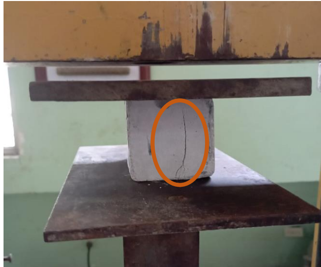
Figura 61. Rotura de la muestra con el 5% de grafito Elaborado por: Izquierdo, K. y Sandoval, D. (2022)
