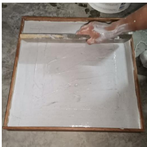
Figura 92. Nivelación de mezcla Elaborado por: Izquierdo, K. y Sandoval, D. (2022)
