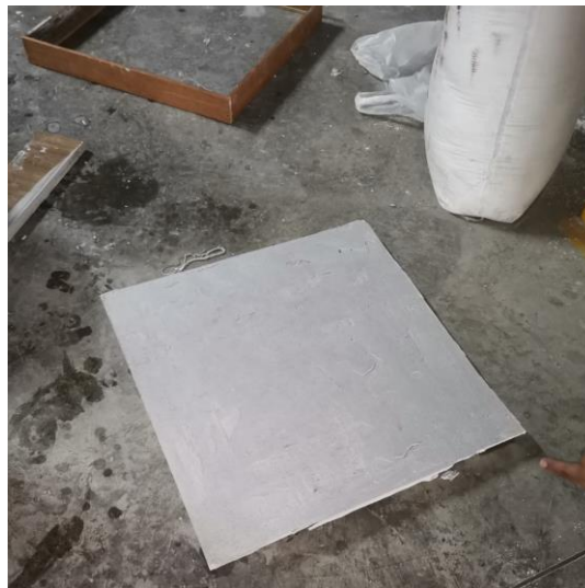
Figura 93. Desencofrado de la placa Elaborado por: Izquierdo, K. y Sandoval, D. (2022)
