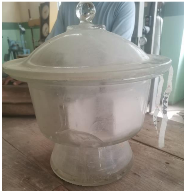
Figura 56. Muestras colocadas en desecador sobre perclorato de magnesio Elaborado por: Izquierdo, K. y Sandoval, D. (2022)
