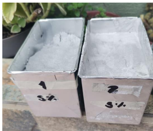
Figura 39. Muestras de yeso con el 5% de grafito Elaborado por: Izquierdo, K. y Sandoval, D. (2022)
