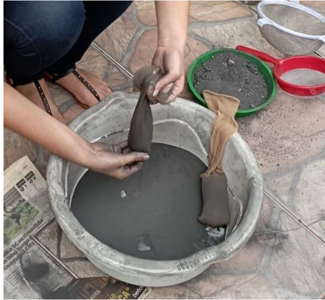
Figura 31. Segundo tamizado de la piedra de grafito Elaborado por: Izquierdo, K. y Sandoval, D. (2022)
