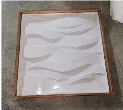
Figura 90. Molde de PVC y encofrado para colocación de la mezcla Elaborado por: Izquierdo, K. y Sandoval, D. (2022)
