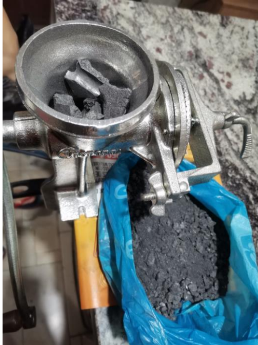
Figura 25. Primer triturado de la piedra del grafito Elaborado por: Izquierdo, K. y Sandoval, D. (2022)
