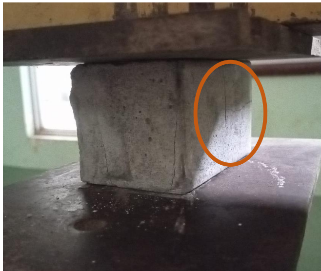
Figura 64. Rotura de la muestra con el 20% de grafito Elaborado por: Izquierdo, K. y Sandoval, D. (2022)
