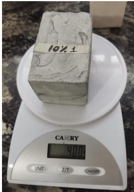
Figura 53. Muestra de yeso con 10% de grafito elegida para prueba física Elaborado por: Izquierdo, K. y Sandoval, D. (2022)
