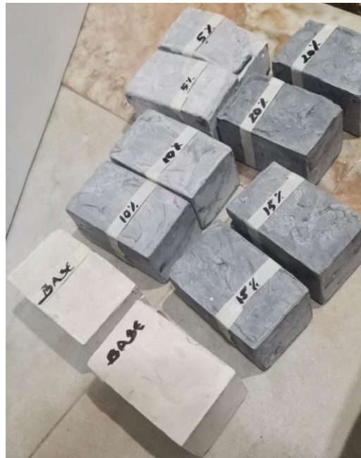
Figura 49. Muestras desmoldadas al cumplir 24h Elaborado por: Izquierdo, K. y Sandoval, D. (2022)
