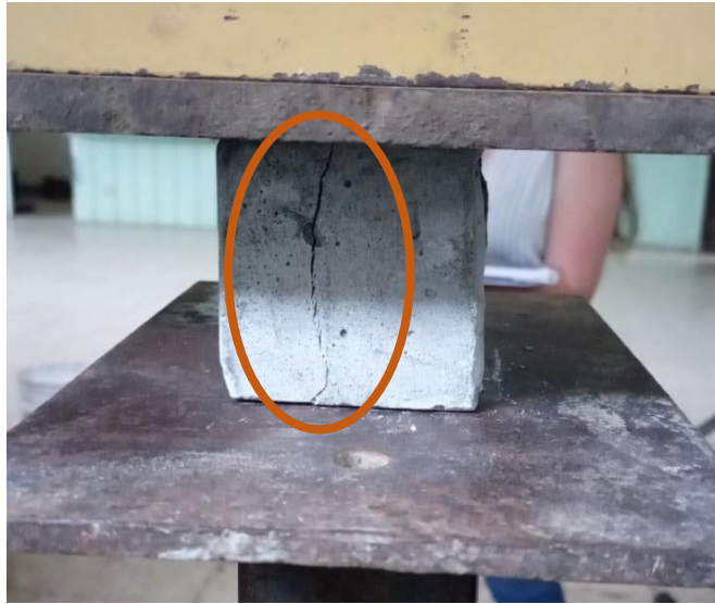
Figura 63. Rotura de la muestra con el 15% de grafito Elaborado por: Izquierdo, K. y Sandoval, D. (2022)
