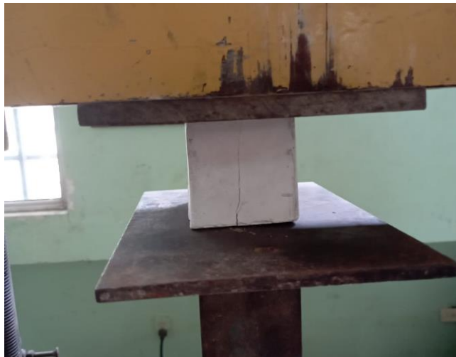
Figura 60. Rotura de la muestra yeso de referencia sin adiciones Elaborado por: Izquierdo, K. y Sandoval, D. (2022)
