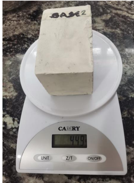
Figura 51. Muestra de yeso de referencia sin adiciones elegida para prueba física Elaborado por: Izquierdo, K. y Sandoval, D. (2022)
