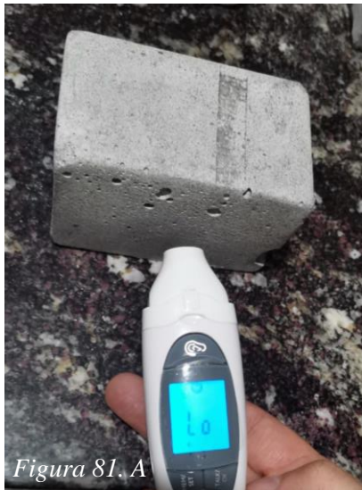
Figura 81. A-B Toma de temperatura a la muestra 10% grafito Elaborado por: Izquierdo, K. y Sandoval, D. (2022)
