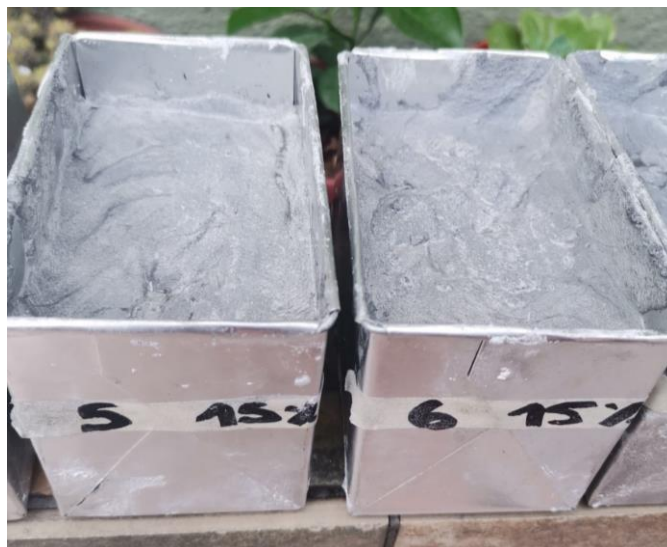
Figura 45. Muestras de yeso con el 15% de grafito Elaborado por: Izquierdo, K. y Sandoval, D. (2022)
