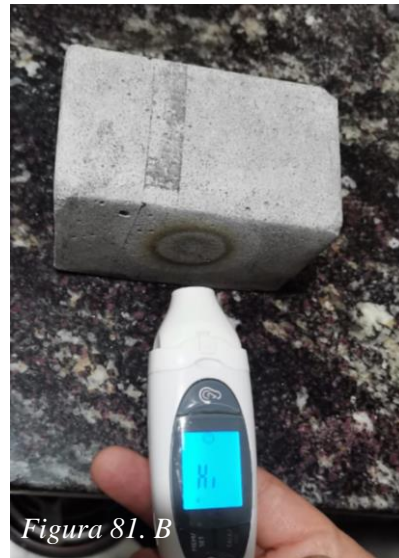
Figura 81. A-B Toma de temperatura a la muestra 10% grafito Elaborado por: Izquierdo, K. y Sandoval, D. (2022)
