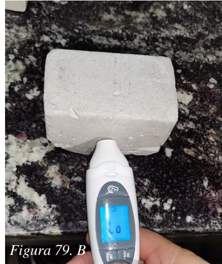
Figura 79. A-B Toma de temperatura a la muestra 5% grafito Elaborado por: Izquierdo, K. y Sandoval, D. (2022)
