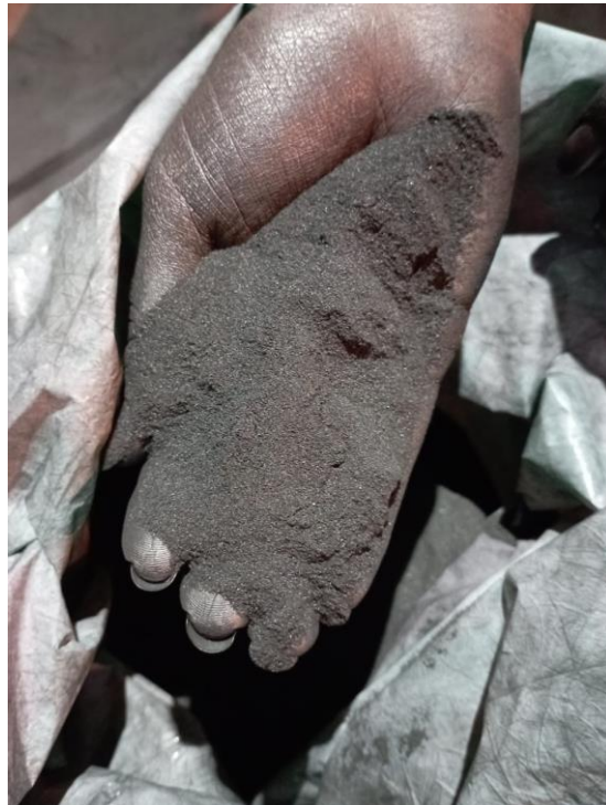
Figura 32. Resultado del segundo tamizado de la piedra de grafito Elaborado por: Izquierdo, K. y Sandoval, D. (2022)
