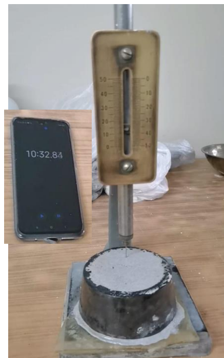
Figura 70. Determinación del tiempo de fraguado en muestra de 5% Elaborado por: Izquierdo, K. y Sandoval, D. (2022)
