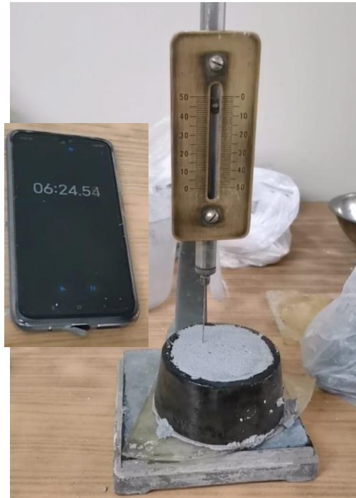
Figura 71. Determinación del tiempo de fraguado en muestra de 10% Elaborado por: Izquierdo, K. y Sandoval, D. (2022)
