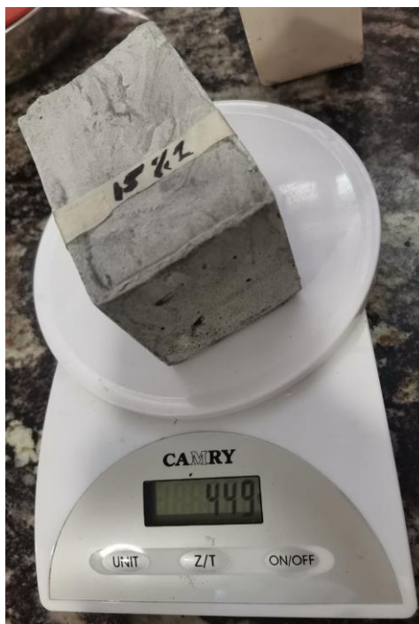
Figura 54. Muestra de yeso con 15% de grafito elegida para prueba física Elaborado por: Izquierdo, K. y Sandoval, D. (2022)
