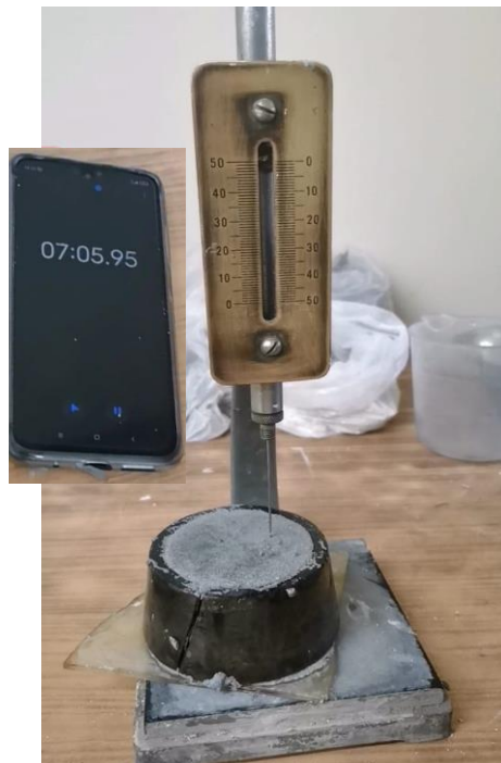
Figura 72. Determinación del tiempo de fraguado en muestra de 20% Elaborado por: Izquierdo, K. y Sandoval, D. (2022)
