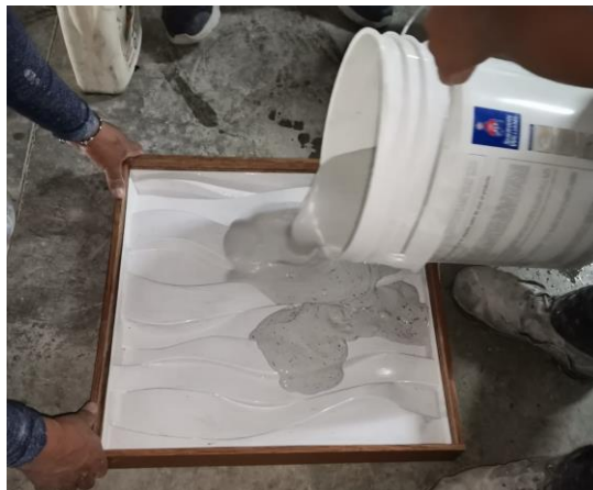
Figura 91. Colocación de la mezcla al molde Elaborado por: Izquierdo, K. y Sandoval, D. (2022)
