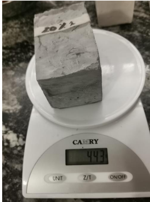
Figura 55. Muestra de yeso con 20% de grafito elegida para prueba física Elaborado por: Izquierdo, K. y Sandoval, D. (2022)
