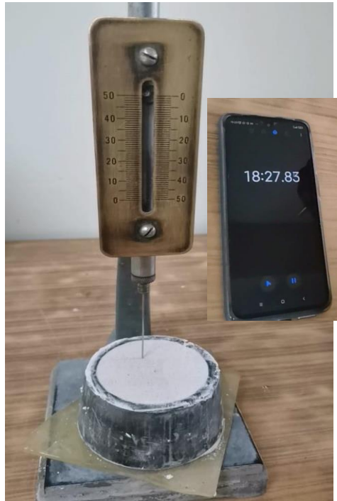
Figura 69. Determinación del tiempo de fraguado en muestra YBASE Elaborado por: Izquierdo, K. y Sandoval, D. (2022)
