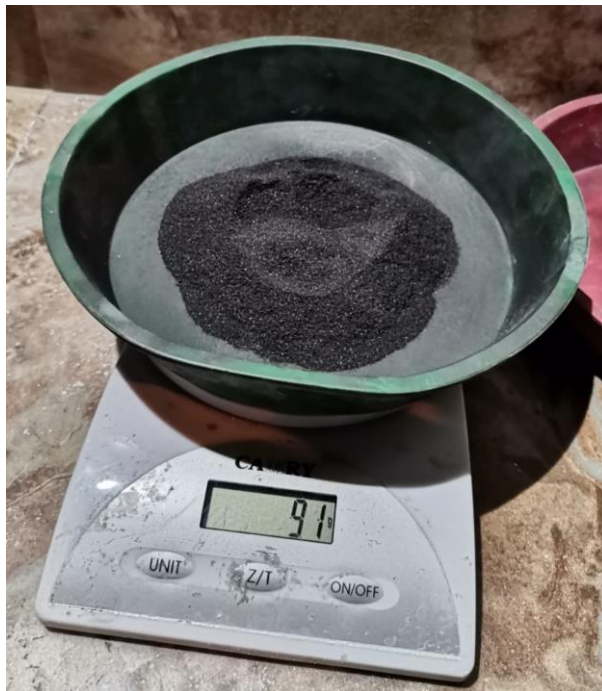
Figura 47. Pesaje del yeso para muestra con 20% de grafito Elaborado por: Izquierdo, K. y Sandoval, D. (2022)
