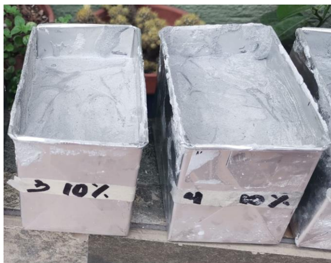
Figura 42. Muestras de yeso con el 10% de grafito Elaborado por: Izquierdo, K. y Sandoval, D. (2022)
