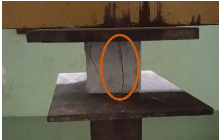
Figura 62. Rotura de la muestra con el 10% de grafito Elaborado por: Izquierdo, K. y Sandoval, D. (2022)
