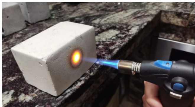
Figura 76. Prueba de resistencia al fuego muestras YBASE Elaborado por: Izquierdo, K. y Sandoval, D. (2022)
