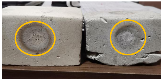
Figura 86. Fractura por calor muestra YBASE vs Y95- G5 Elaborado por: Izquierdo, K. y Sandoval, D. (2022)
