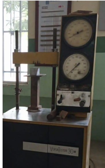
Figura 57. Prensa Hidráulica para Pruebas de Compresión Elaborado por: Izquierdo, K. y Sandoval, D. (2022)
