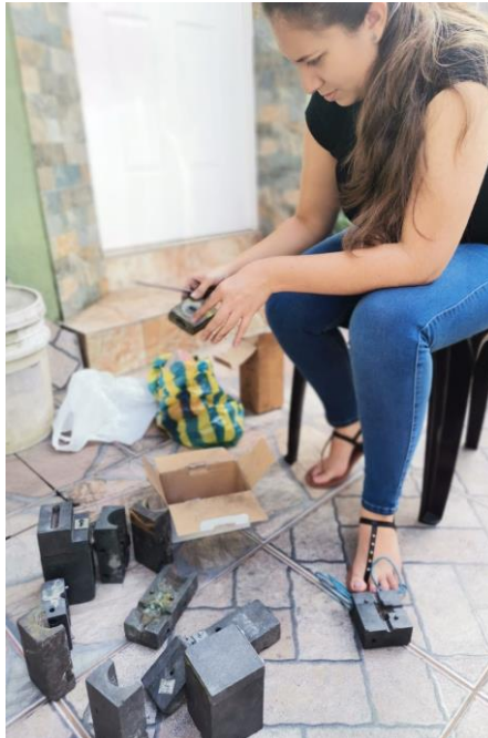
Figura 23. Limpieza de los moldes exotérmicos Elaborado por: Izquierdo, K. y Sandoval, D. (2022)
