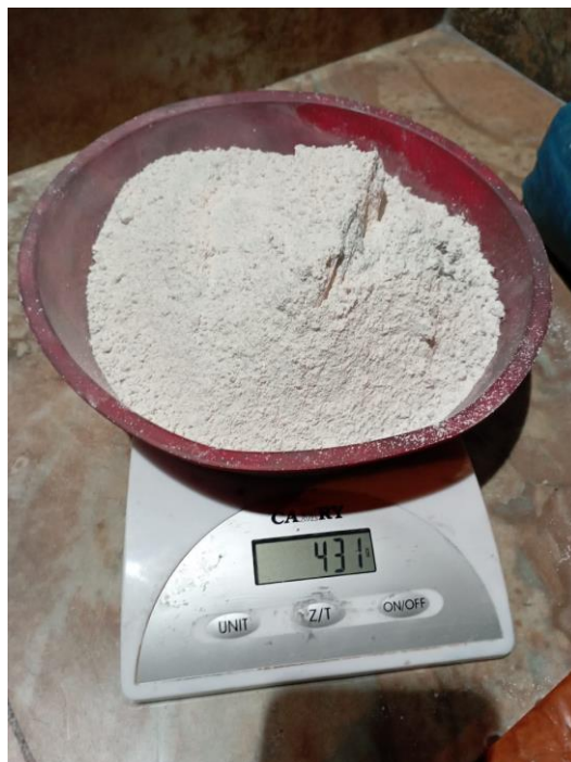
Figura 37. Pesaje del yeso para muestra con 5% de grafito Elaborado por: Izquierdo, K. y Sandoval, D. (2022)
