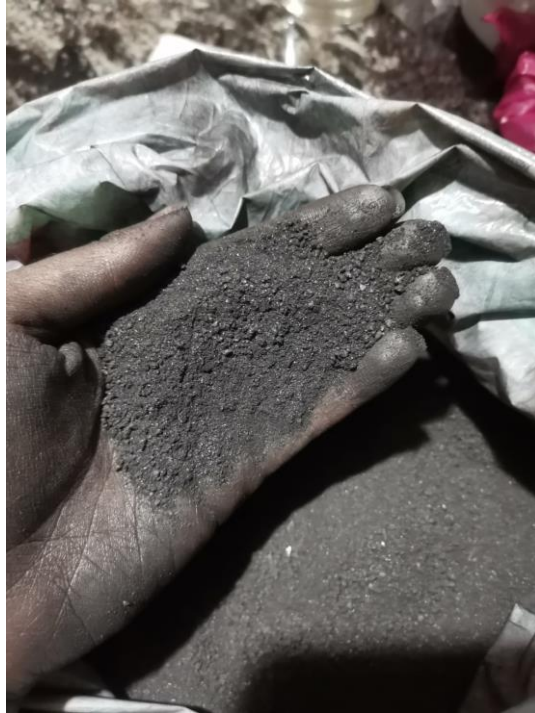
Figura 29. Resultado del tercer triturado de la piedra del grafito Elaborado por: Izquierdo, K. y Sandoval, D. (2022)
