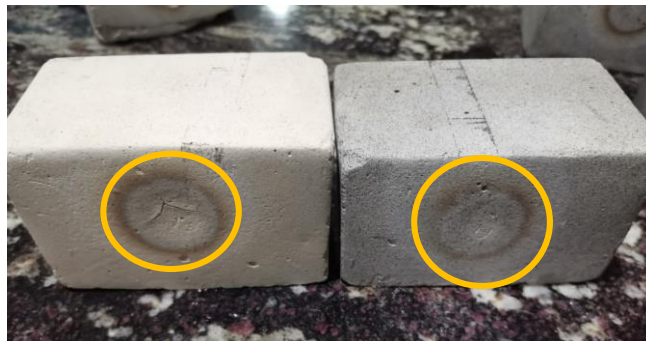
Figura 87. Fractura por calor muestra YBASE vs Y90- G10 Elaborado por: Izquierdo, K. y Sandoval, D. (2022)
