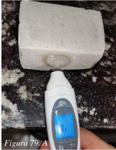
Figura 79. A-B Toma de temperatura a la muestra 5% grafito Elaborado por: Izquierdo, K. y Sandoval, D. (2022)
