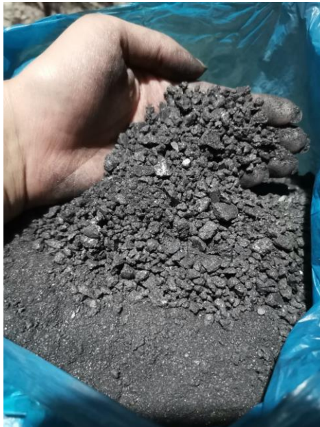
Figura 26. Resultados del primer triturado de la piedra del grafito Elaborado por: Izquierdo, K. y Sandoval, D. (2022)
